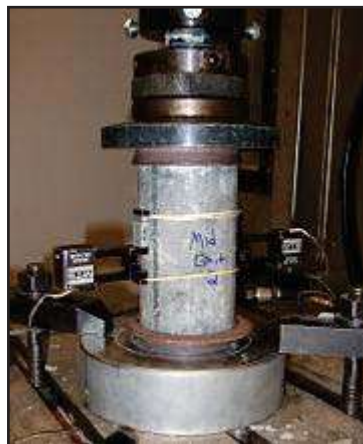
Figura 29. Ensayo de una muestra de concreto sometida a compresion
