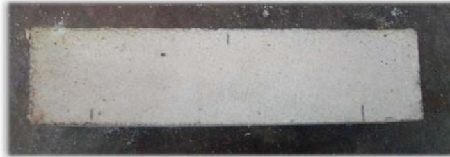
Figura 23. Espécimen de mortero para flexión.
