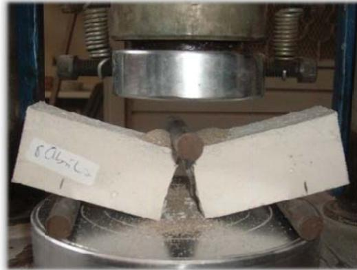
Figura 30. Fractura por flexión
