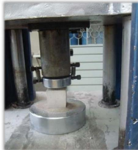
Figura 26. Prueba de compresión.
