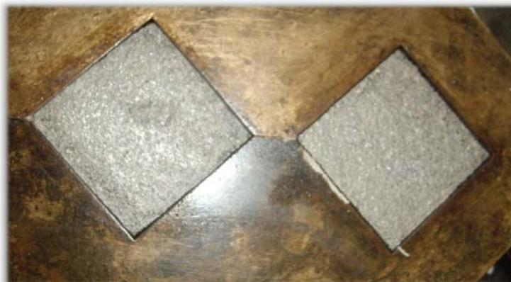
Figura 22. Especímenes de mortero para compresión.
