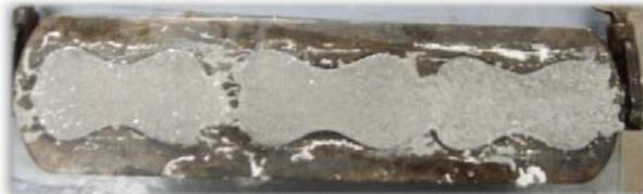
Figura 24. Espécimen de mortero para Tensión.
