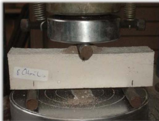
Figura 29. Colocación de los apoyos para flexión
