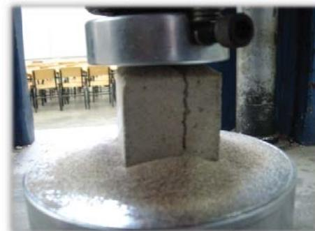
Figura 27. Falla de ruptura por compresión.
