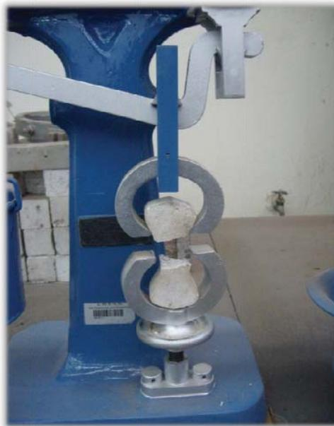
Figura 32. Falla de ruptura por Tensión.
