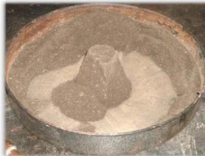
Figura 16. Prueba de humedad superficial de la arena.
