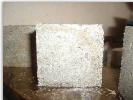
Figura 25. Espécimen de mortero para prueba de compresión.
