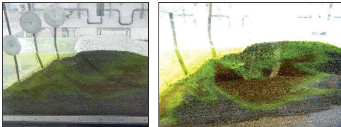
Fotografía No 3.11 y fotografía No 3.12. En la primera fotografía se muestra una red de tubos por el cual se aplica fluoresceína sal sódica que trabaja como colorante. En la fotografía de la derecha se puede observar la red de flujo que nos muestra la trayectoria de la infiltración del agua sobre una cortina de presa hecha a escala.
