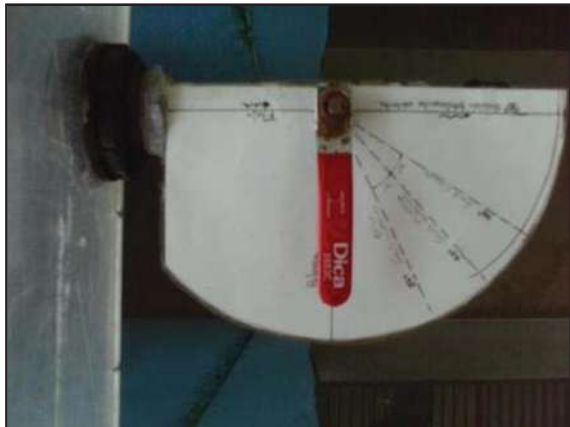
Fotografías No a2.7. y No a2.8. Graduación del tanque inferior y válvula de esfera graduada para dar los diferentes gastos.
