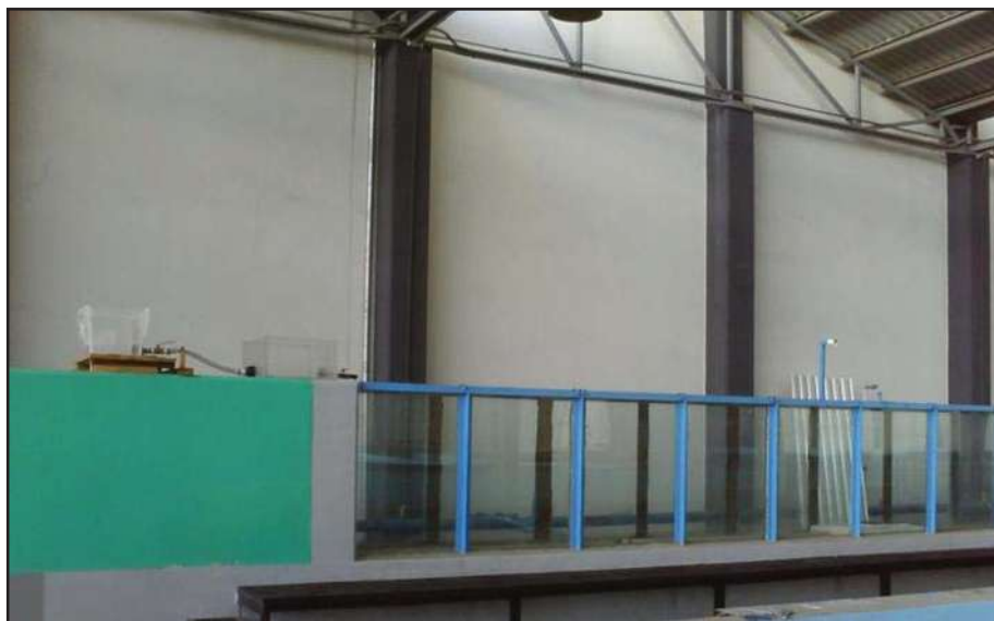
Fotografía No 4.1. Fotografía del canal largo en la cual se puede apreciar la instalación experimental así como las ventanas de visualización. Para tener una mejor comprensión de la instalación ver el Anexo No 2.
