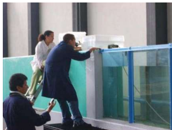
Fotografía a5.8. Medición volumétrica del gasto en el tanque elevado y control de la carga hidráulica.
