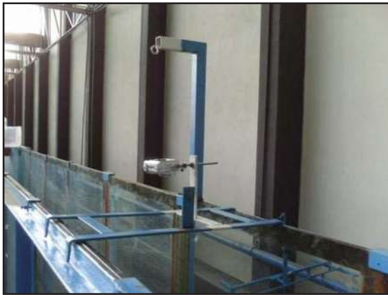
Fotografía No. a2.6 Apoyo donde se colocó la cámara digital y el brazo donde se colocó el equipo de venoclisis.
