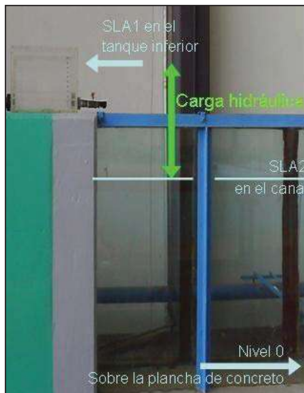
Fotografía No 4.2. Carga hidráulica entre la SLA_1 en el depósito y la SLA_2 del Canal Largo.
