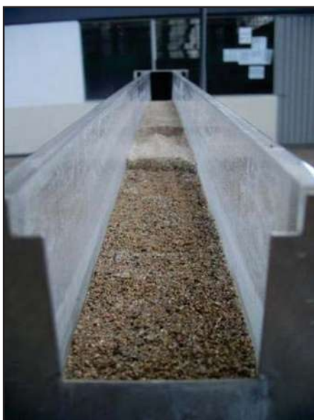
Fotografía No 3.7. En la fotografía aparece un canal de pendiente variable en el que se estudia el arrastre de sedimentos, por lo tanto se le denomina de fondo móvil.
