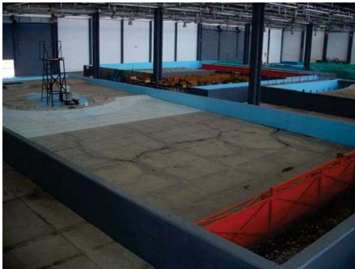
Fotografía No 3.6. Modelo hidráulico del Puerto de Veracruz con fondo fijo, localizado dentro de las instalaciones del laboratorio de hidráulica de la UMSNH.
