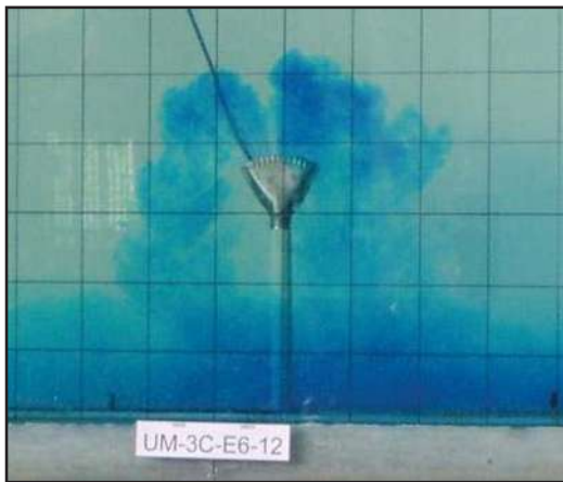
Par de fotografías No a4.6. Descarga del Difusor "peine" ó "abanico"
