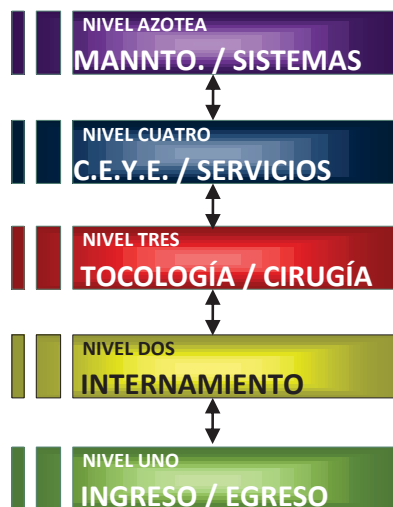
Figura 5.02. Clasificación y jerarquización de áreas según medidas de asepsia, prioridad de atención a pacientes y relación modular. Diagrama de Circulación Vertical basado en la NOM-197-SSA1-2007, y normas a fines.
