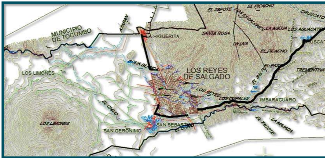
Fig.1.8 Curvas de nivel de una superficie generada por la malla irregular de triángulos (vectores). Cerro Santa Rosa y Los Limones en el municipio de Los Reyes de Salgado Michoacán
