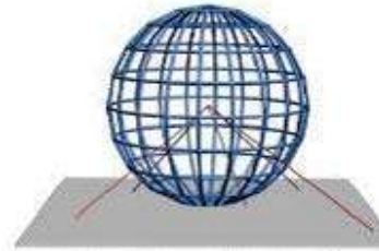
Fig. 2.16 Proyección Acimutal (C, 2009)
