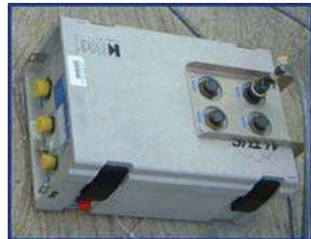
Sensores uniaxiales colocados sobre una placa de aluminio
