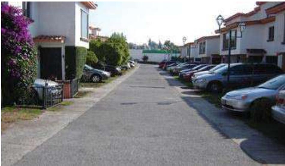
Fotografía No. 11 Pavimento de fraccionamiento hecho a base de ecocreto.
