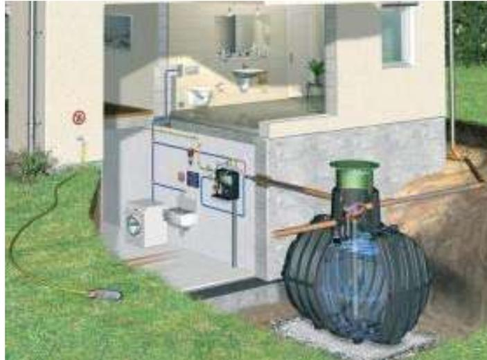
Fotografía No. 36 Captador de agua de lluvia, de una vivienda.
