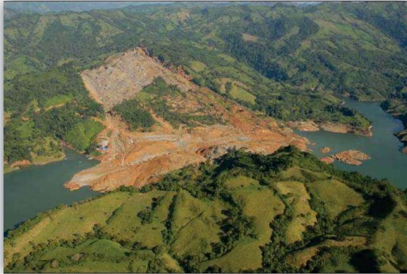
Figura 34. Vista del deslizamiento que obstruyó el río Grijalva. Fuente: Arvizu, 2009.
