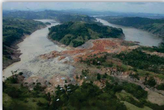
Figura 7. Deslizamiento San Juan Grijalva, Chiapas 200, ocurrido el 4 de noviembre del 2007. En la imagen se observa como el río Grijalva, segundo río más caudaloso de México, es obstruido por el dique formado por el deslizamiento de cerca de 50 millones de m 3 . Tomada de www.jornada.unam.mx/2007/11/29/index.php?sect...
