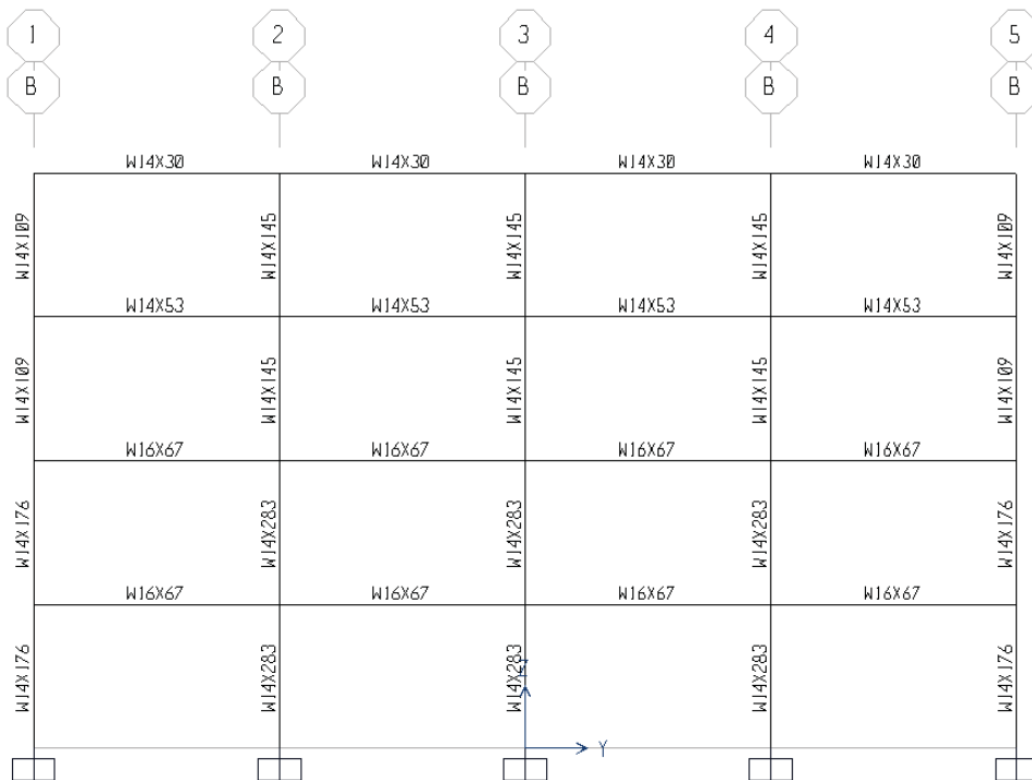
a) Perfiles de acero en los marcos externos: Ejes A y E
