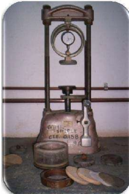
Figura 3.6.- Marco de Compresión Simple para el ensayo de Presión de Expansión.
