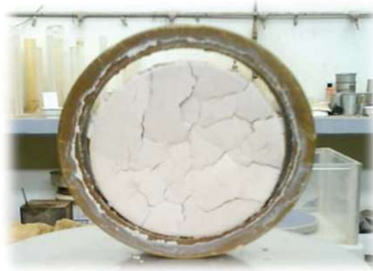
Figura 1.5.- Viceversa a la figura anterior se muestra como es espécimen se contrae debido a la ausencia de agua.
