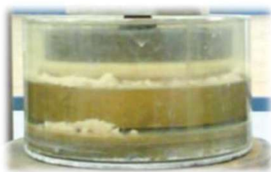
Figura 1.4.- En esta prueba de Presión de Expansión en Bentonita se muestra como se desborda la muestra debido a la expansión volumétrica.
