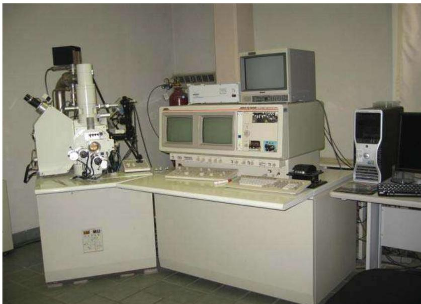
Fig. 02. Microscopio Electrónico de Barrido. Ortiz, et al. 2009, curso: introducción a la microscopía. UMSNH.
