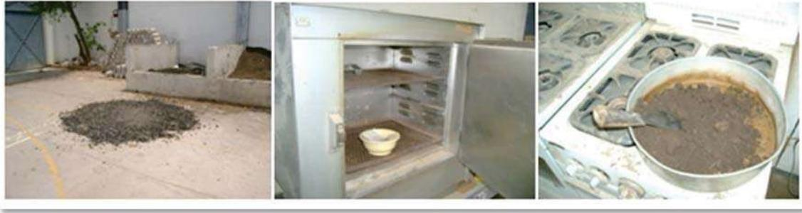
Figura 103.- Secado de muestras alteradas (al sol, en horno y en estufa)
