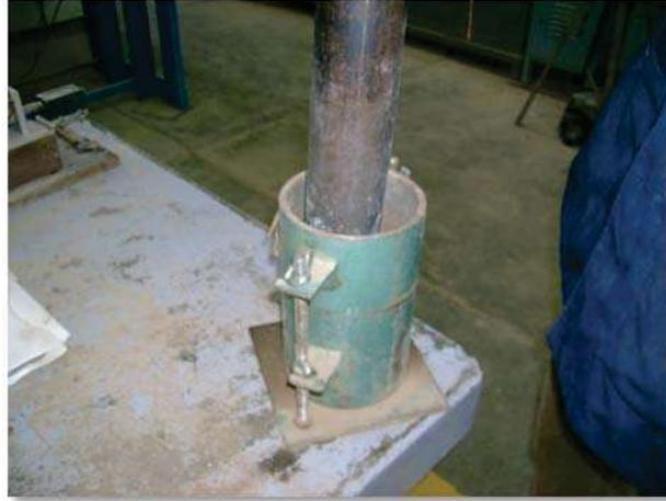
Figura 112.- Equipo de compactación Proctor
