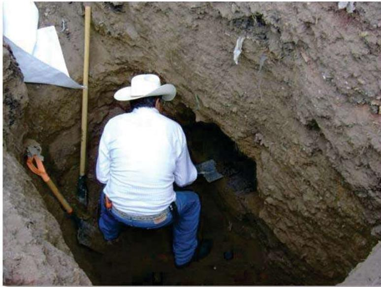
Figura 45.- Excavación para muestra inalterada, Puente Peatonal
