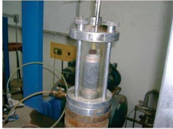
Figura 59.- Cámara de Compresión Triaxial
