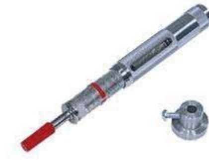
Figura 33.- Penetrómetro de bolsillo para medir en campo la resistencia a la compresión de los suelos.
