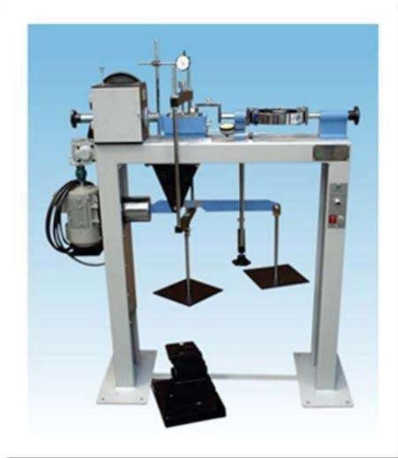
Figura 8.- Equipo de corte directo (cortesía de Pinzuar)
