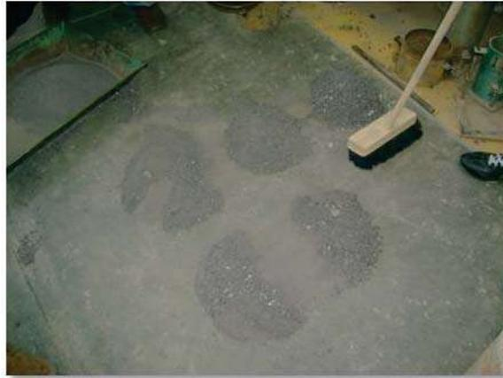
Figura 105.- Cuarteo de muestras alteradas
