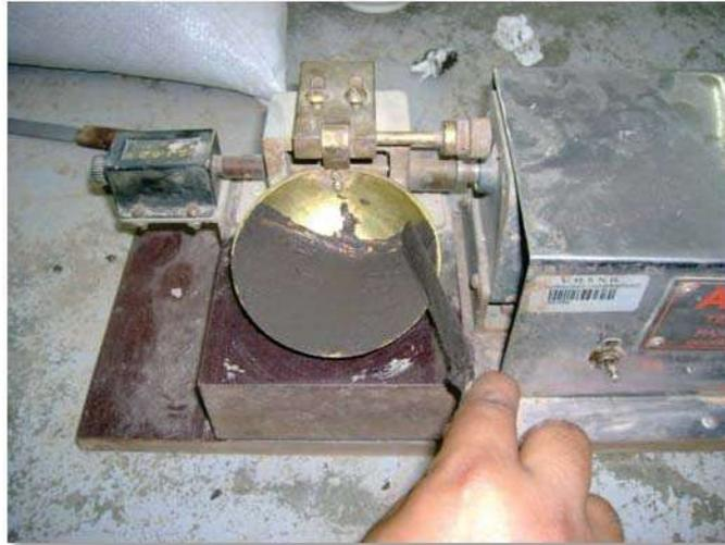
Figura 120.- Determinación de límites de consistencia.
