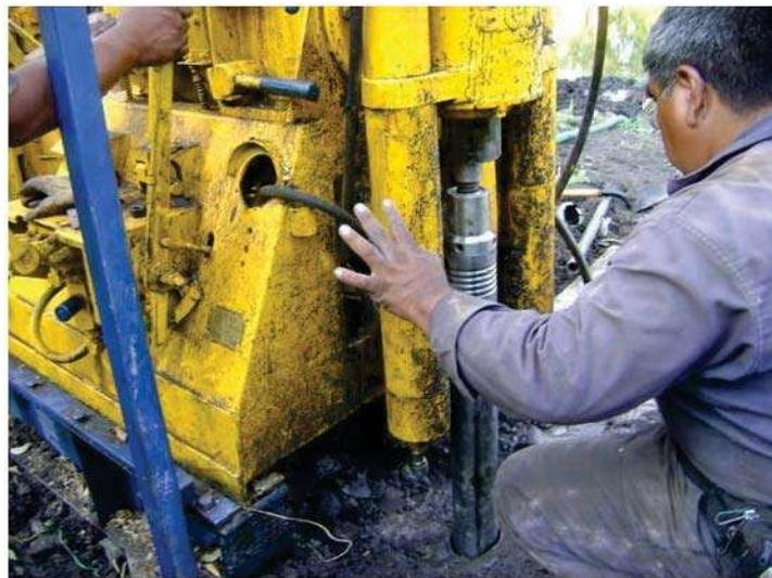
Figura 41.- Extracción de muestra con Tubo Shelby
