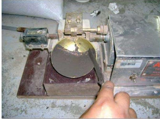
Figura 108.- Copa de Casagrande y prueba de Límite Líquido
