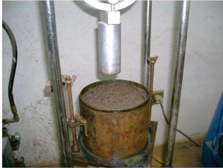
Figura 114.- Prueba del Valor Relativo de Soporte
