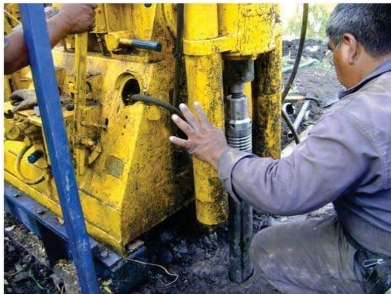
Figura 138.- Obtención de muestra inalterada mediante Tubo Shelby
