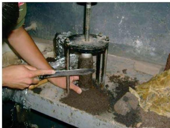
Figura 58.- Labrado de muestra inalterada para prueba Triaxial
