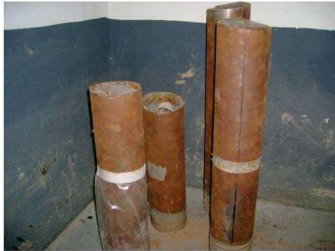
Figura 57.- Muestras inalteradas para consolidación, extraídas de pruebas de sondeos mixtos en La Piedad, Michoacán.
