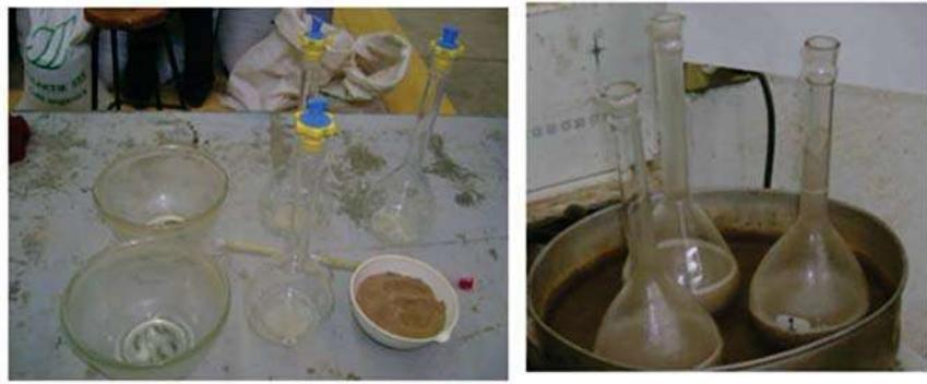
Figura 53.-Equipo y ebullición de muestra para densidad de sólidos ( $S_s$ )
