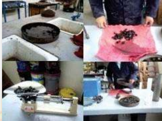
Figura No. 20. Humedad de absorción en grava.
