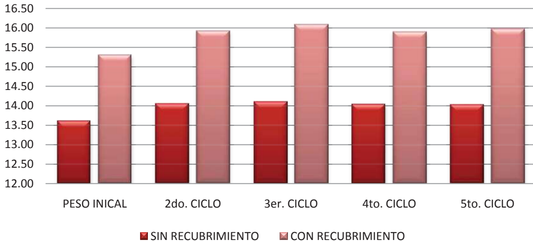
Figura No. 35. Grafica de pesos húmedos y secos después de 5 ciclos de ataque de Sulfato de Sodio.
