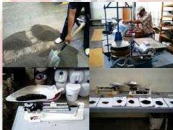
Figura No. 18. Granulometría en arena.
