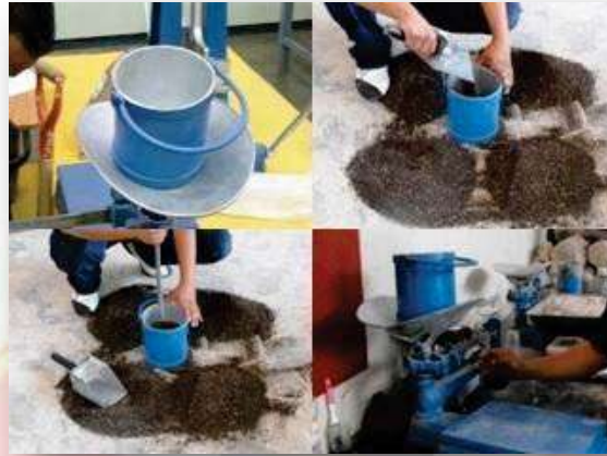
Figura No. 17. P.V.S.V. en arena.
