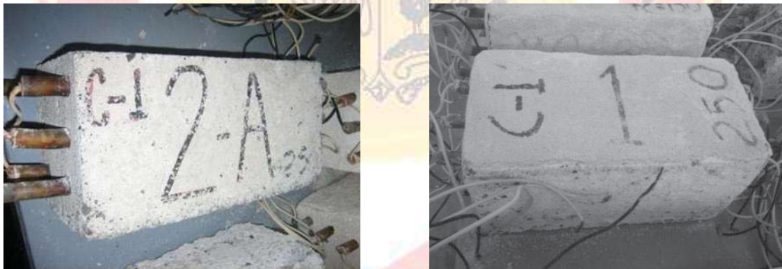
Figura No. 32. Estado de las vigas después del tercer ciclo de ataque.
