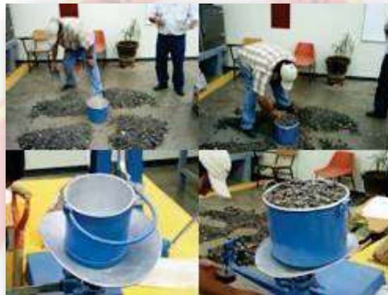
Figura No. 23. P.V.S.V. en grava.
