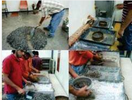
Figura No. 24. Granulometría en gravas.
