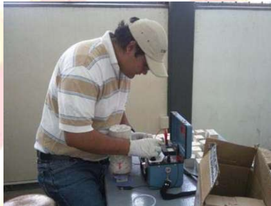
Figura No. 40. Medición de la resistividad eléctrica en los cilindros de concreto.
