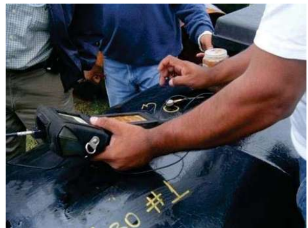
FOTOGRAFÍA No. 102. Prueba de espesor de recubrimiento.
