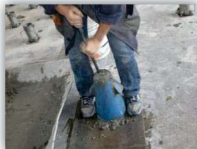
Figura 4.47. Se mantiene el nivel del concreto por encima del borde del molde en la tercera capa
