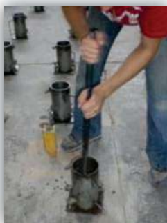
Figura 4.53. Varillado del concreto en 3 capas.
