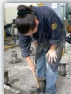
Figura 4.54. Golpeado de los cilindros para eliminar vacíos.
