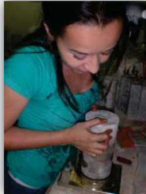
Figura 4.58. Procedimiento de cabeceo: vertido del azufre, colocación del cilindro y secado del azufre.
