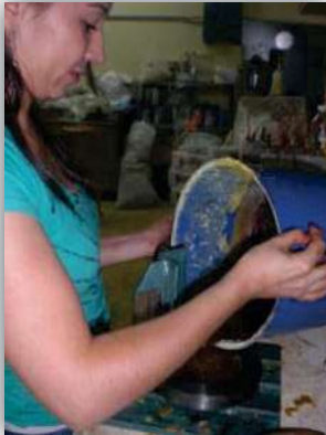
Figura 4.58. Procedimiento de cabeceo: vertido del azufre, colocación del cilindro y secado del azufre.
