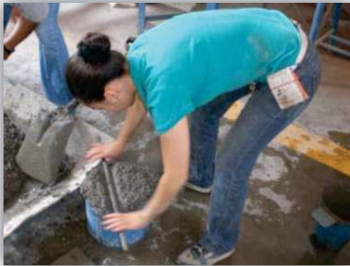
Figura 4.52. Enrasado del recipiente y recipiente listo para ser pesado y determinar su masa unitaria.
