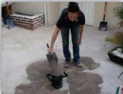
Figura 4.4. Vertido del agregado en el molde (Arena de río)
