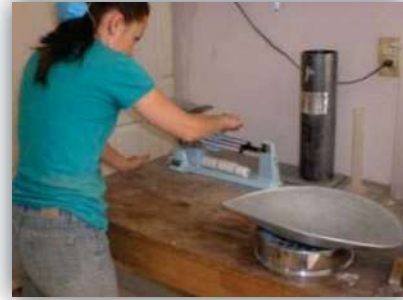
Figura 4.27. Determinación de la masa que se retiene en cada malla (Arena de río)
