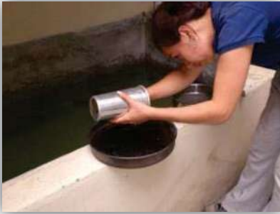
Figura 4.22. Se rompen los terrones de arcilla que existan en la muestra (Arena volcánica)
