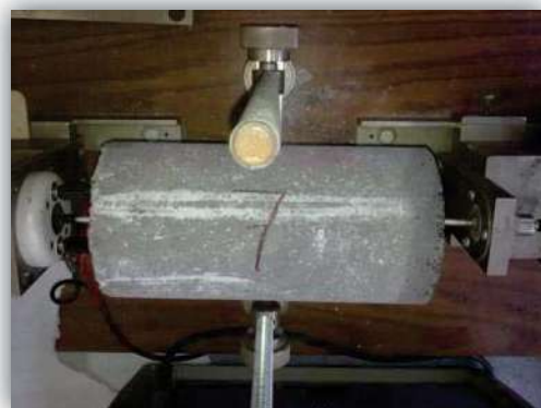
Figura 4.68. Centrado del espécimen a fin de que coincida el transmisor con el receptor.
