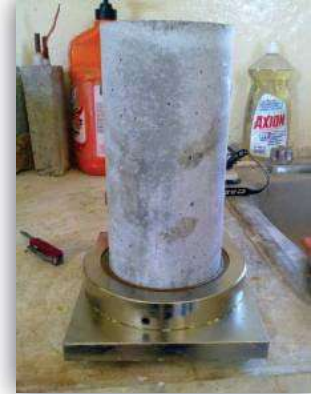
Figura 4.58. Procedimiento de cabeceo: vertido del azufre, colocación del cilindro y secado del azufre.
