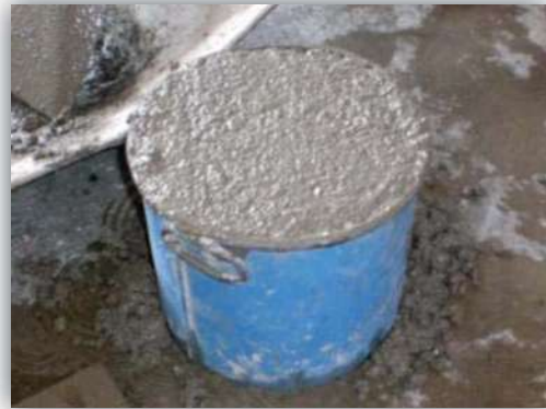
Figura 4.52. Enrasado del recipiente y recipiente listo para ser pesado y determinar su masa unitaria.
