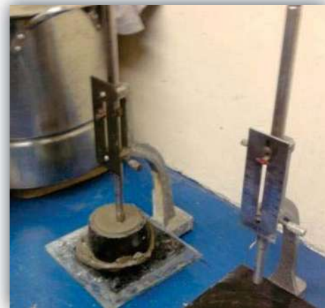
Figura 4.39. Lectura inicial después de los 30 segundos que se terminó de hacer la pasta
