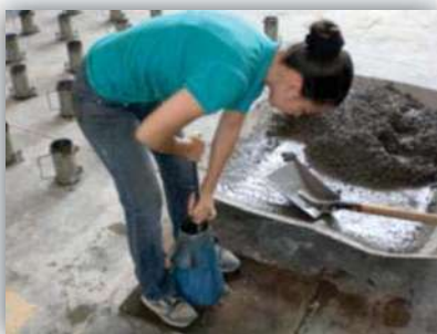
Figura 4.46. Llenado del molde en tres capas dando 25 golpes con la varilla a cada capa.
