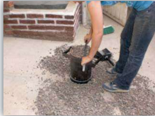
Figura 4.7. Al terminar el llenado, se enrasa el recipiente con la misma varilla utilizada (Grava de río)
