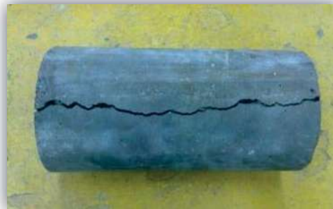
Figura 4.64. Cilindro fallado después de la aplicación de la carga.
