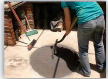
Cuarteo después de aplanar el cono (Arena Volcánica)
