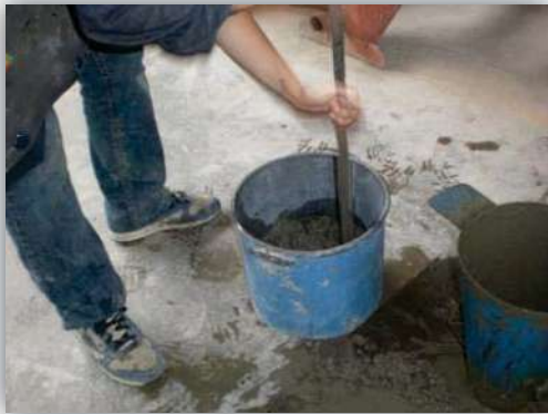
Figura 4.50. Llenado del recipiente en tres capas iguales dando 25 golpes a cada una.
