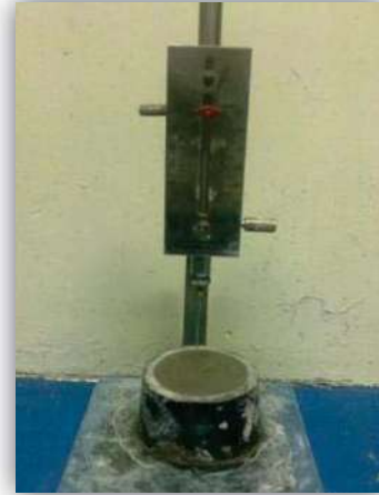
Figura 4.41. Fraguado final en el que la guja de 1 mm no penetra en la pasta de cemento
