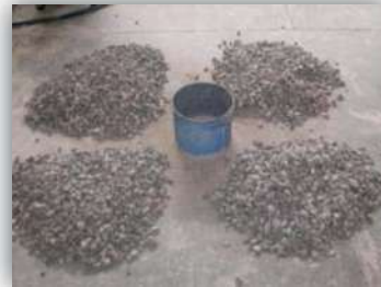
Se retienen cuartos opuestos y se desecha el resto (Grava Triturada)
