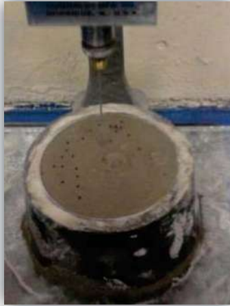
Figura 4.40. La aguja de 1mm penetra visiblemente en la pasta de cemento
