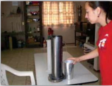
Figura 4.16. Recolección del líquido desalojado por la muestra (Grava volcánica)
