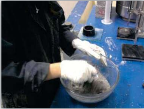
Figura 4.36. Amasado de la pasta (Cemento Tolteca CPC-30R)
