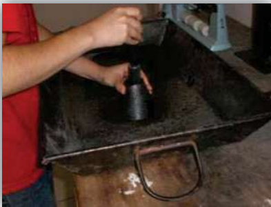
Figura 4.8. Secado superficial de la arena por medio del molde troncocónico (Arena volcánica)
