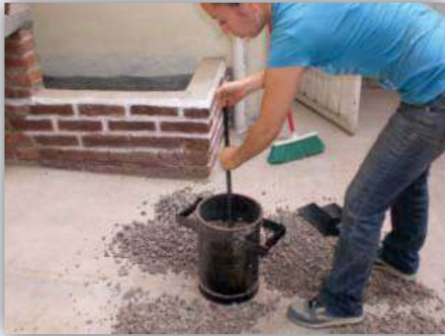
Figura 4.6. Se llena el recipiente en tres capas dando 25 golpes a cada capa (Grava de río)
