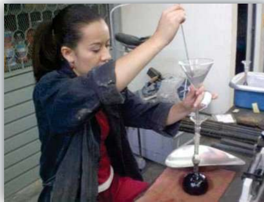
Figura 4.44. Introducción del cemento con embudo para evitar la adhesión del cemento con las paredes del matraz.
