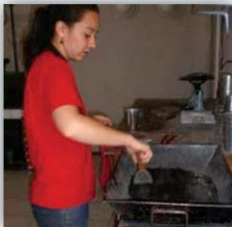
Figura 4.12. Secado de la muestra para eliminar por completo el agua absorbida (Arena volcánica)
