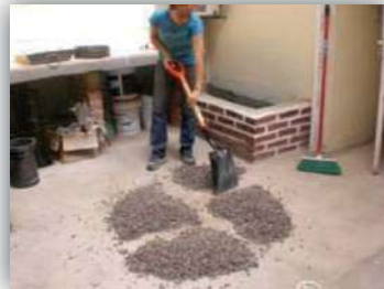
Muestra dividida en cuatro cuartos iguales (Grava redondeada)
