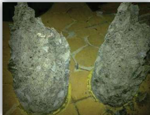
Figura 4.59. Prensa utilizada para la realización de la prueba, cilindros montados para la aplicación de la carga y espécimen fallado después de la prueba.
