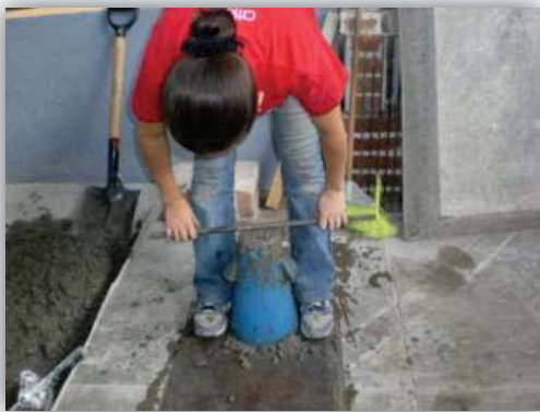
Figura 4.48. Enrasado del molde después del llenado de la última capa.
