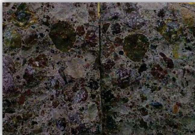
Figura 6.3. Falla Mixta, por medio del agregado y en la interface de contacto (Arena y grava de río)
