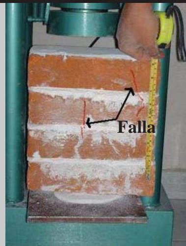
b) Falla por tracción lateral
