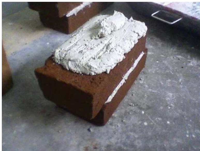
Figura 6.4. Elaboración de los Especímenes: Análisis de adherencia
