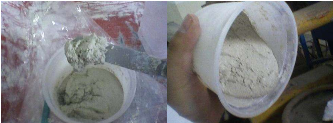
Figura 7.18. Características de la mezcla antes y después del Vibrado: Cal+Plastol 4000
