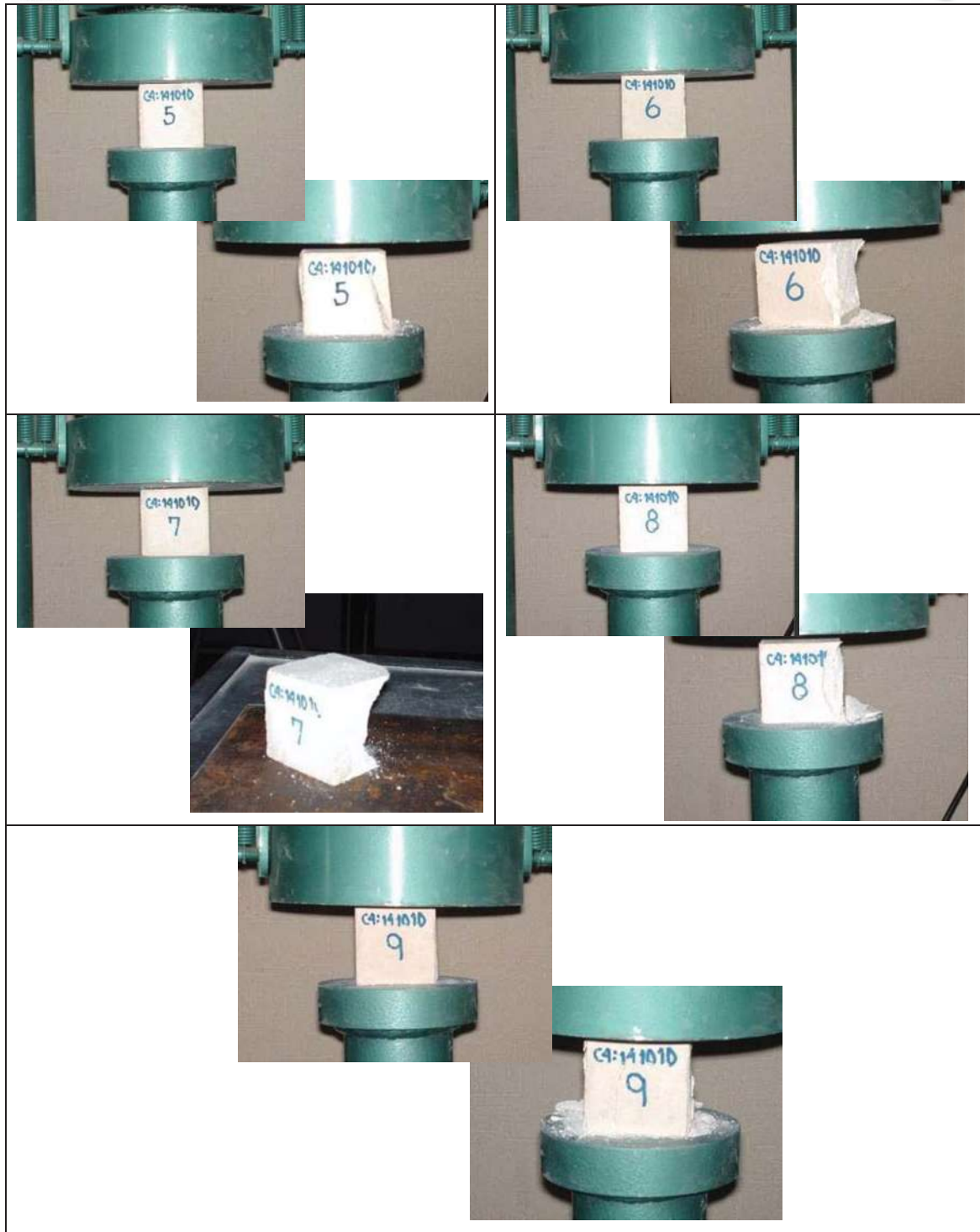
Figura 4.11. Falla por Compresión
