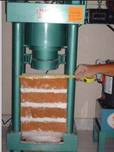
a) Falla por tracción lateral
