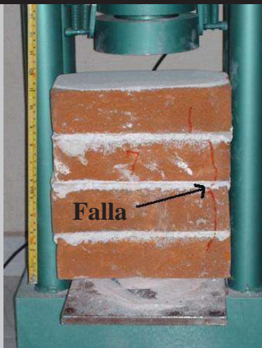
a) Falla por tracción lateral
