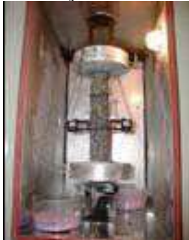
Figura 2.39. Ensayo de Espécimen Restringido de Tensión Térmica
