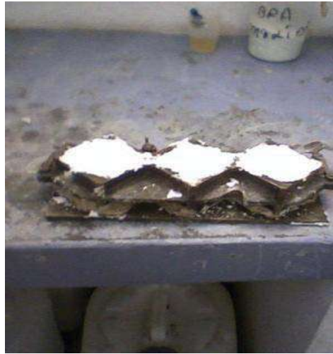
Figura 4.2. Colocación de la Mezcla en Moldes
