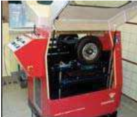
Figura 7.37. Ensayo de Deformación en Pista
