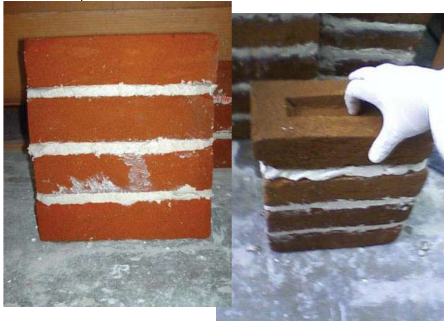
Figura 5.3. Construcción de Pilas
