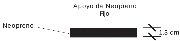
Figura 3. Características del apoyo de neopreno fijo.
