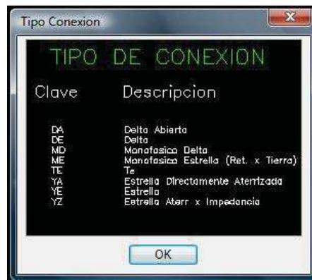
(Figura 54). Tipos de conexión de transformador C.F.E.
