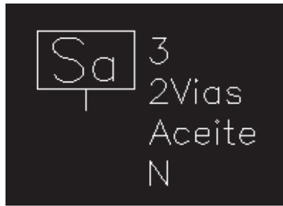
(Figura 129). Seccionador subterráneo.
