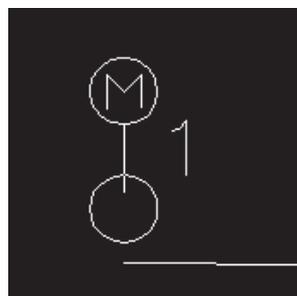
(Figura 70). Medidor.
