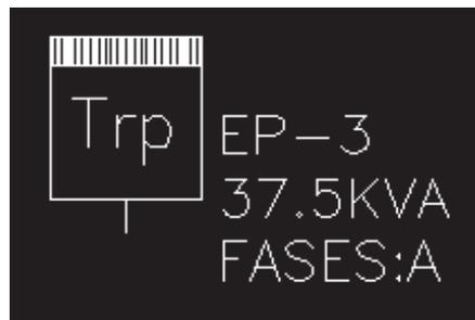
(Figura 126). Transformador particular subterráneo.
