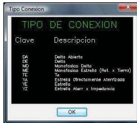
(Figura 59). Tipos de conexión de transformador particular.
