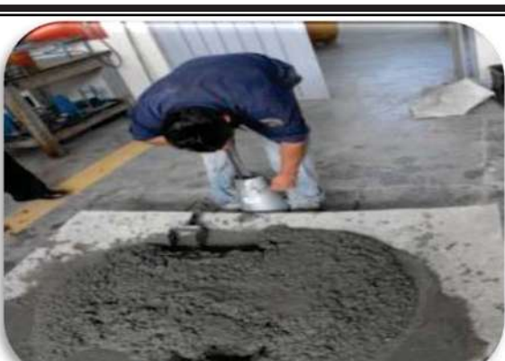
Fig. 4.3.4. Se realiza la prueba del revenimiento para verificar la calidad de la mezcla y su fluidez.
