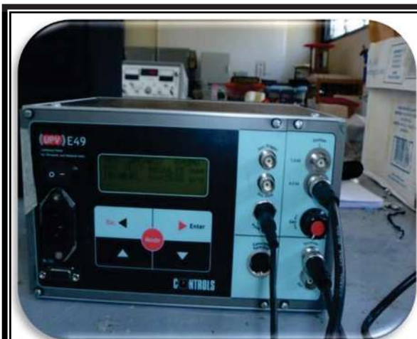
Fig. 4.4.1. Equipo para realizar prueba de velocidad de pulso ultrasónico.
