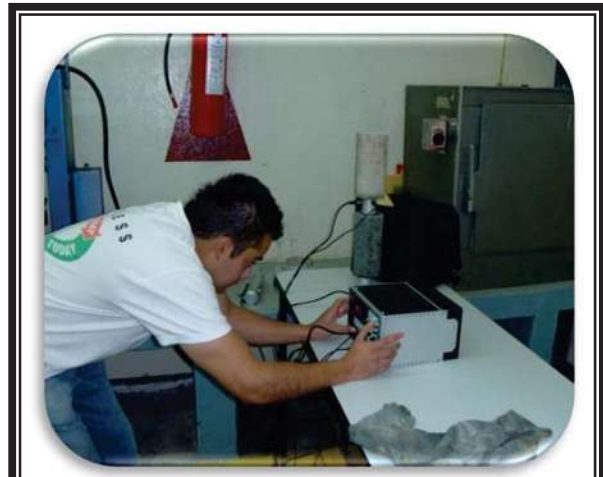
Fig. 4.4.2. Se coloca la muestra entre los transductores y se inicia la prueba.
