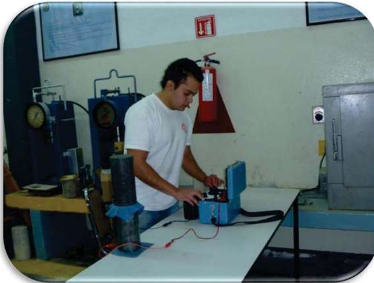
Fig. 4.5.3. Se colocan los cilindros entre 2 placas de cobre para y un trapo húmedo para una mejor conductividad.
