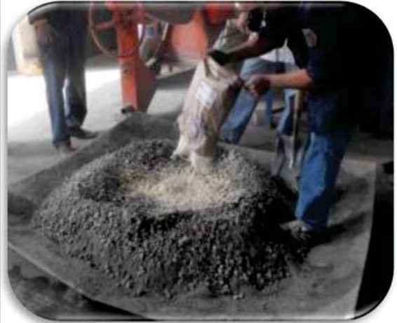
Fig. 4.3.2.2. Se agrega el cactus para los especímenes que contienen cactus, para los que no se les agrega cactus se omite este paso.
