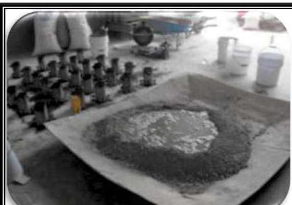
Fig. 4.3.3. Se adiciona agua a la mezcla, la cantidad de agua fue calculada en el proporcionamiento.
