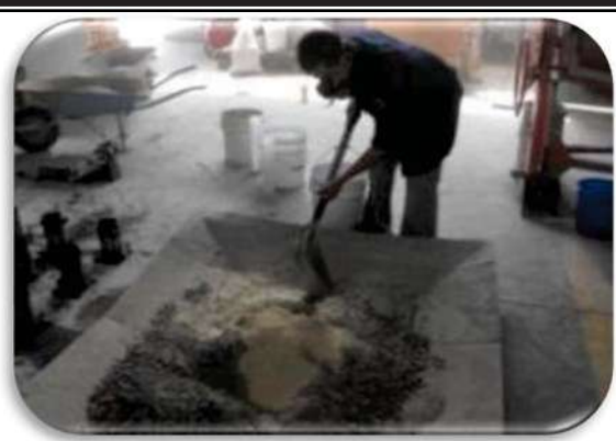
Fig. 4.3.2. Revoltura del material pétreo con el cactus, la cantidad del material se calculó en el proporcionamiento.
