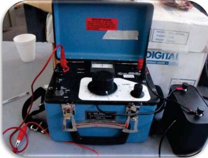
Fig. 4.5.2. Equipo para medir la resistividad de los especímenes.
