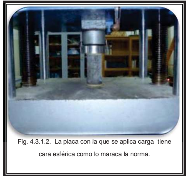
Fig. 4.3.1.1. Se probó la muestra controlando la velocidad de carga y registrando su resultado
