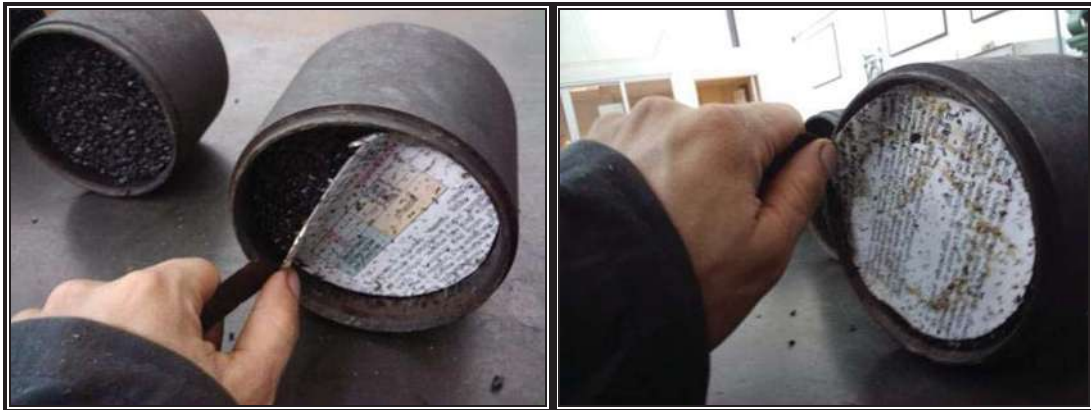
FIGURA 37 Retiro de la base de papel que se utilizó para evitar que se adhiriera mezcla a la base del molde y al pisón.
