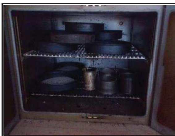
FIGURA 30 Acomodo de charolas y moldes dentro del horno eléctrico de ventilación forzada.
