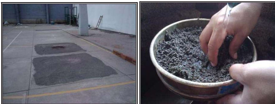
FIGURA 28 Lavado, tendido y secado del material pétreo.
