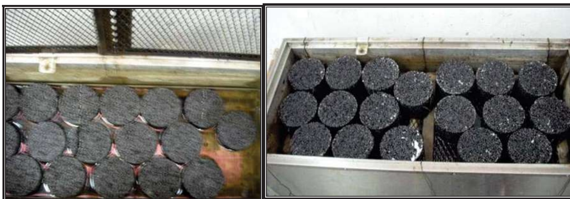
FIGURA 42 Probetas Marshall después de las 24 hr en baño María y también se muestra la parrilla que se acondiciono para meter una segunda cama de probetas al Baño María.
