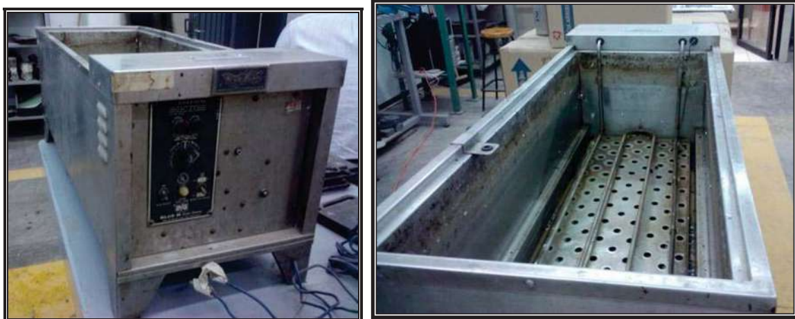
FIGURA 40 Máquina para Baño María ó Baño Marshall, con que se cuenta en el laboratorio "Ing. Luis Silva Ruelas" de la facultad de Ing. Civil de la U.M.S.N.H.
