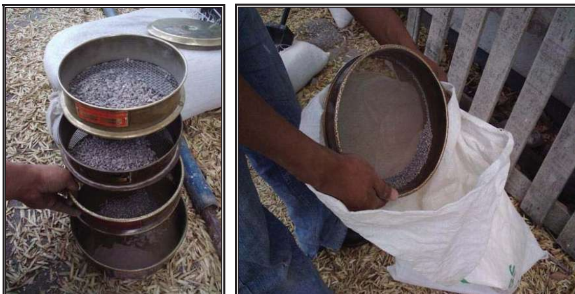
FIGURA 27 Cribado de material pétreo.
