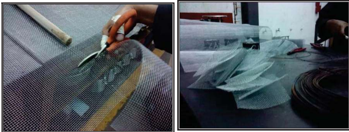
FIGURA 43 Proceso de corte y obtención de las mallas para proteger las probetas cuando sean sometidas al envejecimiento en el horno eléctrico de ventilación forzada.
