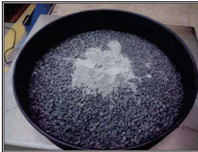
FIGURA 31 Material pétreo después del pre-condicionamiento en el horno.
