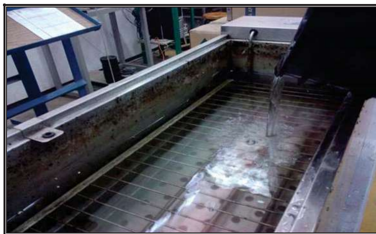
FIGURA 41 Máquina llena de agua para que esta adquiera la temperatura de 60°C antes de introducir las probetas Marshall.
