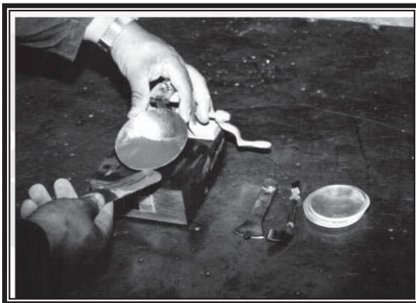
FIGURA 10 Acomodo del material en la copa de determinación del Límite Líquido
