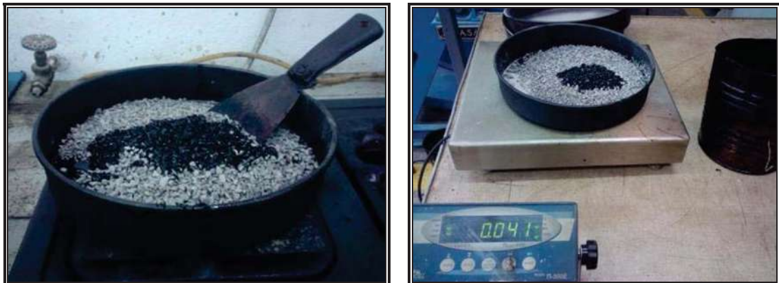
FIGURA 34 Material pétreo después del pre-condicionamiento en el horno y con el asfalto listo para comenzar a mezclarlo
