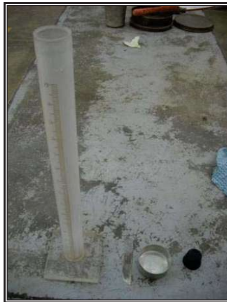
FIGURA 19 Material para prueba del Equivalente de arena (Probetas, capsula de aluminio, tapón y navaja de cutter para enrasar la capsula.
