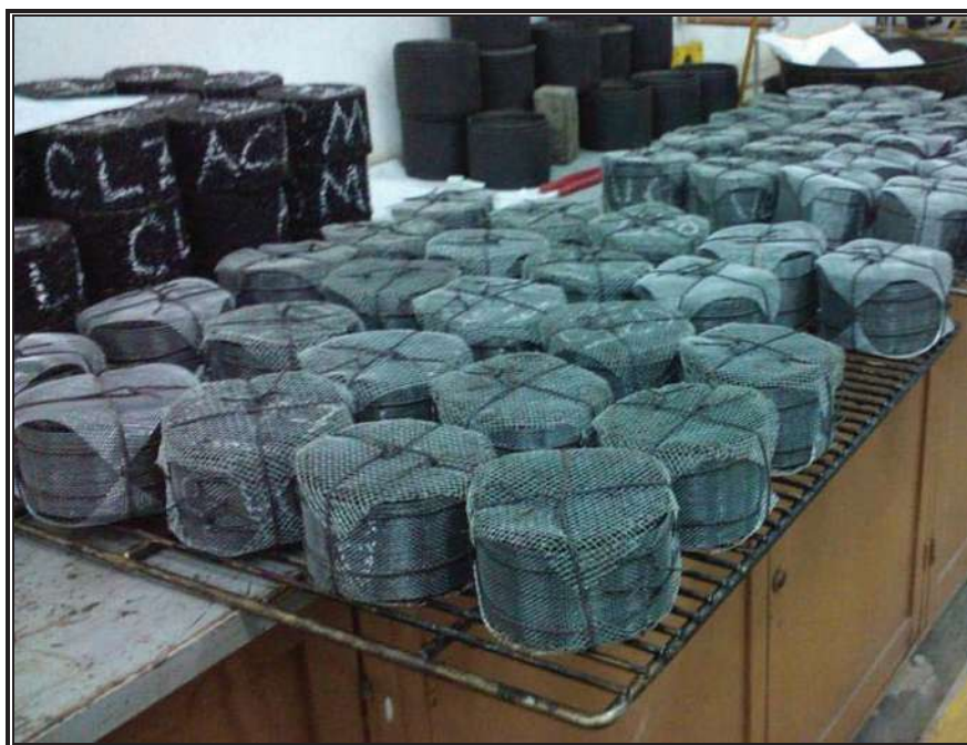
FIGURA 50 Vista de las probetas en las parrillas del horno para someterlas al envejecimiento.
