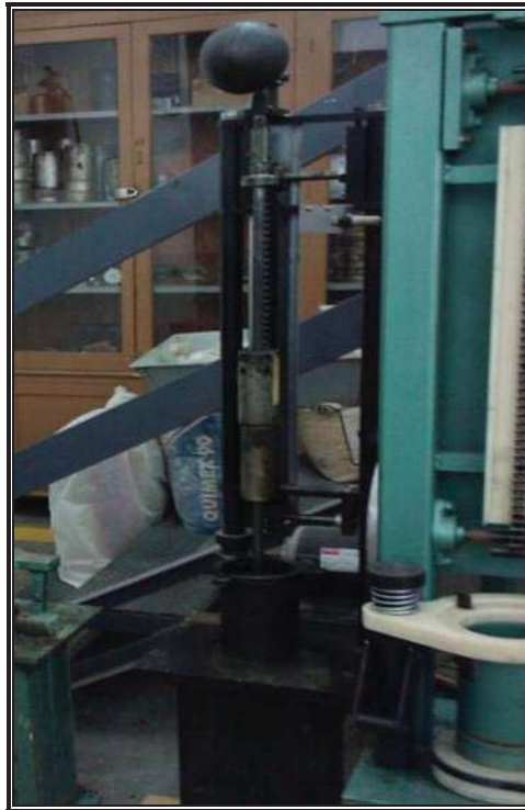
FIGURA 36 Compactación de probeta Marshall.
