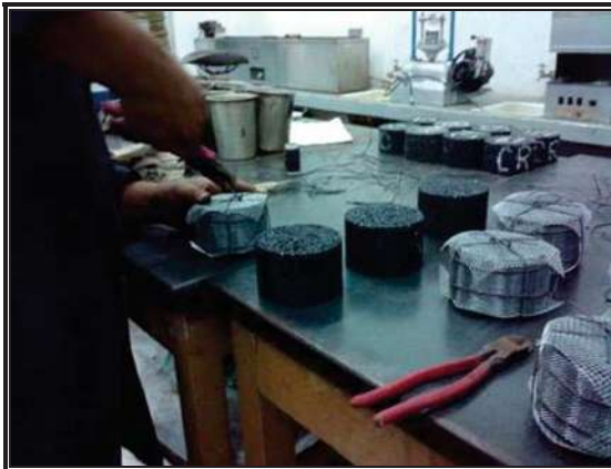
FIGURA 45 Vista de la probeta una vez que se le ha colocado la malla en las caras planas de la probeta.
