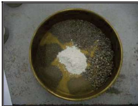
FIGURA 18 Preparación de muestras para el Equivalente de Arena
