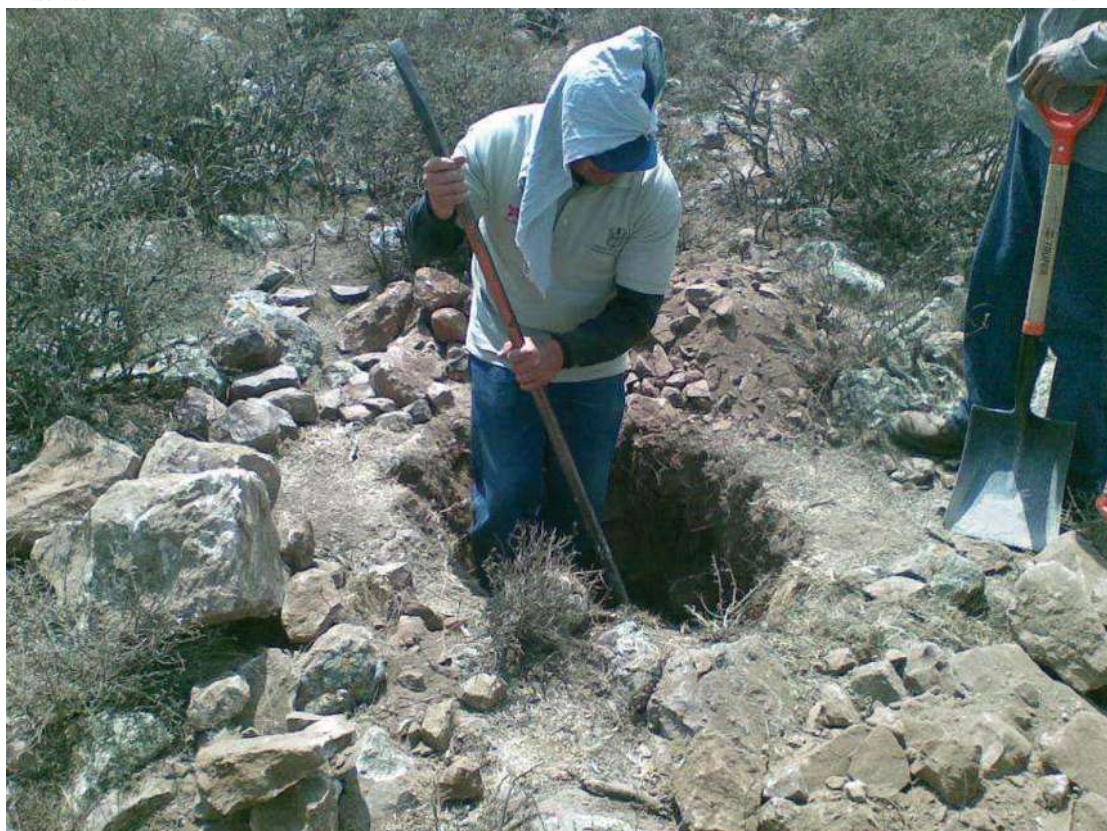
FOTOGRAFIA 37. Excavación de pozo a cielo abierto “PCA”. (LMSUG).
