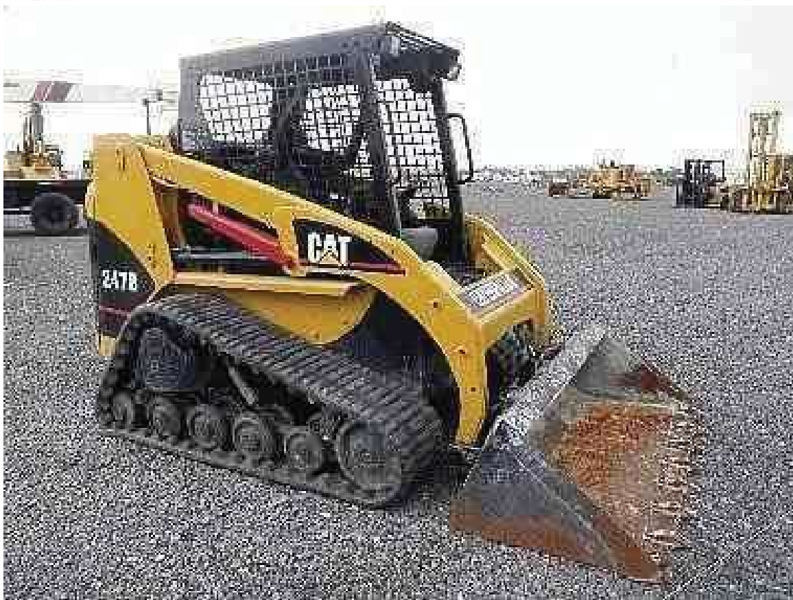
FOTOGRAFÍA 47. Mini cargador Frontal Caterpillar 247B montado sobre orugas.
