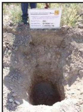
Fotografía No. 24.- P.C.A. 8 ubicado en el km 3+500 de 1.50 m de profundidad. En Donde se encontró arena mal graduada poco húmeda medianamente compacta. De color café claro. **SP**
