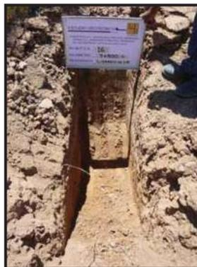
Fotografía No. 42- P.C.A. 16 ubicado en el km 7+500 de 1.50 m de profundidad. En donde se encontró arcilla inorgánica de baja plasticidad, de consistencia firme de color café claro **CL**.
