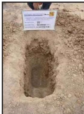
Fotografía No. 42- P.C.A. 22 ubicado en el km 10+500 de 1.30 m de profundidad. En donde se encontró arcilla inorgánica de alta plasticidad de consistencia muy firme de color café claro**CH**.
