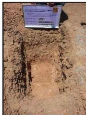
Fotografía No. 42- P.C.A. 23 ubicado en el km 11+000 de 1.40 m de profundidad. En donde se encontró arena arcillosa poco húmeda muy compacta, de color café claro **SC**.
