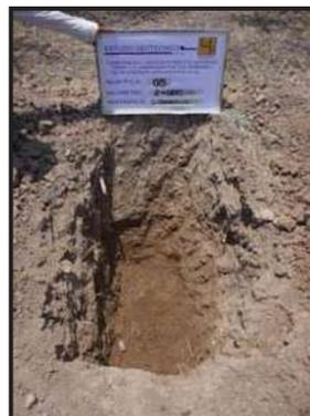
Fotografía No. 15.- P.C.A. 5 ubicado en el km 2+000 de 1.30 m de profundidad. En Donde se encontró arcilla inorgánica de baja plasticidad de consistencia firme. De color Café claro. **CL**
