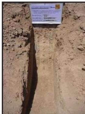
Fotografía No. 33.- P.C.A. 11 ubicado en el km 5+000 de 1.50 m de profundidad. En Donde se encontró arcilla inorgánica de baja plasticidad de consistencia firme. De color Café claro. **CL**
