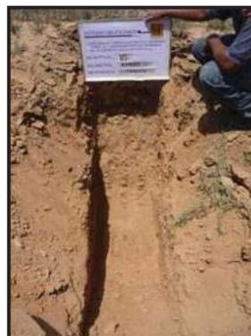
Fotografía No. 30.- P.C.A. 10 ubicado en el km 4+500 de 1.60 m de profundidad. En Donde se encontró arena arcillosa poco húmeda medianamente compacta. De color Café claro. **SC**
