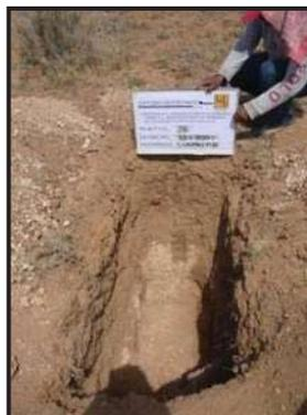
Fotografía No. 42- P.C.A. 26 ubicado en el km 12+500 de 1.60 m de profundidad. En donde se encontró arena arcillosa poco húmeda medianamente compacta, de color café claro **SC**.
