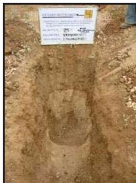
Fotografía No. 42- P.C.A. 29 ubicado en el km 14+100 de 1.50 m de profundidad. En donde se encontró grava arcillosa compacta, de color café claro **GC**.
