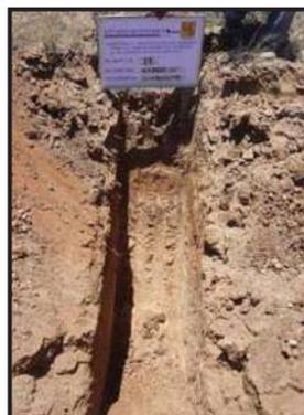
Fotografía No. 42- P.C.A. 14 ubicado en el km 6+500 de 1.70 m de profundidad. En donde se encontró arena arcillosa poco húmeda compacta. De color café claro. **SC**
