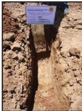
Fotografía No. 42- P.C.A. 15 ubicado en el km 7+000 de 1.50 m de profundidad. En donde se encontró arena arcillosa poco húmeda compacta, de color café claro **SC**.
