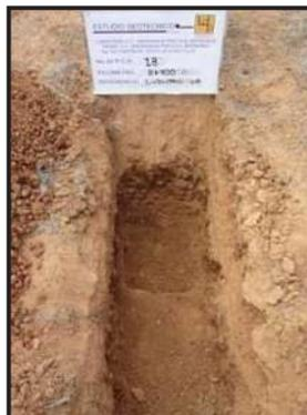
Fotografía No. 42- P.C.A. 18 ubicado en el km 8+400 de 1.00 m de profundidad. En donde se encontró arena arcillosa poco húmeda compacta, de color café claro **SC**.
