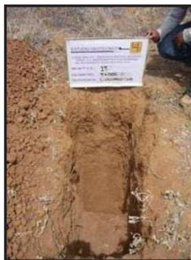
Fotografía No. 42- P.C.A. 19 ubicado en el km 9+000 de 1.20 m de profundidad. En donde se encontró arcilla inorgánica de baja plasticidad de consistencia muy firme de color café claro **CL**.
