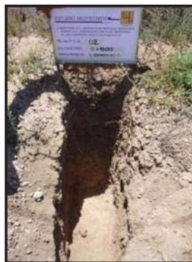
Fotografía No. 6.- P.C.A. 2 ubicado en el km 0+500 de 1.40 m de profundidad. En
