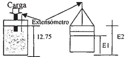
El molde se saca del agua, se escurre durante 3 minutos y se procede a penetrarlo, con una velocidad de 1.27 mm por minuto, dando inicialmente una carga de 10 kgs.
