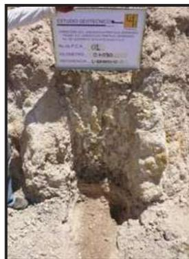
Fotografía No. 3.- P.C.A. 1 ubicado en el km 0+030 de 1.50mde profundidad. En Donde se encontró arena limosa mal graduada poco húmeda medianamente compacta. De color café claro. **SP-SM.**
