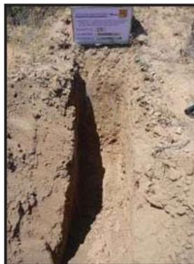
Fotografía No. 42- P.C.A. 17 ubicado en el km 8+000 de 1.60 m de profundidad. En donde se encontró arena arcillosa poco húmeda compacta, de color café claro **SC**.
