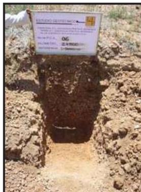
Fotografía No. 18.- P.C.A. 6 ubicado en el km 2+500 de 1.10 m de profundidad. En Donde se encontró arena arcillosa poco húmeda compacta. De color café claro. **SC**
