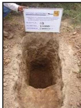
Fotografía No. 9.- P.C.A. 3 ubicado en el km 1+000 de 1.40 m de profundidad. En Donde se encontró arena arcillosa poco húmeda medianamente compacta. De color Café claro. **SC**
