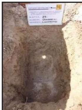
Fotografía No. 42- P.C.A. 27 ubicado en el km 13+000 de 1.50 m de profundidad. En donde se encontró arena arcillosa poco húmeda compacta, de color café claro **SC**.
