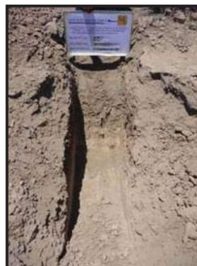
Fotografía No. 36.- P.C.A. 12 ubicado en el km 5+500 de 1.60 m de profundidad. En Donde se encontró arcilla inorgánica de baja plasticidad de consistencia firme. De color café claro. **CL**
