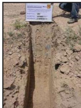
Fotografía No. 27.- P.C.A. 9 ubicado en el km 4+000 de 1.70 m de profundidad. En Donde se encontró arcilla inorgánica de baja plasticidad de consistencia media. De color Café claro. **CL**
