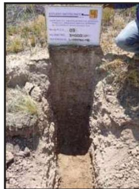
Fotografía No. 21.- P.C.A. 7 ubicado en el km 3+000 de 1.40 m de profundidad. En Donde se encontró arena arcillosa poco húmeda compacta. De color café claro. **SC**
