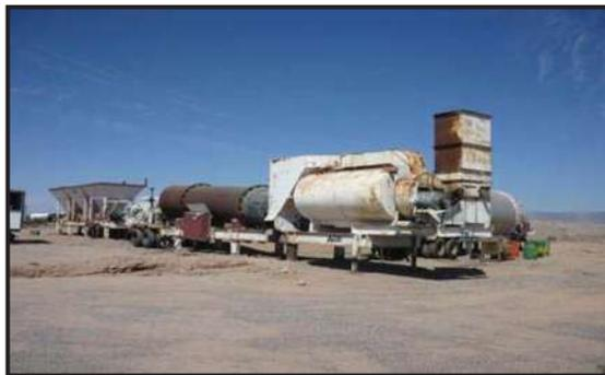
Fotografía 6.- Planta de asfalto móvil del banco San Francisco de la Sierra.
