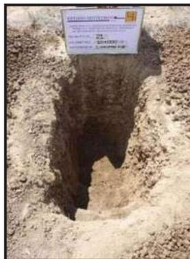
Fotografía No. 42- P.C.A. 21 ubicado en el km 10+000 de 1.30 m de profundidad. En donde se encontró arcilla inorgánica de alta plasticidad de consistencia muy firme de color café claro**CH**.
