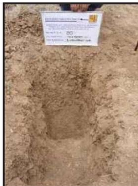
Fotografía No. 42- P.C.A. 20 ubicado en el km 9+500 de 1.20 m de profundidad. En donde se encontró arcilla inorgánica de baja plasticidad de consistencia muy firme de color café claro **CL**.
