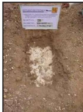
Fotografía No. 42- P.C.A. 28 ubicado en el km 13+500 de 0.40 m de profundidad. En donde se encontró arena arcillosa poco húmeda compacta, de color café claro **SC**.
