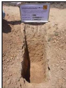
Fotografía No. 12.- P.C.A. 4 ubicado en el km 1+500 de 1.40 m de profundidad. En Donde se encontró arcilla inorgánica de baja plasticidad de consistencia media. De color Café claro. **CL**
