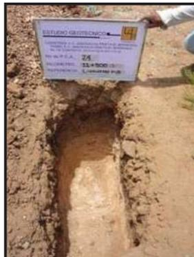
Fotografía No. 42- P.C.A. 24 ubicado en el km 11+500 de 1.10 m de profundidad. En donde se encontró arena arcillosa poco húmeda muy compacta, de color café claro **SC**.
