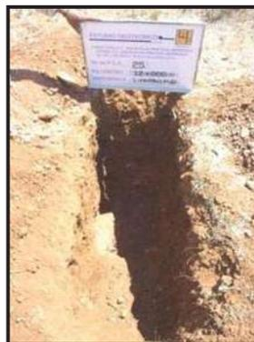
Fotografía No. 42- P.C.A. 25 ubicado en el km 12+000 de 1.20 m de profundidad. En donde se encontró grava arcillosa compacta de color café claro **GC**.
