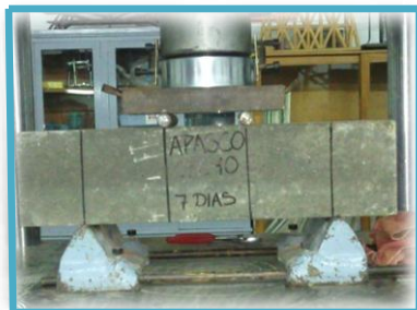
Fig. 7.12. Ruptura en el tercio medio del claro presente en todas las vigas
