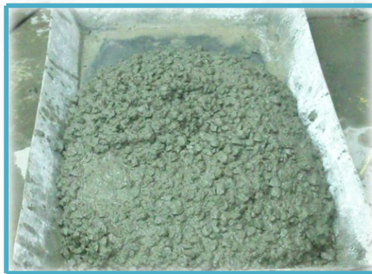
Fig. 7.5. Concreto hidráulico elaborado en olla revolvedora.
