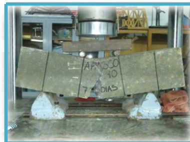
Fig. 7.12. Ruptura en el tercio medio del claro presente en todas las vigas
