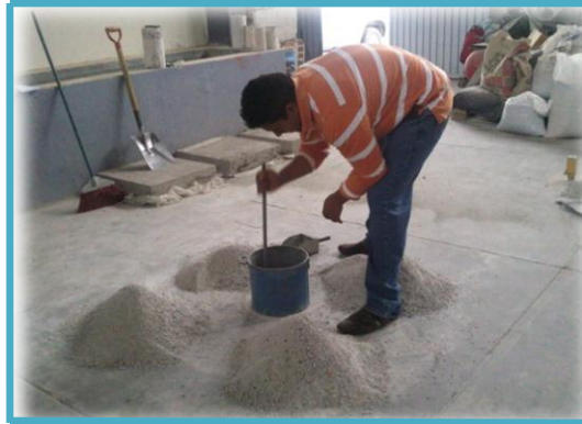
Fig. 6.1.4. Determinación del Peso Volumétrico Seco Varillado
