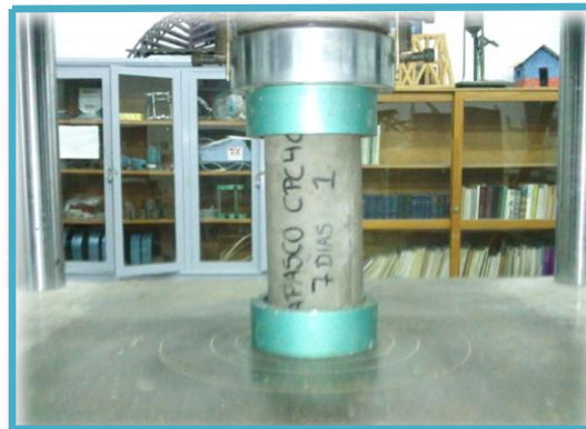
Fig. 7.10. La placa con la que se aplica la carga es de cara esférica como indica la norma.
