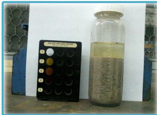
Fig. 6.1.6. Comparación con la tabla colorimétrica.
