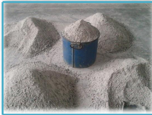
Fig. 6.1.3. Después de llenar el molde se enrasa para así poder determinar el PVSS
