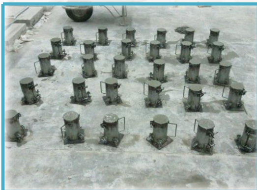
Fig. 7.7. Una vez colados se descimbraban después de 24 horas.
