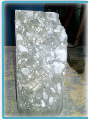
Fig. 7.11. Apreciación de la falla en el cemento más no en el agregado.
