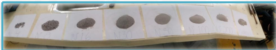
Fig. 6.1.5. Material retenido en cada una de las mallas.
