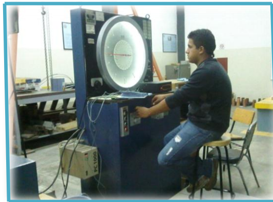
Fig. 7.9. Se registraba la carga para cada uno de los especímenes y se controlaba la velocidad de carga.
