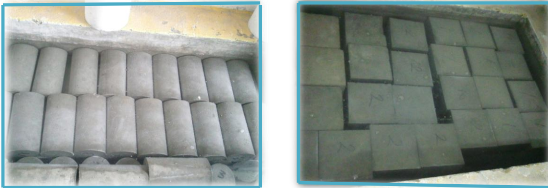
Fig. 7.8. Curado de cilindros y vigas.
