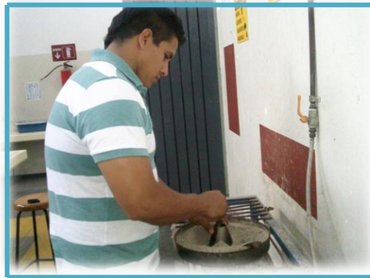
Fig. 6.1.2. Una vez determinada la humedad superficial con el cono, se toma una muestra representativa para determinar su absorción.
