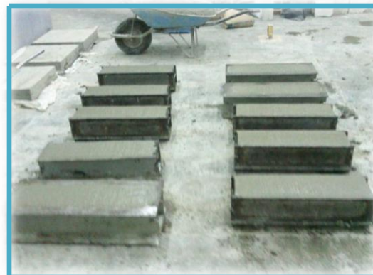
Fig. 7.7. Una vez colados se descimbraban después de 24 horas.
