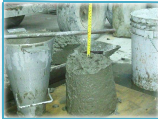
Fig. 7.6. Revenimiento obtenido con el cemento Moctezuma
