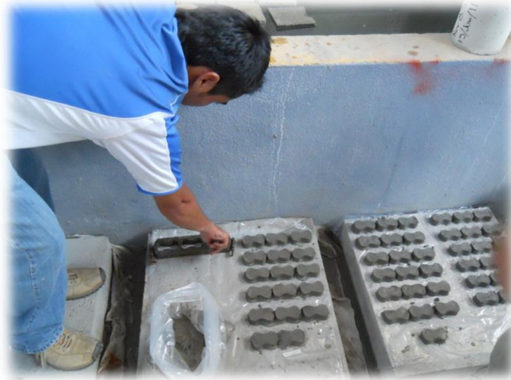
Figura 8.17. Eaboración de briquetas. 1
