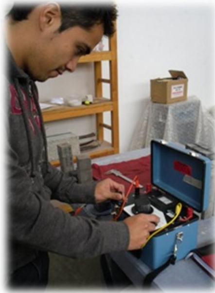
Figura 8.22.- Uso del Resistómetro.
