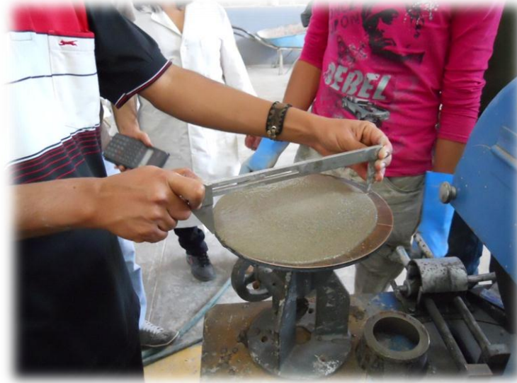
Figura 8.5.- Medición del diámetro de la mezcla sobre la mesa de fluidez.
