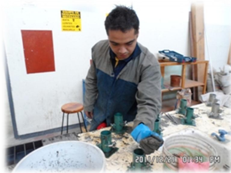
Figura 8.13.- Llenado de especímenes cilíndricos.
