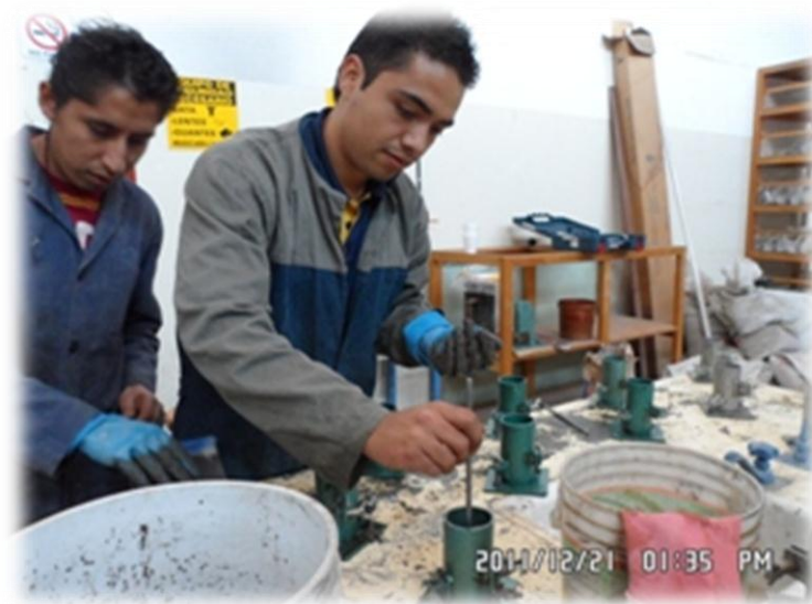
Figura 8.14.- Golpeo con varilla punta de bala.
