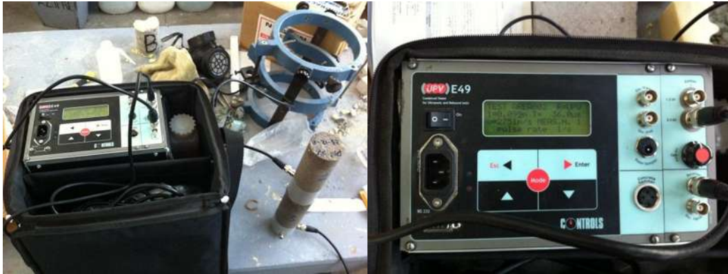
Figura 8.23. Equipo para medir la velocidad de pulso ultrasónico, CONTROLS.
