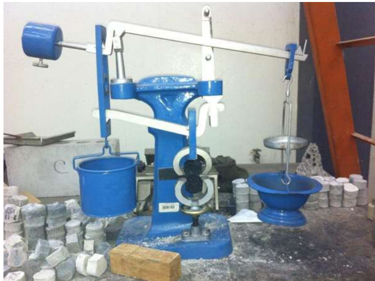
Figura 10.3. Tensión en briquetas, máquina Michellis.
