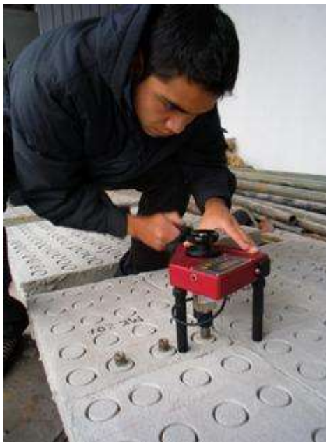
Figura 10.5.- Realización de las pruebas de adherencia.
