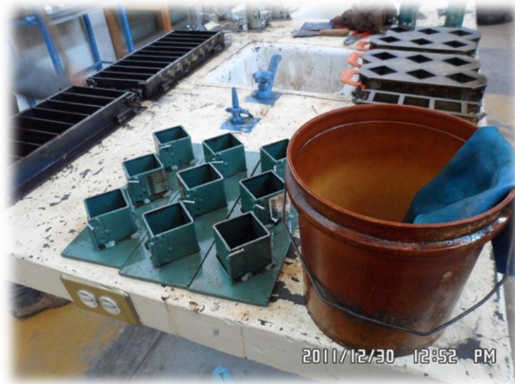
Figura 8.11. Engrasado de Moldes
