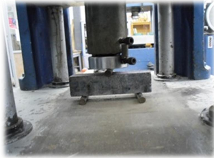
Figura 10.2. Prueba a flexión en primas.
