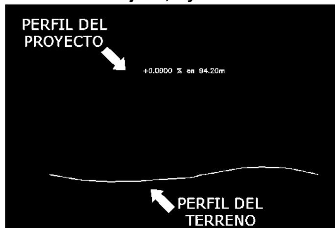
**FIGURA 153.- PERFILES DE TERRENO Y PROYECTO DE LA GLORIETA DERECHA (EJE 5)**
