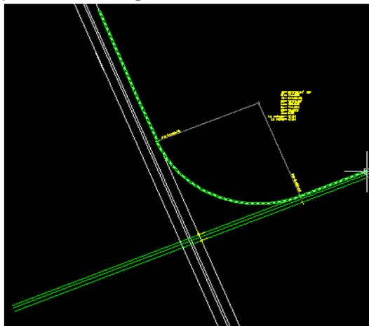
**FIGURA 136.- CURVA HORIZONTAL DISEÑADA CON SUS DATOS ANOTADOS DEL EJE 2**
