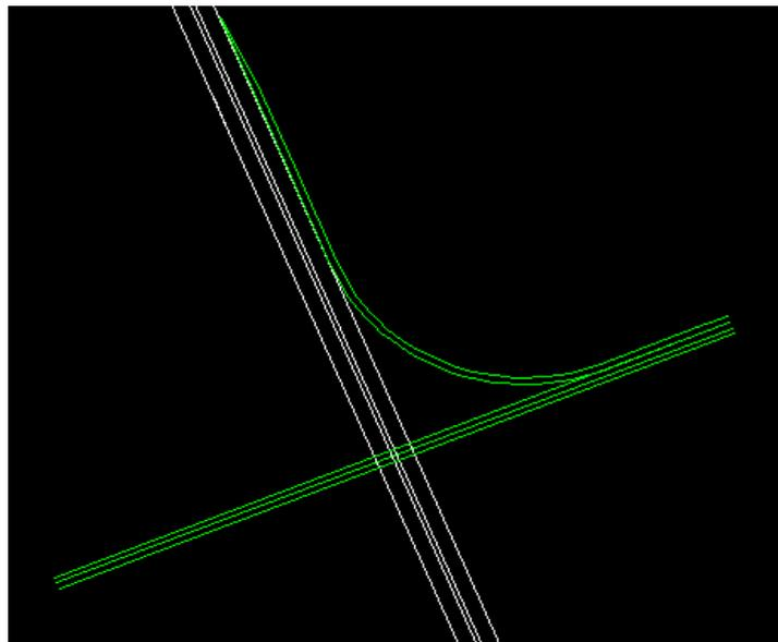
**FIGURA 150.- TRAZO TERMINADO DEL EJE 2 CON SU CARRIL DE ACELERACIÓN.**
