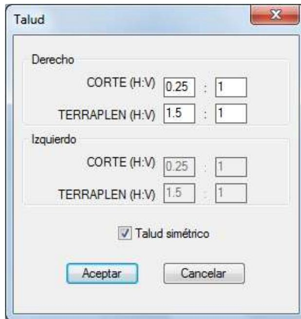
**FIGURA 91.A- DISEÑO DEL TALUD**
