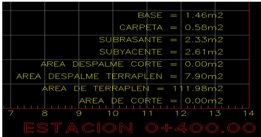
**FIGURA 100.- ÁREAS DE CADA UNA DE LAS CAPAS DE LAS SECCIONES POR ESTACIÓN**
