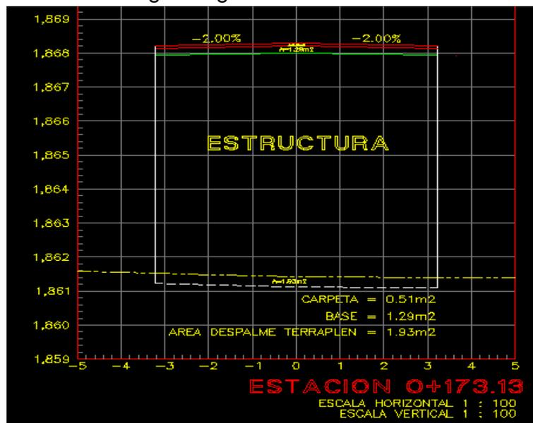
**FIGURA 103.- SECCIÓN MODIFICADA DE LA ESTRUCTURA**
