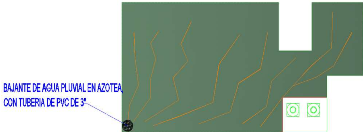
Figura 5.11. Localización del bajante pluvial.
