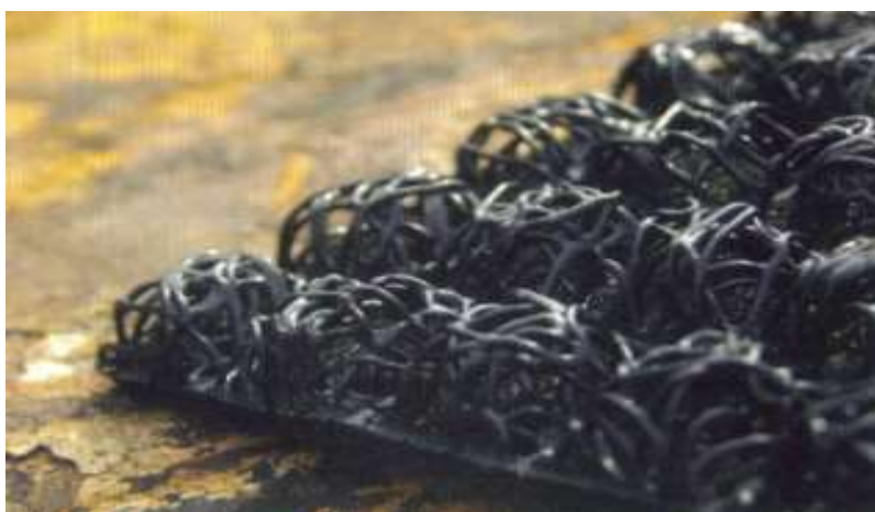
Figura 5.30. Tipo de capa dren propuesto para el proyecto. (Construmática, 2011).
