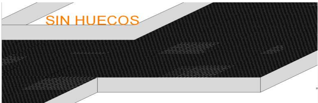
Figura 5.35. Piezas de capa dren colocadas traslapadas y sin huecos.
