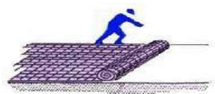
Figura 5.36. Desenrollado a mano de geotextil utilizado como capa filtrante. (Gemia, 2011).
