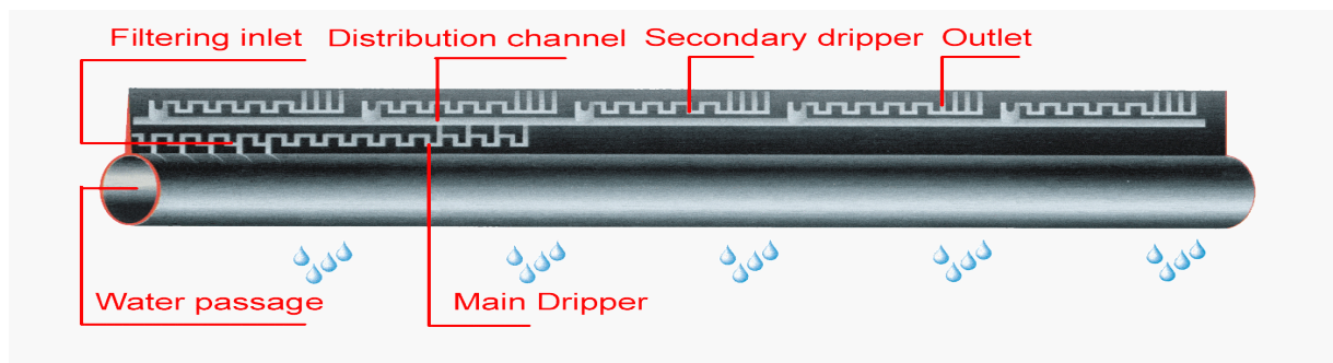
Figura 5.47. Cinta de riego con goteros incluidos (Queengil, 2011).
