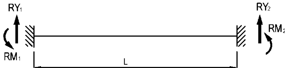
Figura 1.6 Fuerzas de empotramiento perfecto en una viga
