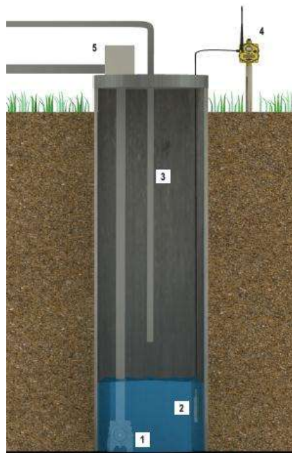
Figura 3.22 Bomba de control de lixiviado.
