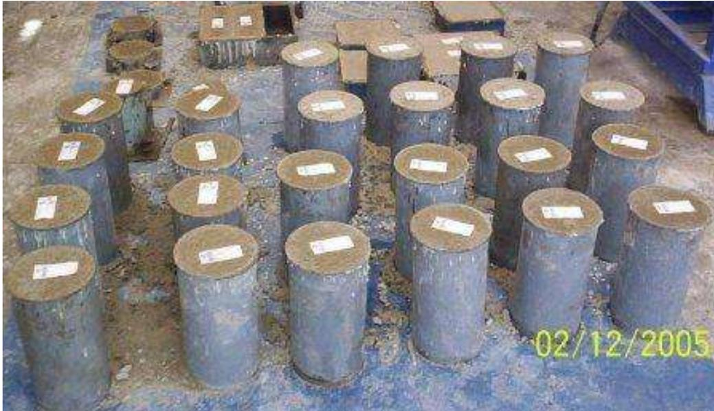
El control de calidad de la edificación consistió en realizar una rutina de muestreo-ensaye en donde el muestreo se realizó bajo el criterio de obtener una muestra (3 especímenes estándar) por cada 30 m<sup>3</sup> de concreto colocado en obra, realizando muestreo y ensaye de agregados pétreos cada vez que reabastecía el almacenamiento de los pétreos, en lo referente al cemento se aplicó el mismo criterio (obtener una muestra por góndola)
