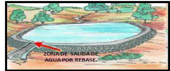
IMAGEN 2.6. LAGUNA CON TALUD DE PIEDRA, ARENA Y CEMENTO.
