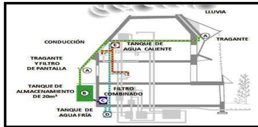
FIGURA 2.5. ESQUEMA DE FUNCIONAMIENTO DEL SISTEMA DE APROVECHAMIENTO DE AGUA LLUVIA LLAMADO "HEALTHY HOUSE" EN TORONTO, CANADÁ.
