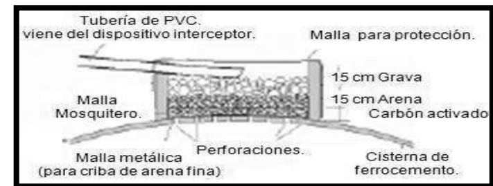
FIGURA 3.14. FILTRO SOBRE ALMACENAMIENTO DE FERROCEMENTO.
