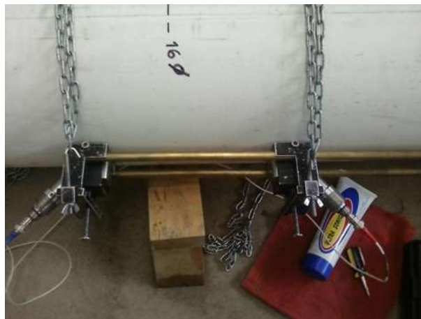
Figura 6.4. Posición de los sensores con la cual dio mejores resultados.
