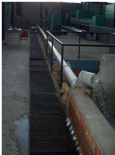
Figura 6.12 toma de lecturas a lo largo de la tubería.
