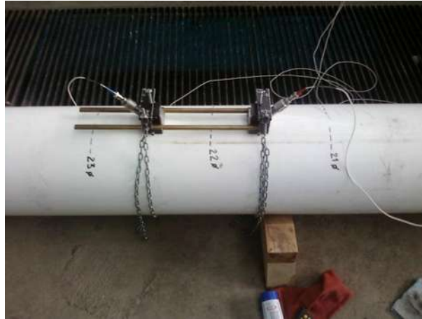
Figura 6.11 Posición de los sensores en con la cual se obtuvieron mejores resultados.
