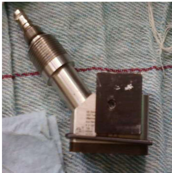
Figura 6.6. Posición del sensor armado correctamente.
