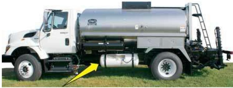
**Figura 34:** Tanque para almacenar gas LP.
