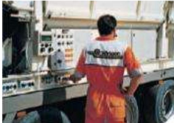
**Figura 23:** a) barra de empuje, b) microprocesador de mando de la dosificadora WM 1000.
