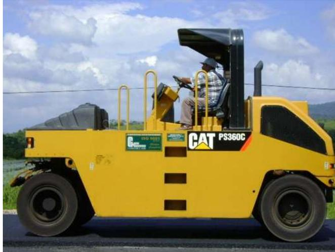
**Figura 47:** Compactador de neumáticos PS 360C CAT.
