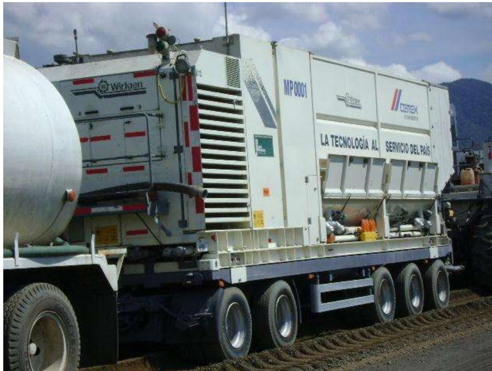
**Figura 21:** Dosificadora o mezcladora de suspensión WM 1000.
