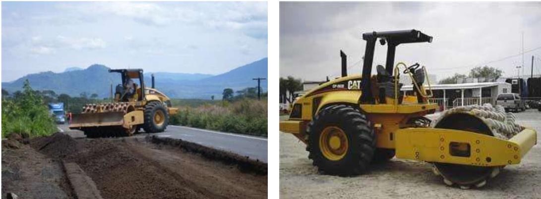
**Figura 28:** Equipo de compactación tipo pata de cabra.
