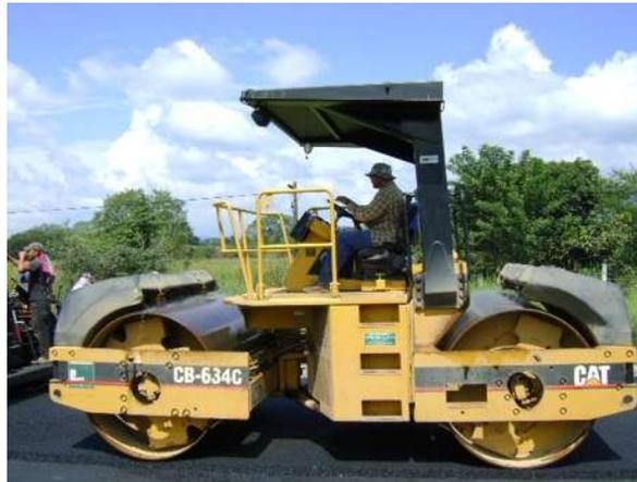
**Figura 46.** Compactador de doble rodillo liso CB 634C CAT.
