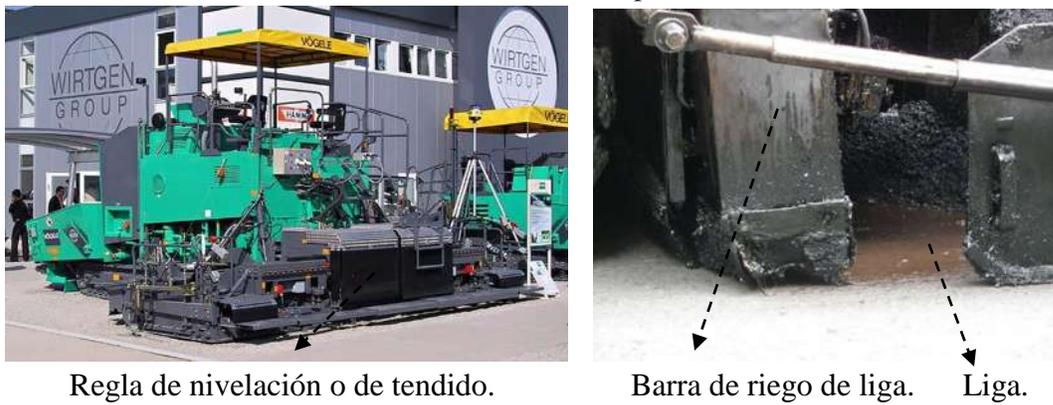
**Figura 51:** Regla de tendido y barra de riego de liga.
