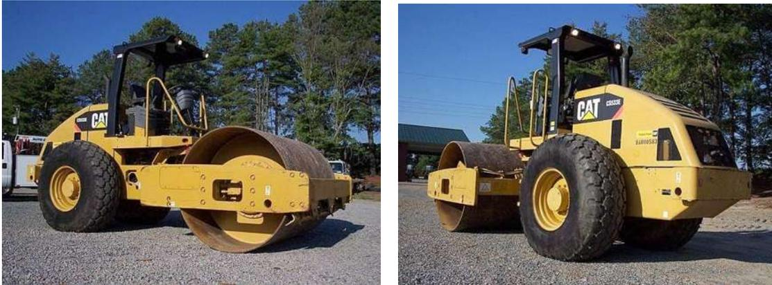
**Figura 29:** Equipo de compactación de rodillo liso.
