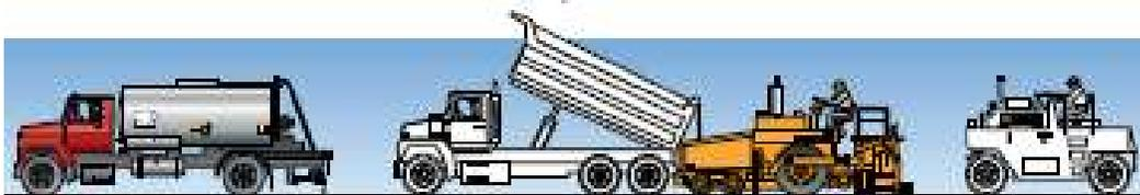
**Figura 33:** Diagrama del proceso constructivo de la carpeta asfáltica.
