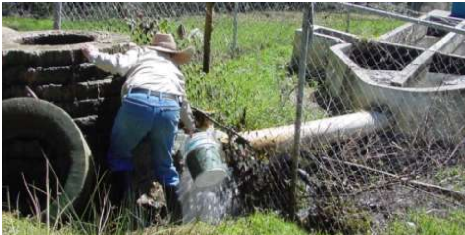
Figura 21. Momento en el que se realizó uno de los aforos volumétricos.
