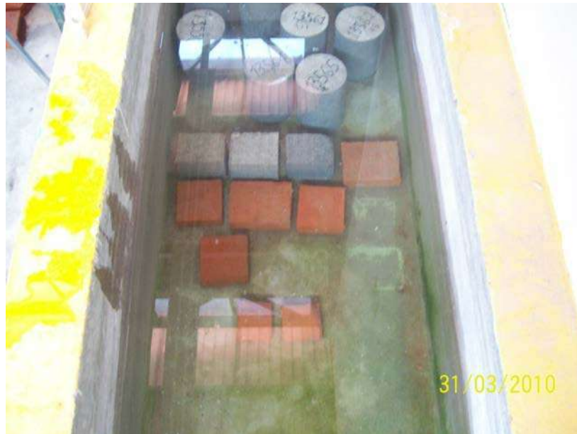
Fotografía 2.5 Muestras sumergidas en agua durante 24h.
