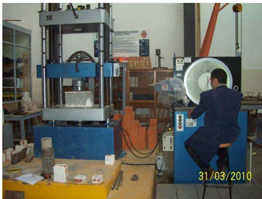
Fotografía 2.7 Muestra sujeta a compresión por medio de la máquina universal de pruebas.
