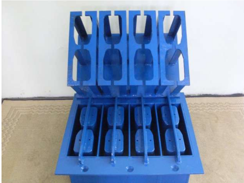
Figura 4.29 Molde para bloques.
