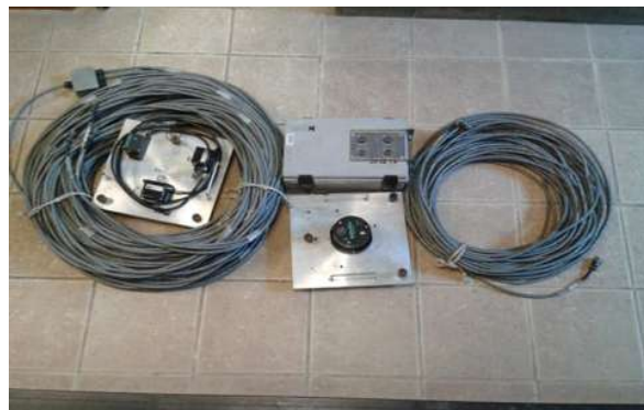
Fig. 28. Equipo utilizado para las mediciones de vibración ambiental.
