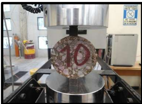
Figuras 10a y 10b. Configuración de carga en el ensayo de Tensión Indirecta.
