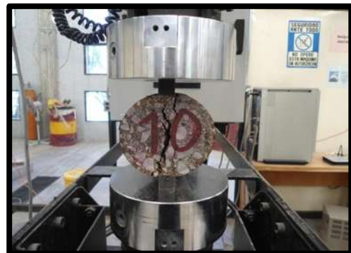
Figuras 10a y 10b. Configuración de carga en el ensayo de Tensión Indirecta.
