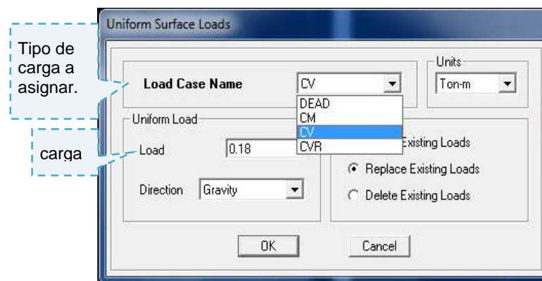
Fig. 3.5.2.c Cargas actuantes: Cv, Cvr y Cm.
