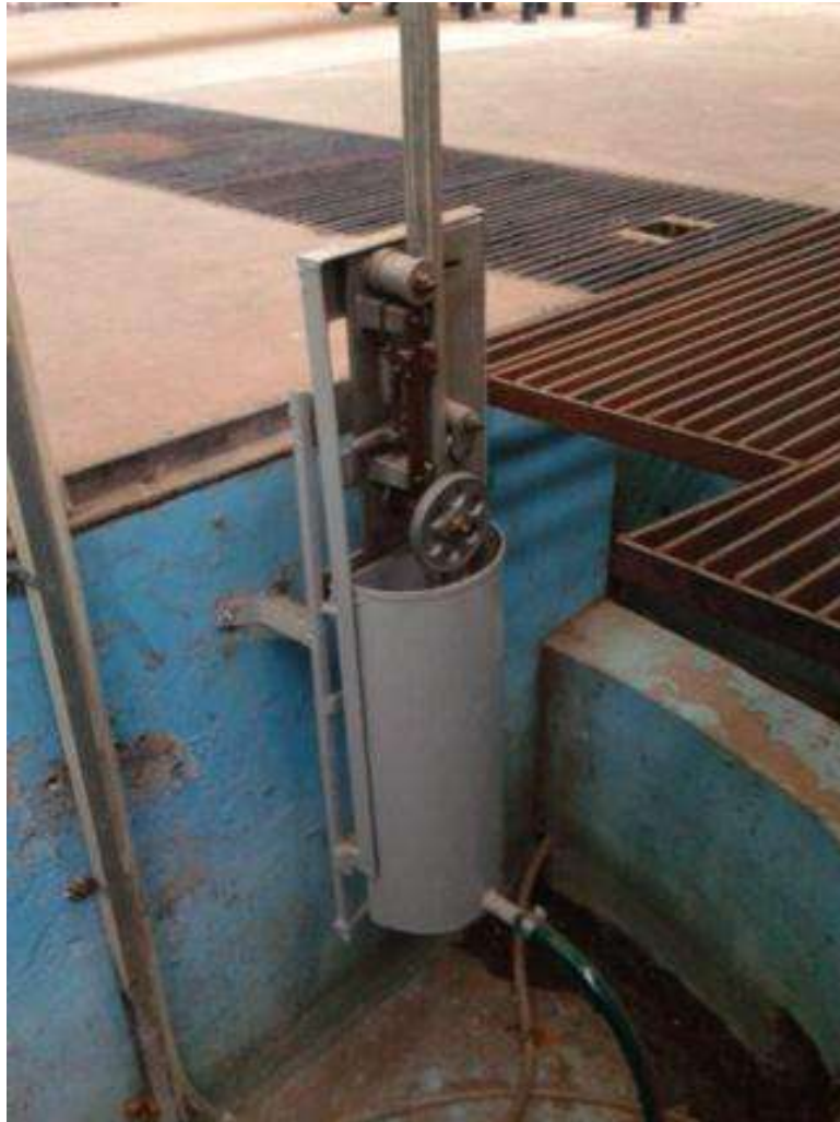
Figura 11. Medición de la carga en el vertedor a través de limnómetro
