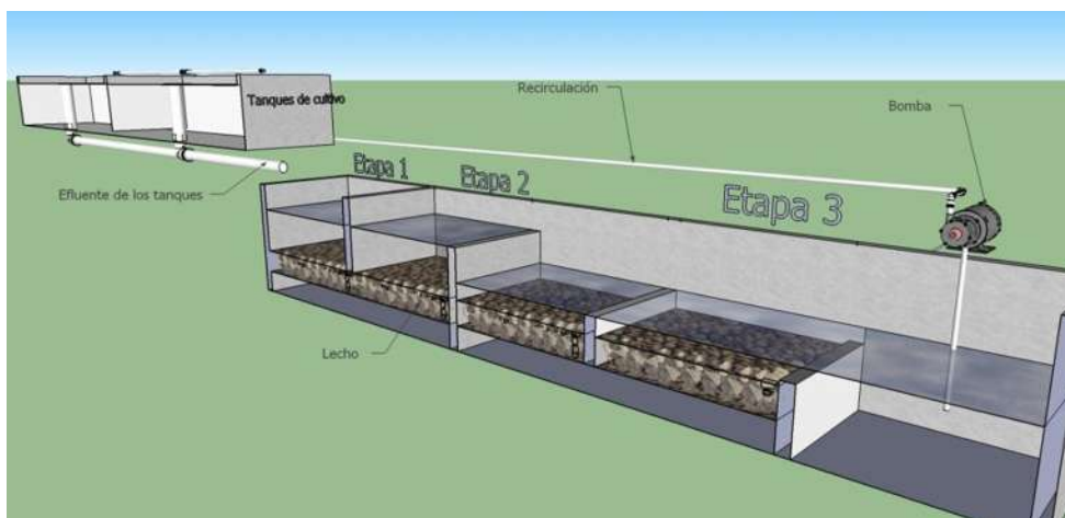
Figura 4.1. Estructura del sistema de recirculación y reactor.
