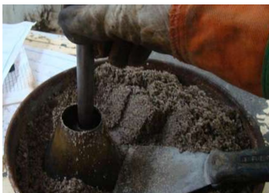
Figura 2.7 Prueba de porcentaje de humedad de absorción.
