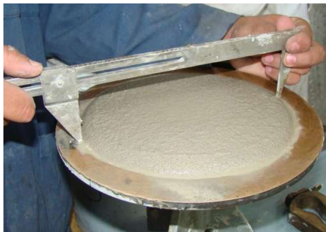
Figura 4.2 Medición del diámetro en la prueba de fluidez.
