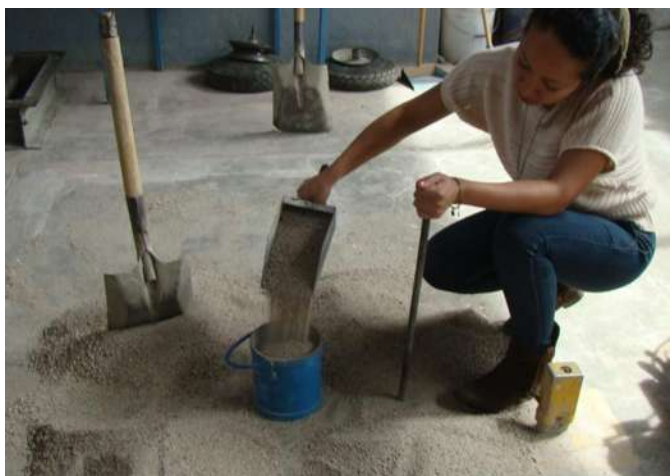
Figura 2.9 Varillado de la arena en la prueba de MVSV
