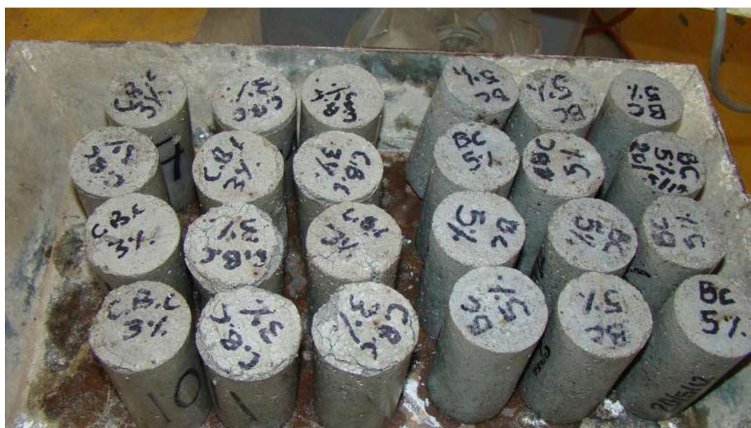
Figura 5.18 Especímenes de CBC 3 y 5% después del primer ciclo.
