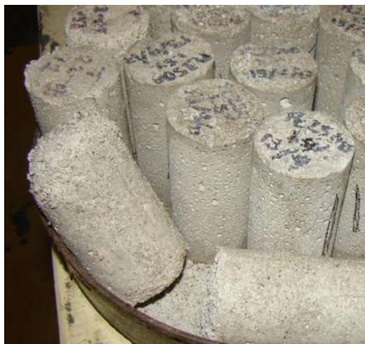
Figura 5.15 Especímenes cilíndricos con aditivo Sika Viscocrete PC 2500 después del quinto ciclo de la prueba de ataque por sulfatos.
