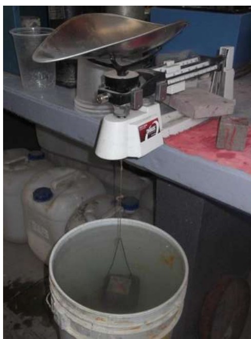
Figura 5.4 Determinación de la gravedad específica.
