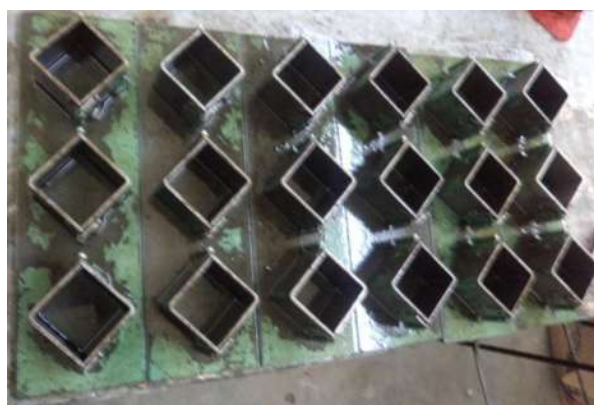
Figura 4.6 Moldes para cubos con desmoldante.
