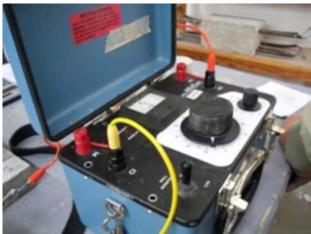
Figura 5.2 Equipo utilizado para determinar la resistividad eléctrica.
