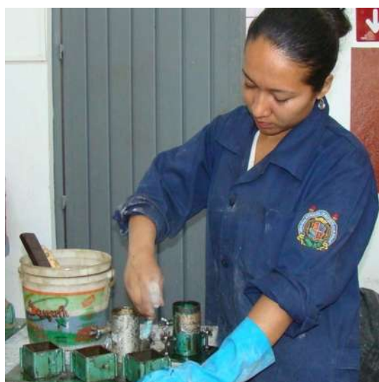
Figura 4.5 Aplicación de desmoldante.
