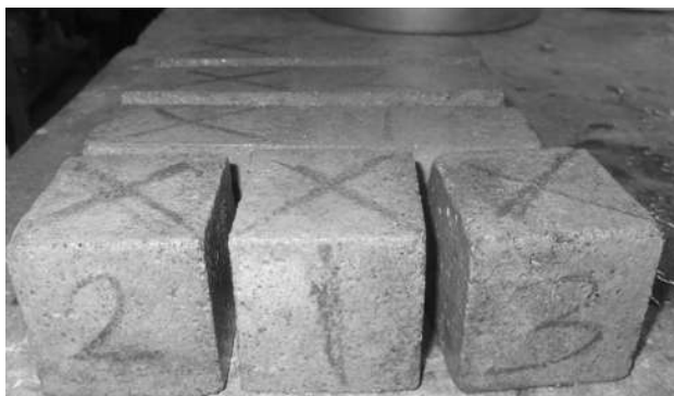
Figura 5 Especímenes cúbicos marcados antes de ser probados
