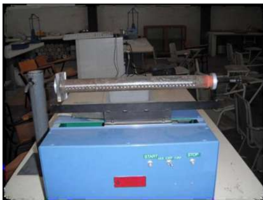
Figura 2.12 Máquina para prueba de Equivalente de arena.
