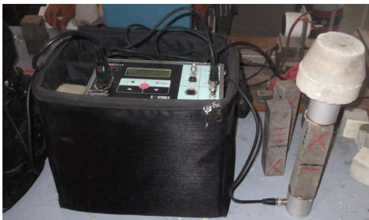
Figura 5.1 Equipo de velocidad de pulso ultrasónico.
