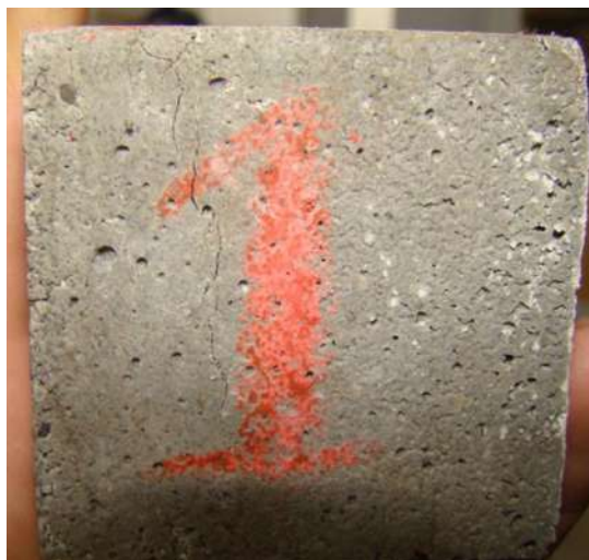
Figura 5.7 Espécimen cúbico después de someterse a carga y llegar a la falla.
