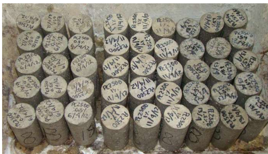
Figura 5.14 Especímenes cilíndricos con aditivo Sika ViscoCrete PC 2500 después del primer ciclo de la prueba de ataque por sulfatos.
