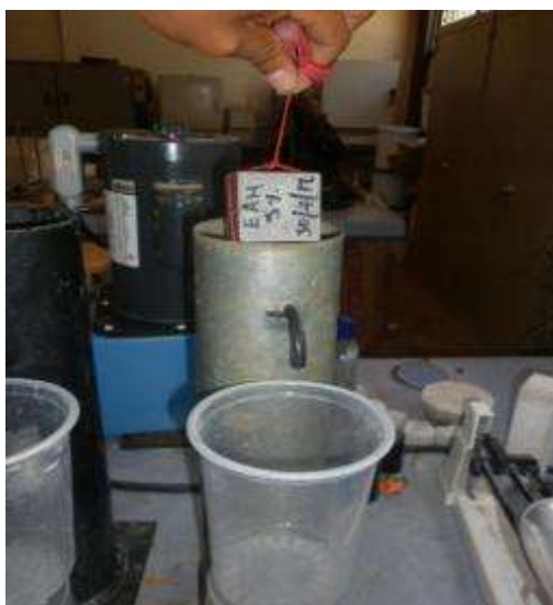
Figura 5.3 Determinación de la densidad de especímenes cúbicos.
