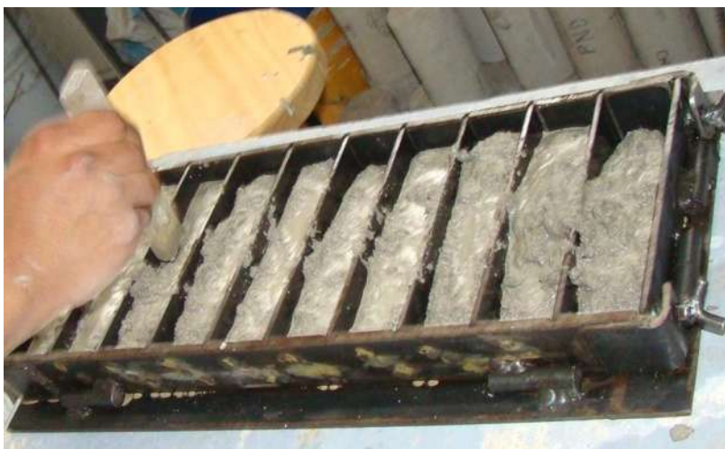
Figura 4.12 Llenado de moldes para elaboración de prismas.
