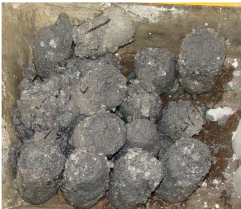
Figura 5.17 Especímenes CBC 7% después del primer ciclo.
