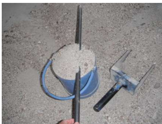
Figura 2.8 Equipo para realizar la prueba de MVSS.
