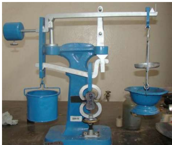
Figura 5.10 Máquina Michaelis para pruebas de tensión en morteros.
