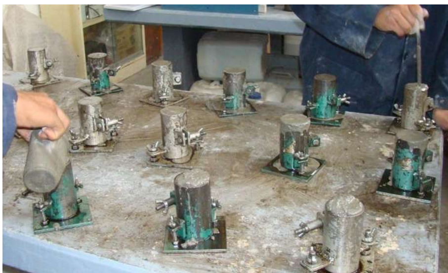
Figura 4.13 Llenado de moldes para elaboración de cilindros.
