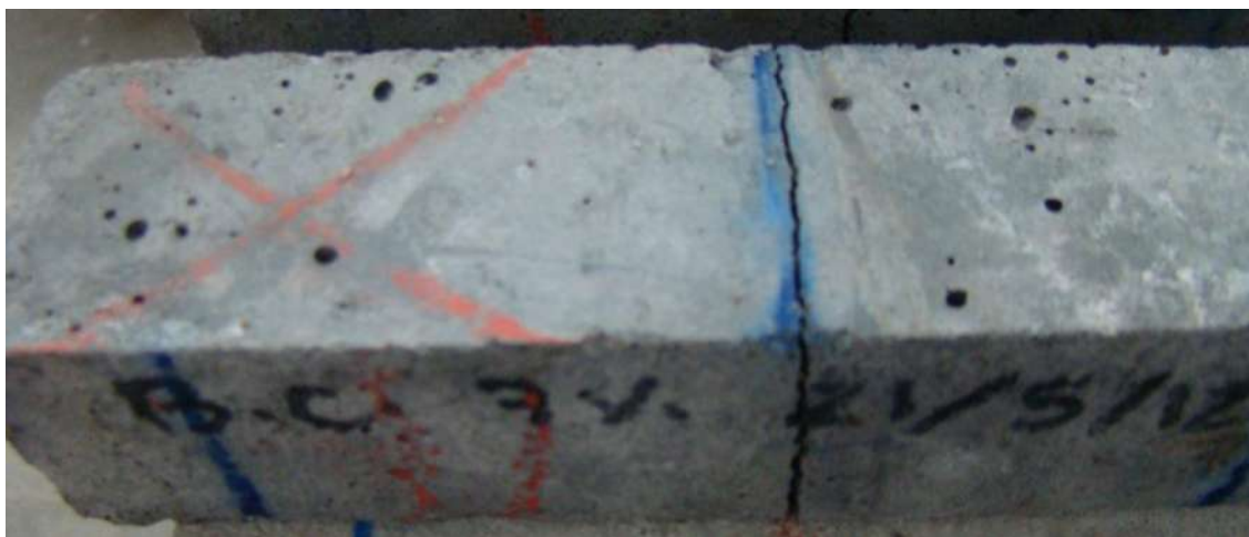
Figura 5.9 Prisma fallado al centro.
