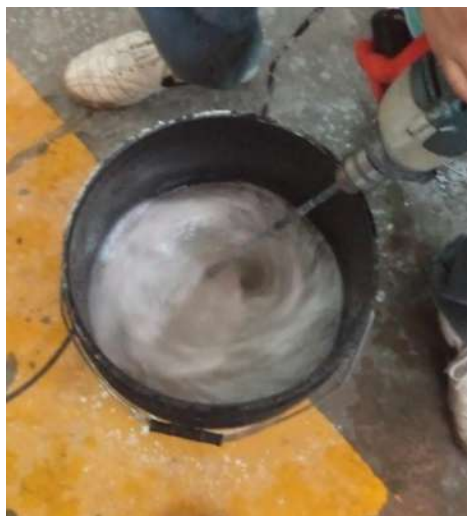
Figura 5.12 Preparación de solución saturada de sulfato de sodio.
