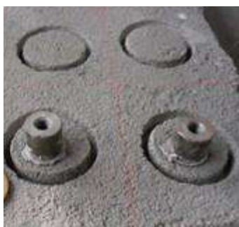
Figura 5.20 Dollys listos para realizar la prueba de adherencia.
