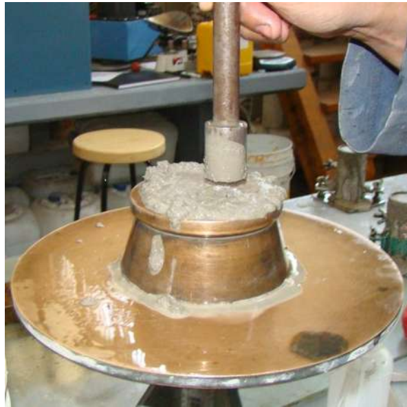
Figura 4.1 Apisonado del molde tronconico para prueba de fluidez.
