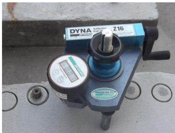
Figura 3.6 Equipo Pull Off para prueba de Adherencia.
