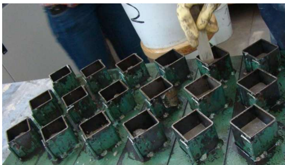
Figura 4.8 Llenado y apisonado de los moldes para la elaboración de cubos.
