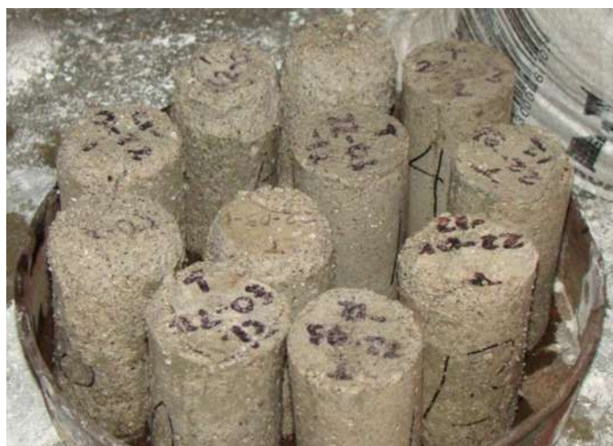
5.16 Especímenes testigos después del primer ciclo.
