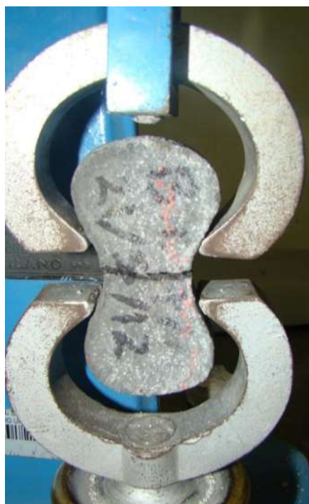
Figura 5.11 Briqueta después de la falla
