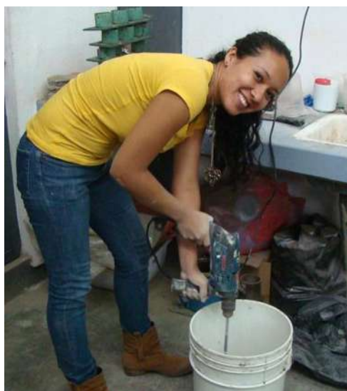
Figura 4.4 Elaboración de mezcla de mortero.
