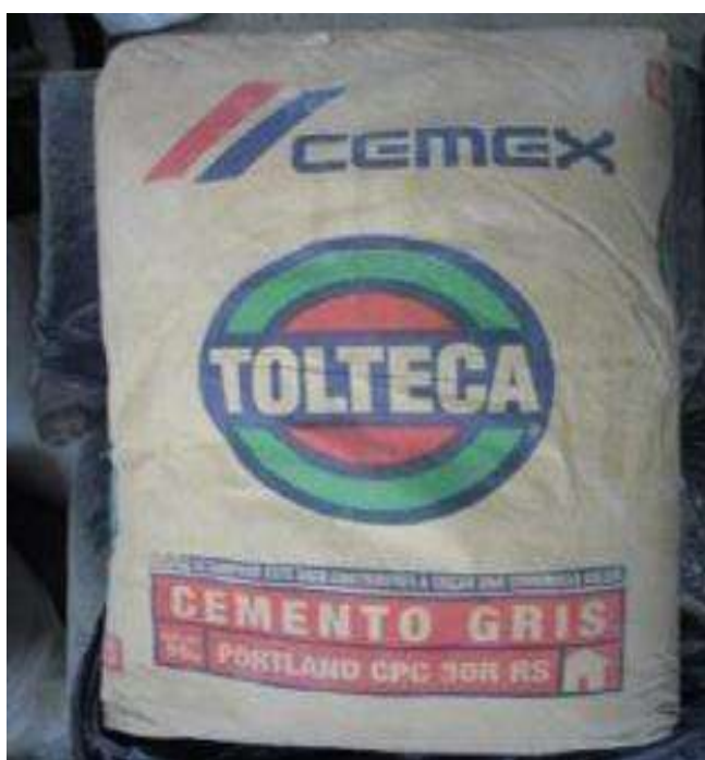
Figura 2.3 Cemento gris CPC 30R RS Utilizado para la elaboración de los morteros.
