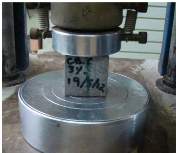
Figura 5.6 Prueba de compresión en espécimen cúbico.
