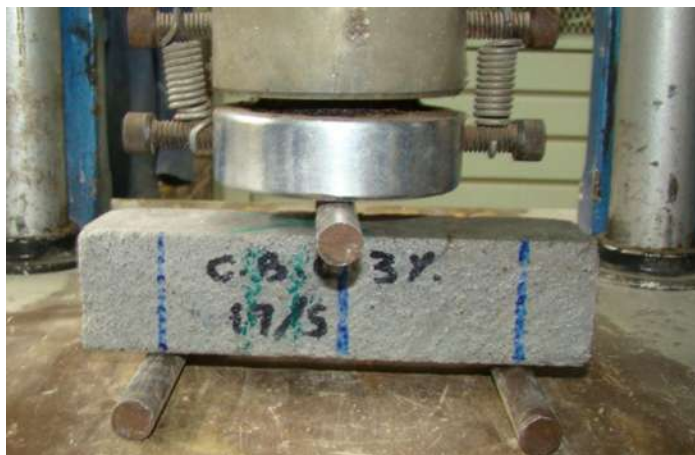
Figura 5.8 Prisma para prueba a flexión.
