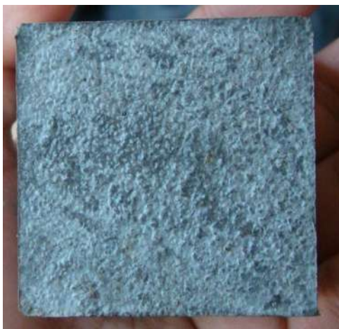
Figura 4.10 Cubo ya fraguado y descimbrado.
