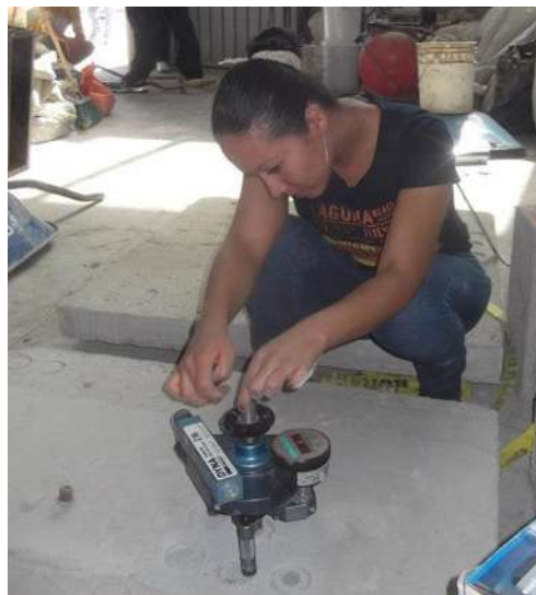
Figura 5.22. Realización de la prueba de adherencia, mediante el equipo de Pull Off.
