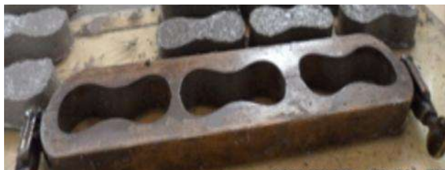
Figura 4.14 Molde para elaboración de briquetas.
