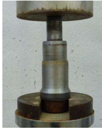
Figura 4.26 Extracción del espécimen, con la ayuda de la prensa.
