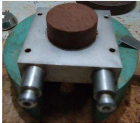
Figura 4.28 Reducción del diámetro del espécimen con ayuda de la caja de corte.
