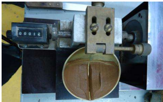
Figura 4.7 Material probado en la copa de Casagrande.
