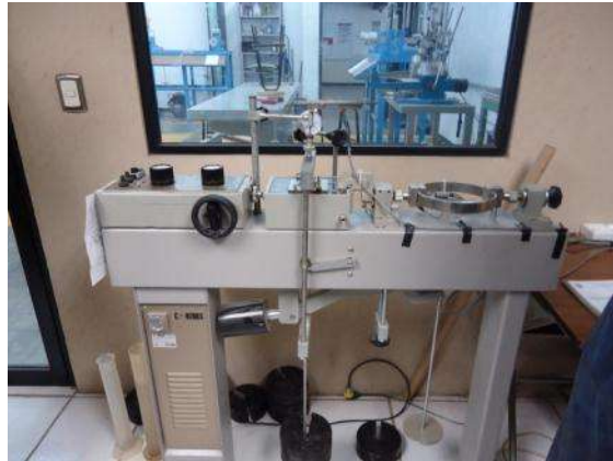
Figura 4.34 Equipo trabajando en la consolidación.
