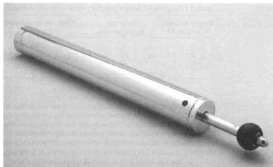
Figura 3.7 Pisón utilizando para la prueba Proctor Modificada.
