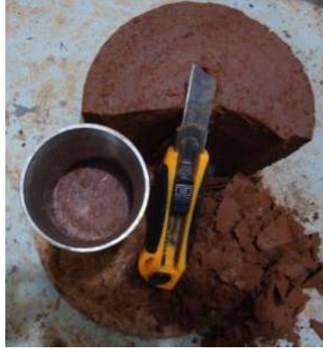
Figura 4.24 Anillo que se diseñó para facilitar el labrado de muestras.
