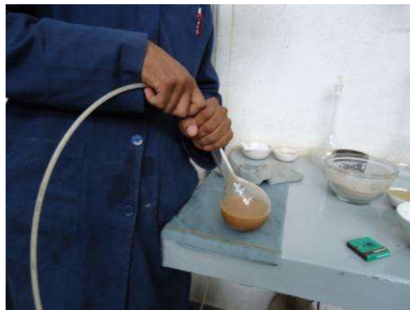
Figura 4.17 Aplicación de vacío en el matraz.
