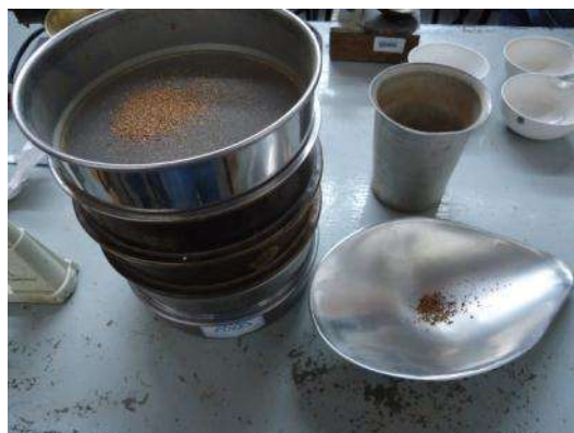
Figura 4.4 Tamizado del material.
