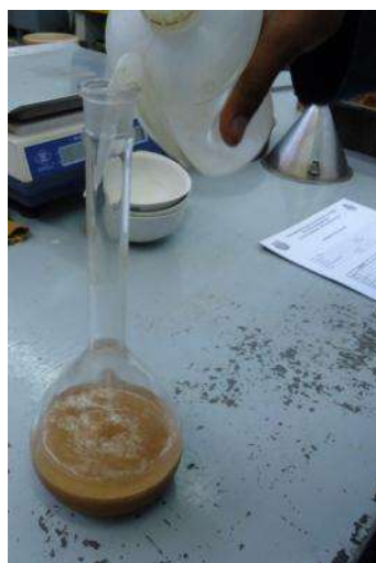
Figura 4.15 Colocación de muestra y agua destilada en el matraz.
