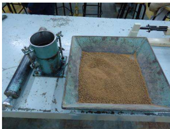
Figura 4.12 Material preparado para la prueba Proctor Estándar.
