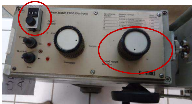
Figura 4.36 Colocación de la velocidad en el equipo.
