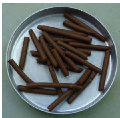
Figura 4.10 Rollitos para determinar el Límite Plástico.
