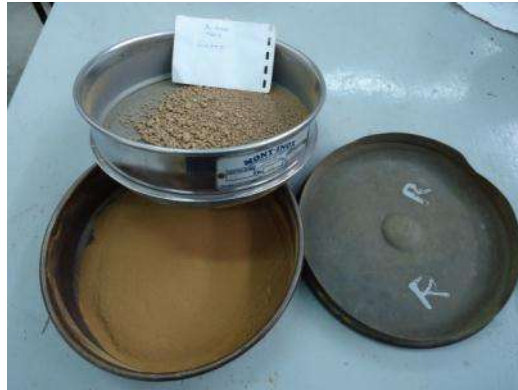
Figura 4.5 Preparación del material para determinar los Límites de Consistencia.
