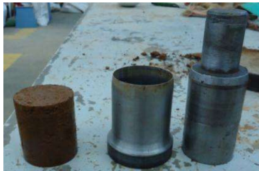
Figura 4.27 Especimen extraído e instrumentos utilizados.
