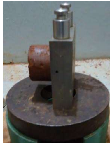
Figura 4.29 Cortado del espécimen, mostrando la caja metálica.
