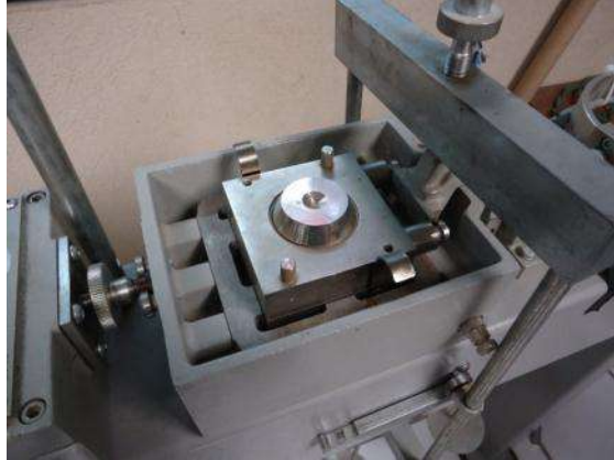
Figura 4.32 Colocación de la caja de corte directo en el equipo.
