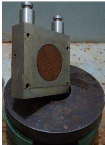
Figura 4.29 Cortado del espécimen, mostrando la caja metálica.
