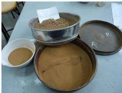
Figura 4.14 Cribado del material para determinar el peso específico relativo de los sólidos.
