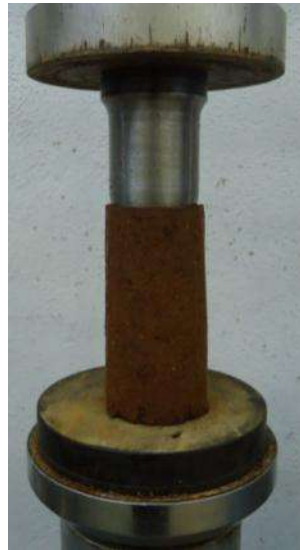
Figura 4.25 Labrado del espécimen con ayuda del anillo y la prensa.
