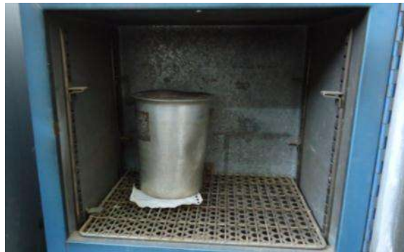
Figura 4.3 Secado del material producto del lavado.
