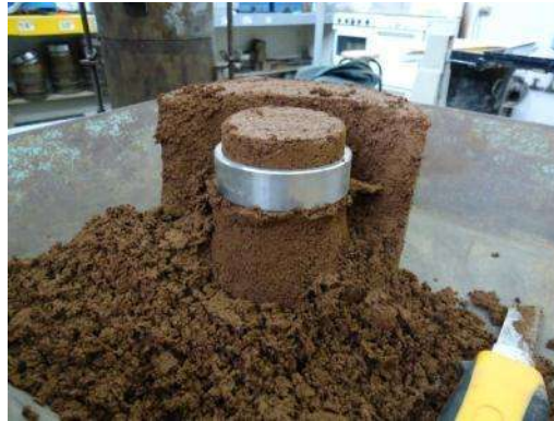
Figura 4.18 Labrado del espécimen para consolidación.
