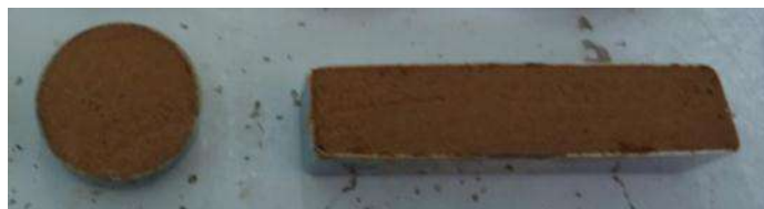
Figura 4.9 Cápsulas para determinar los Límites de Contracción Volumétrica y Lineal.
