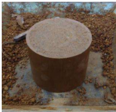
Figura 4.22 Remoldeada destinada a prueba de corte directo.
