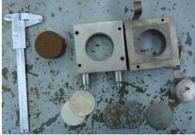
Figura 4.30 Partes que integran la caja de corte directo.
