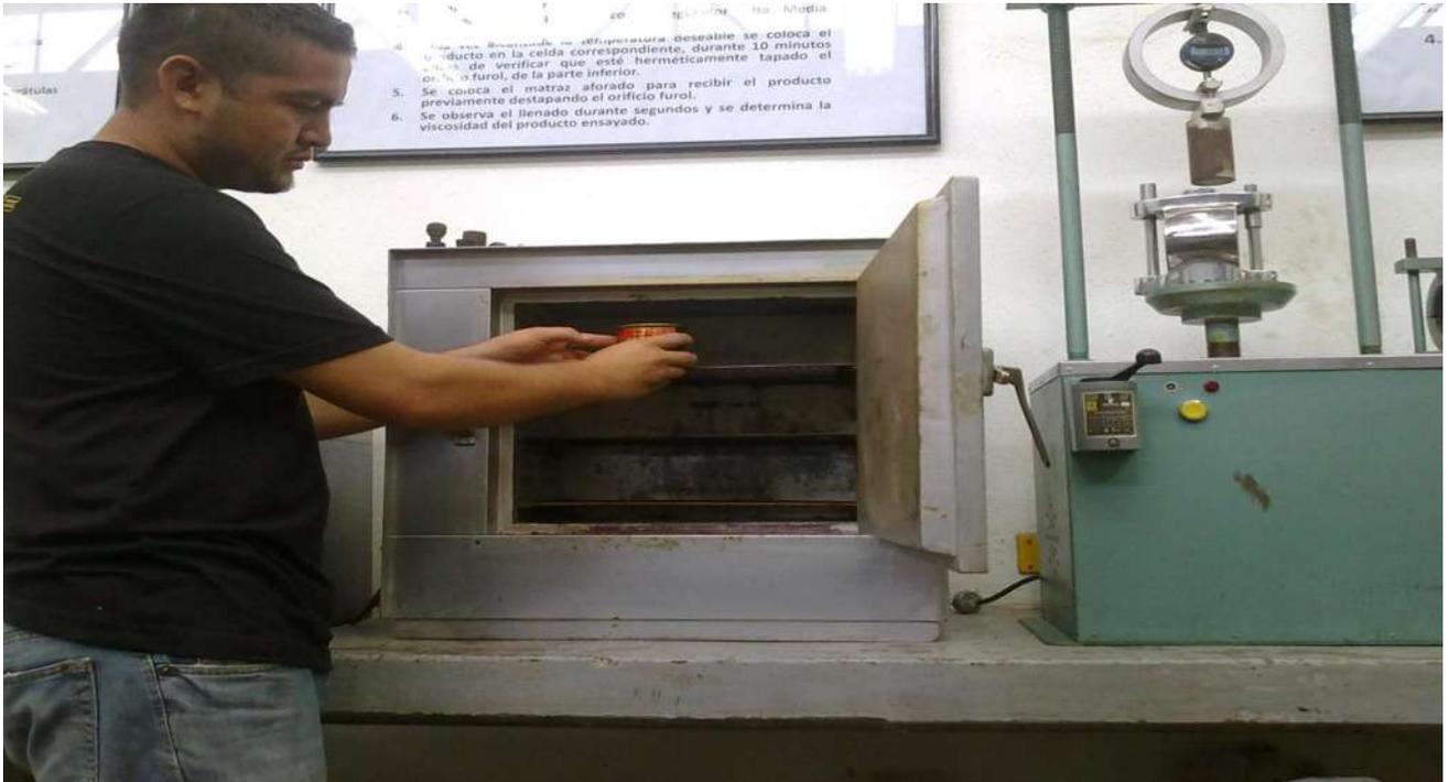
Figura 225. En las figuras 25 y 26, se muestra la colocación de las mallas en el horno a una temperatura de  $105^{\circ}\text{C}$ , para su secado durante dos hrs, acorde a las normas y manuales de la SCT.
