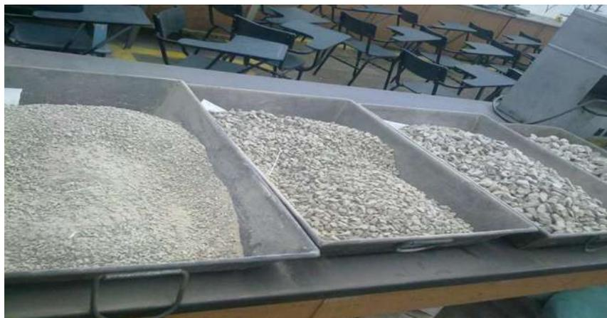
Fig.5 como se muestra en la figura el material mostrado es el material retenido en cada una de las mallas para obtener los diferentes tamaños de las partículas acorde a las normas de la SCT.
