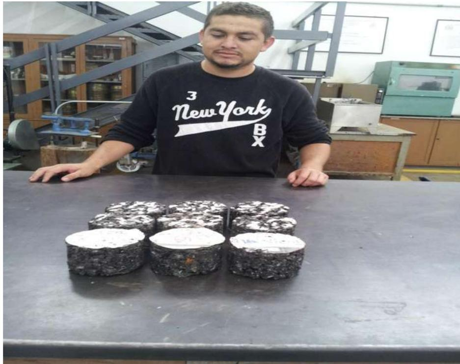
Figura 44. En la imagen se aprecian las pastillas que sufrieron una deformación ya una vez aplicada la carga con la maquina Marshall y a compresión simple.
