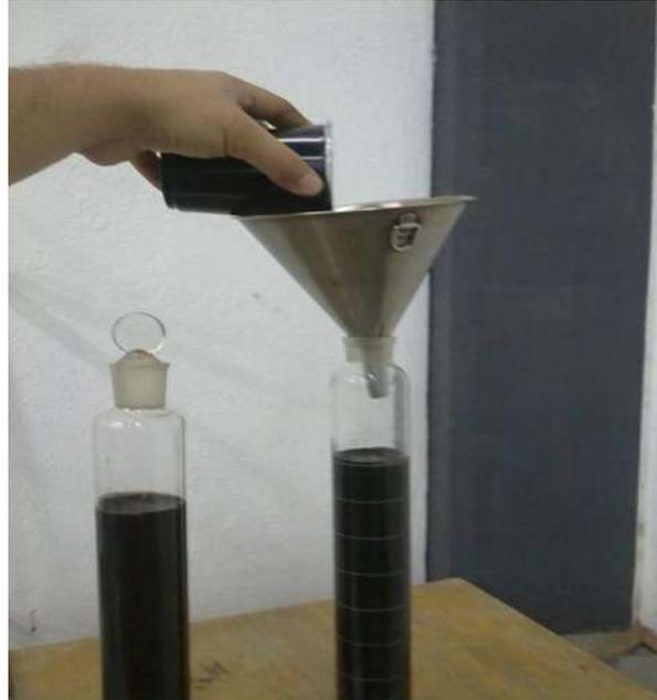
**Figura 18.** Se muestra el llenado de las probetas para dejarlas en reposo por un periodo de 5 días.
