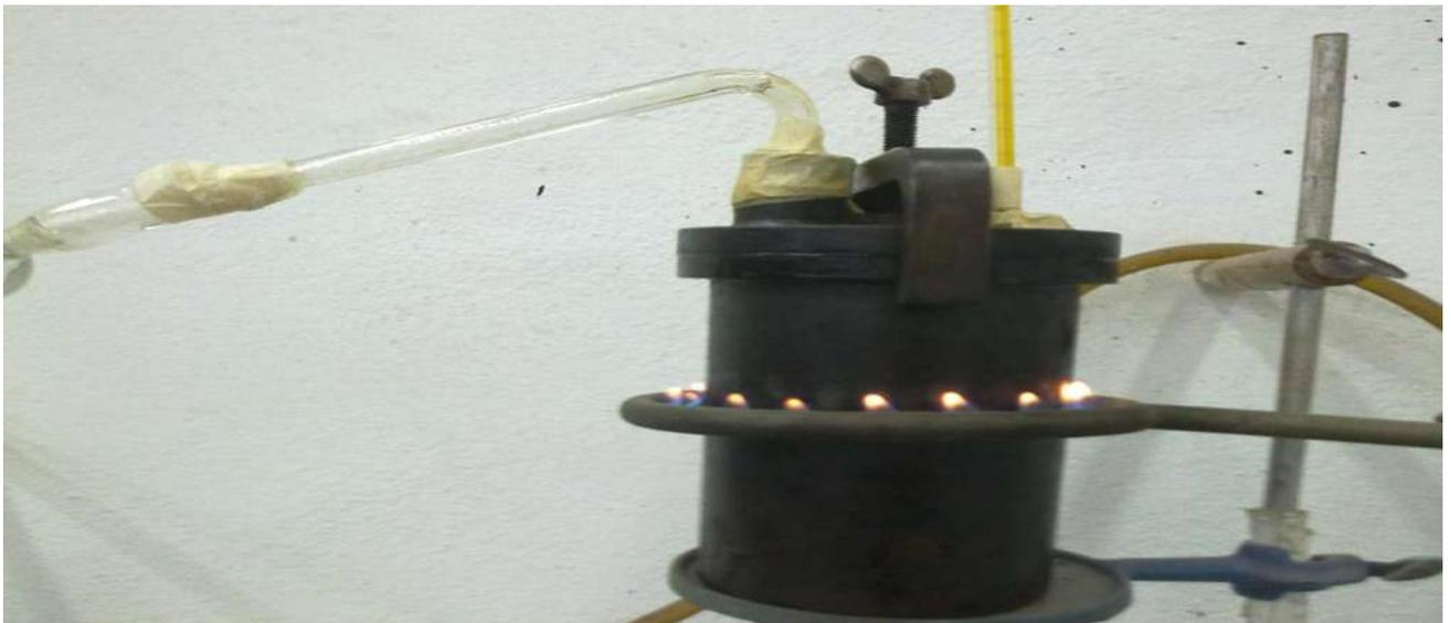
Figura 30. En la imagen se muestra que al alambique se le aplica calor para elevar su temperatura y lograr la destilación de la emulsión.
