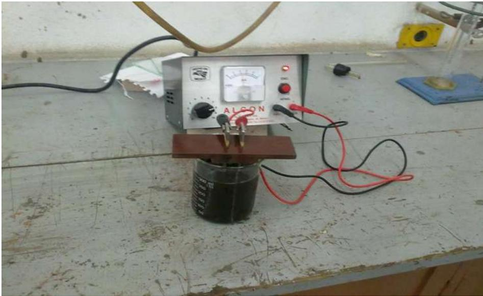
Figura 21. En la imagen se aprecia que los electrodos son sumergidos 25 mm en la emulsión sin que estos toquen las paredes o el fondo del recipiente.
