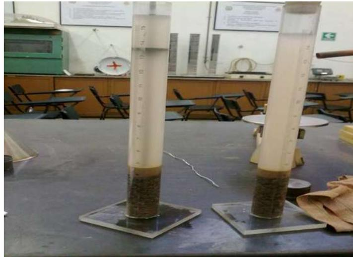
**Fig. 10** después de agitar el material 90 ciclos, y transcurrido el tiempo de reposo se introduce el pistón y se toma la lectura de los diferentes niveles para la sust. En la formula.
