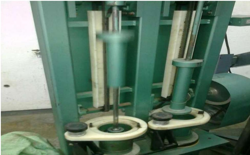
Figura 40. En la imagen se muestra como el pistón se encuentra en movimiento para la compactación de 75 golpes por cara, de la muestra.
