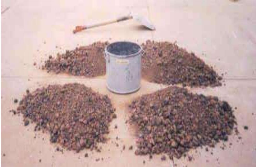
**fig. 3,** en esta figura se muestra el material en el recipiente para su respectiva prueba PVSS, así como el cuarteo del material y se toman dos extremos para el llenado del recipiente.
