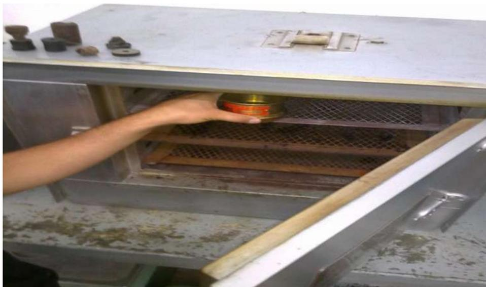
Figura 24. Colocación de las mallas con el retenido para secado.
