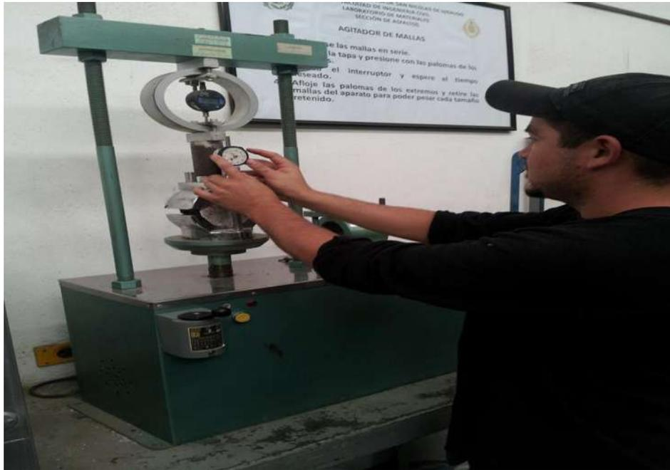
Figura 42. En la imagen se aprecia la colocación de las pastillas dentro de la maquina a compresión Marshall.
