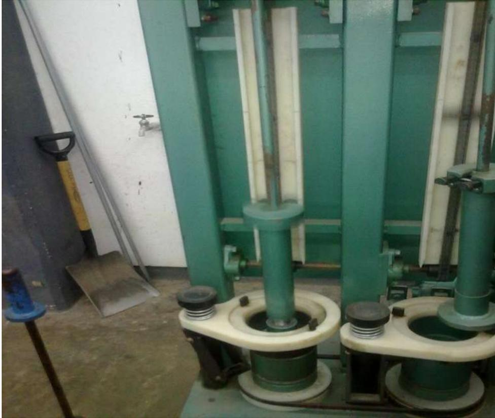
Figura 39. En la imagen se puede apreciar el molde, collarín y la base, así como el pistón deslizante de compactación.
