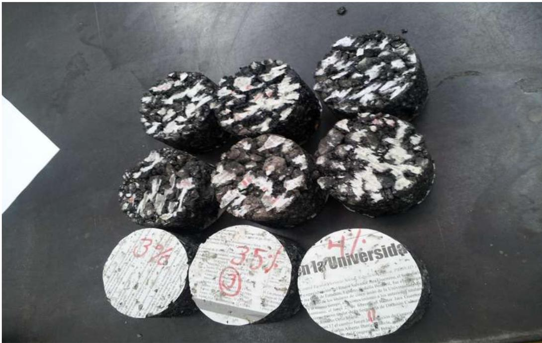
Figura 41. En la imagen se aprecian las 9 pastillas que se realizaron para el estudio mediante los porcentajes de emulsión en estudio.
