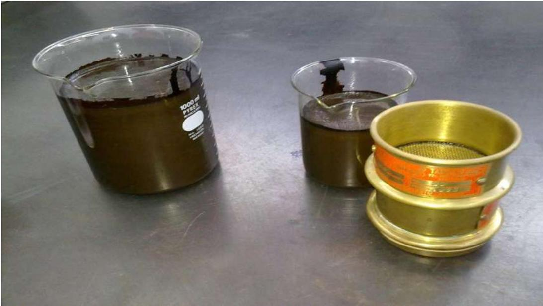
Figura 23. En la imagen se muestra la emulsión y las mallas No. 20 y No 60, para realizar el respectivo retenido de las mallas mencionadas.
