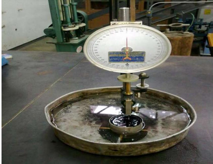
Figura 15. En la imagen se muestra el aparato para realizar la prueba de penetración así como la muestra en la capsula, la cual está en un recipiente con agua, sin que el agua afecte la muestra para mantenerse a 25<sup>0</sup> C.
