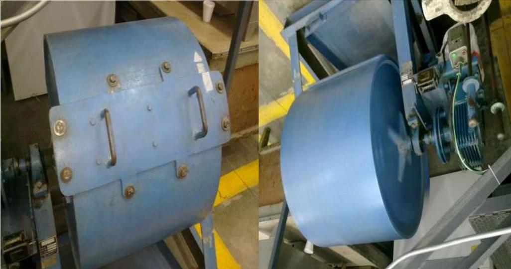
**Fig. 13** en la imagen se muestra tanto la máquina de desgaste, como la misma pero esta ya encendida para completar sus ciclos según los requerimientos de la tabla 4. Acorde a las normas de la SCT.
