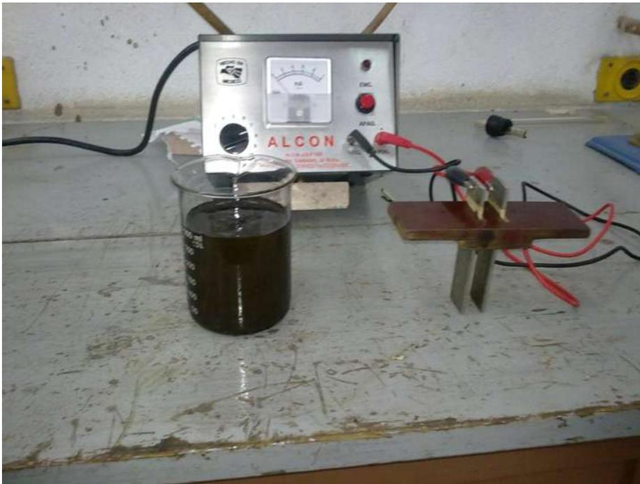
**Figura 20.** En la imagen se aprecia la muestra, la fuente de poder y los electrodos positivo y negativo.
