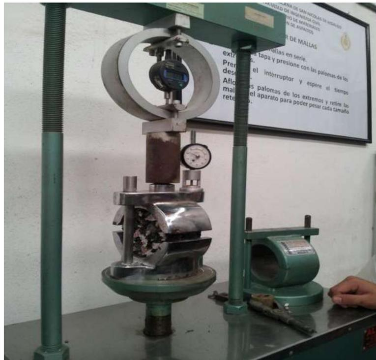
Figura 43. En la imagen se muestra la máquina de compresión Marshall, y la deformidad que adquieren las pastillas en la aplicación de carga de esta máquina.
