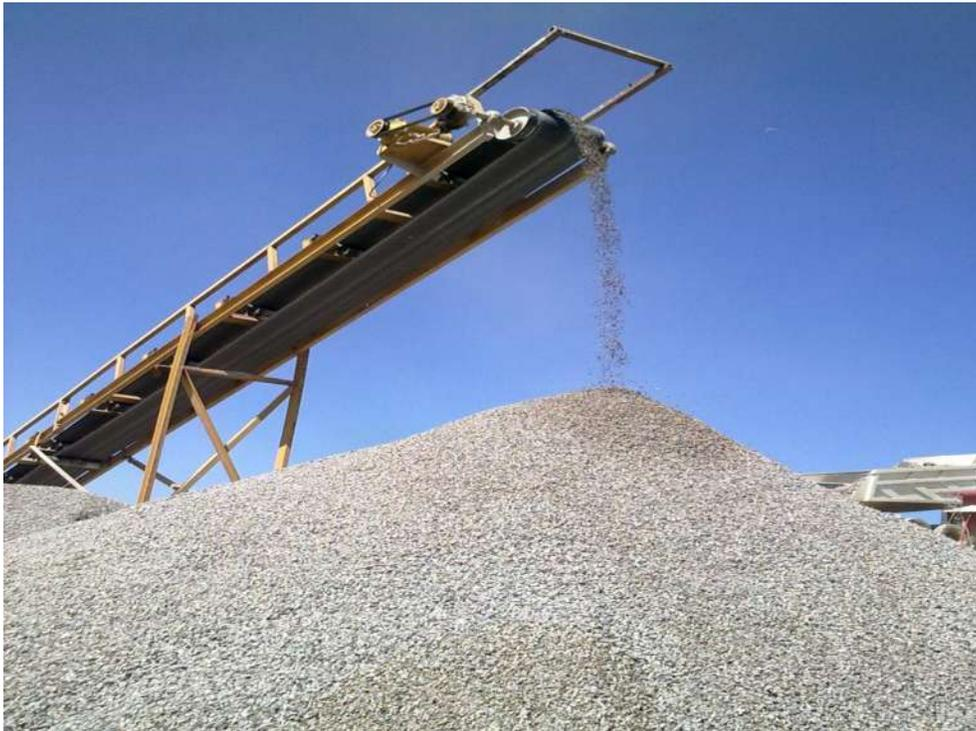
**Figura 1.1.** En la imagen se aprecia el basalto ya sometido a trituración, resultado de bloques de mayor espesor trituradas y cribadas.
