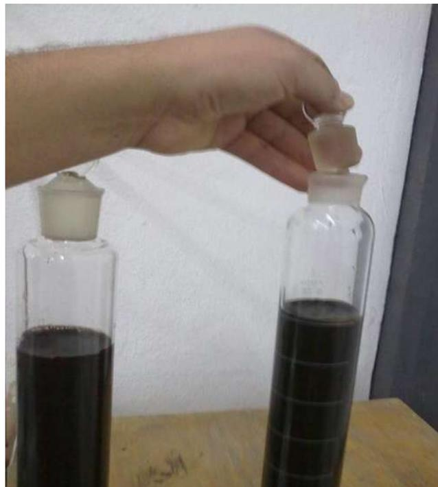
**Figura 19.** En la imagen se muestra que las probetas tienen que taparse ya sea con tapón de vidrio o corcho, y dejarlas reposar un periodo de 5 días sin que estas sufran un movimiento. Ni se cambien de lugar.
