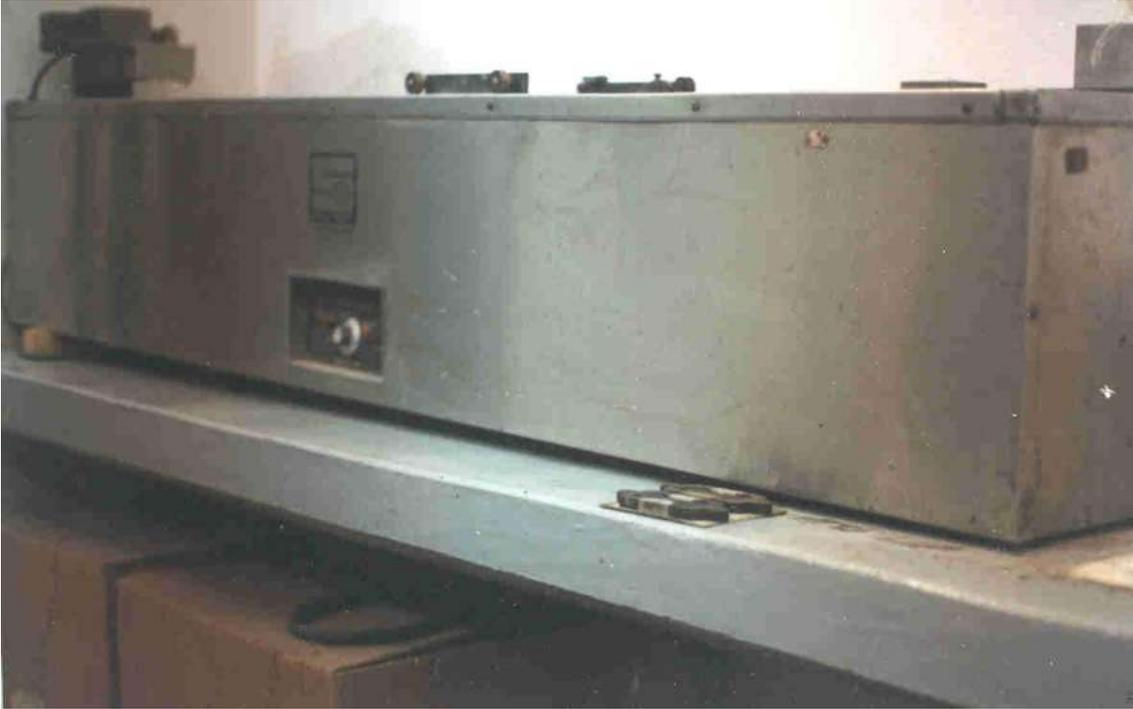
**Figura 33.** En la imagen anterior se muestra la máquina para realizar la prueba de ductilidad de un cemento asfáltico.
