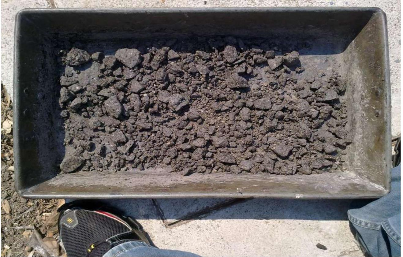
Figura 36. En la imagen se muestra el material pétreo con la emulsión asfáltica, la mezcla se encuentra secándose directamente al sol, en charola de lámina.
