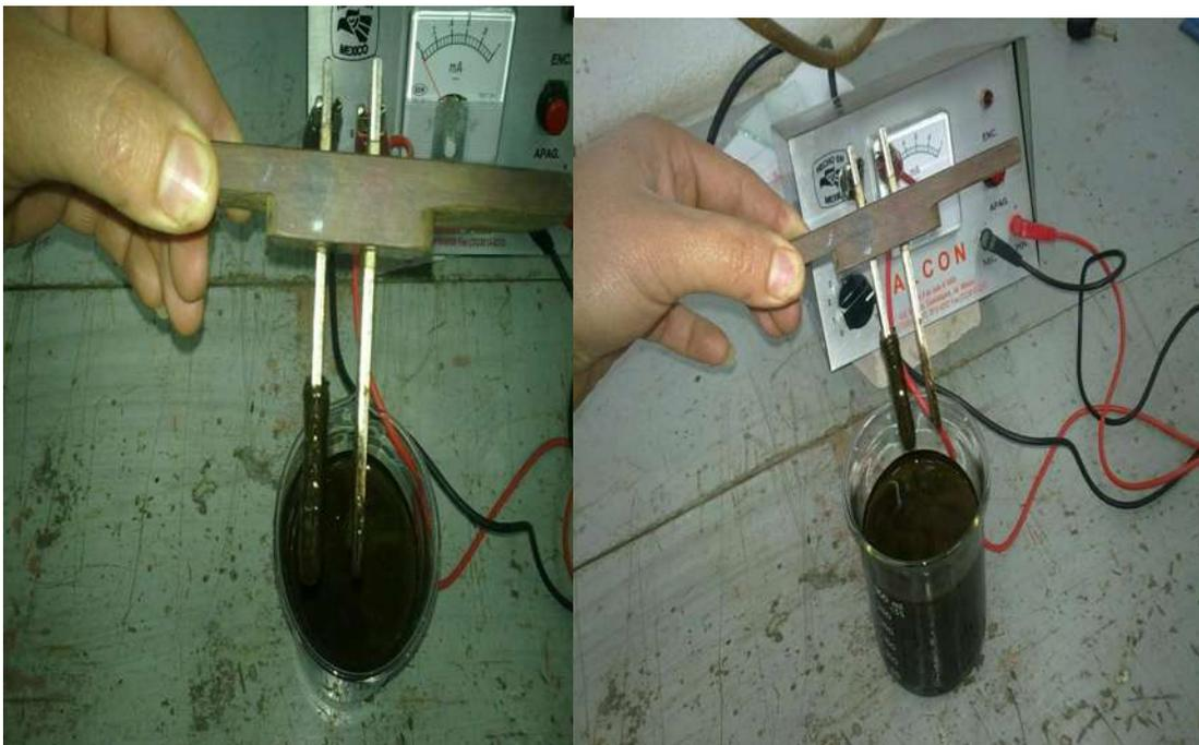
Figura 22. En la imagen se muestra como los glóbulos de la emulsión son atraídos por la carga negativa por lo que se puede concluir que es una emulsión catiónica, por tener las partículas carga positiva.
