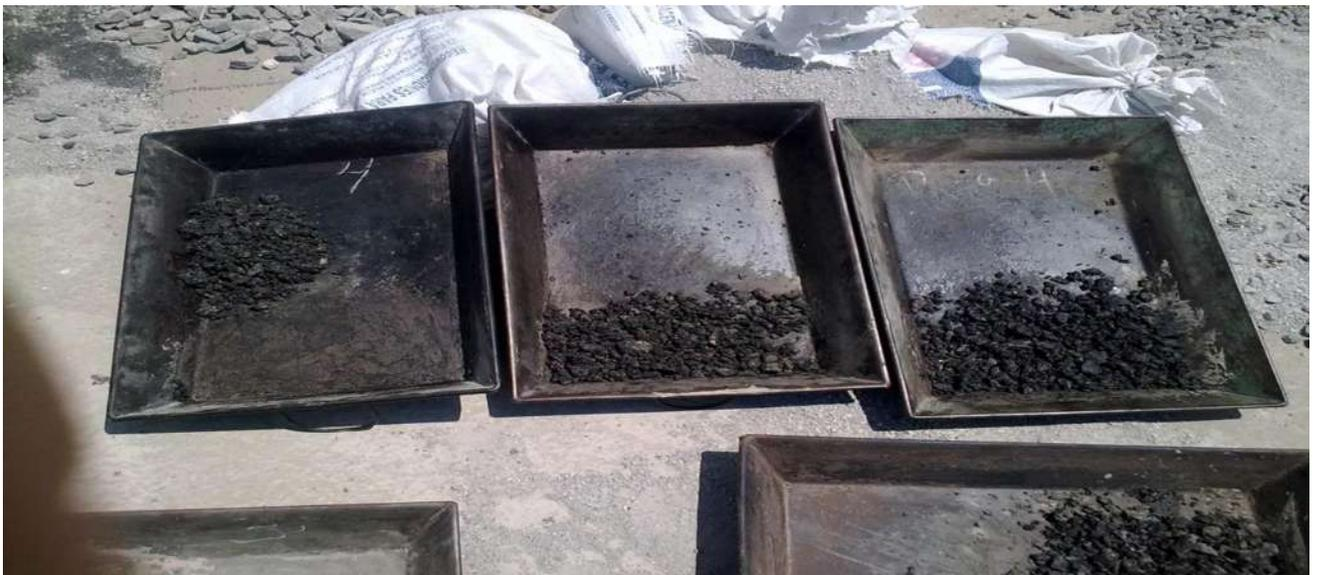
Figura 37. En la imagen se aprecia el secado del material para el 4 % de emulsión, en esta imagen todavía no se encuentra totalmente seca.
