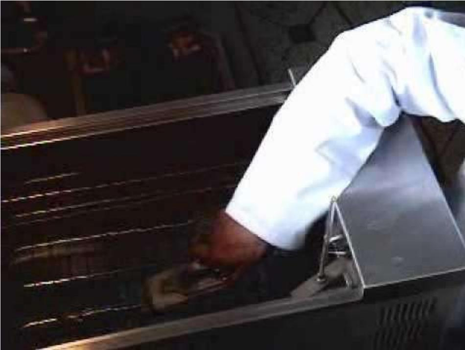
**Figura 34.** En la imagen se muestra la colocación de la briqueta en el ductilómetro.
