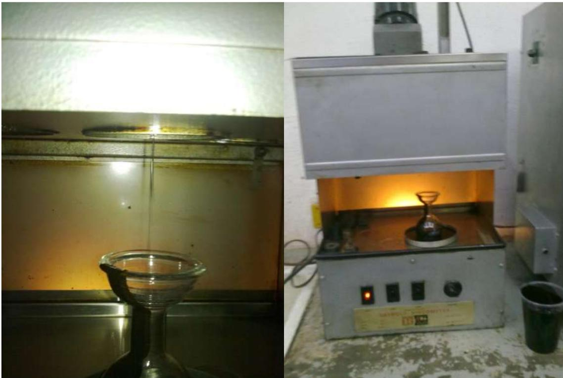
**FIGURA 14.** En la imagen se muestra la maquina que sirve para realizar la prueba de viscosidad saybolt-furol. Así como se puede apreciar como la emulsión ya calentada a los grados establecidos fluye de la maquina hacia el depósito de la misma.
