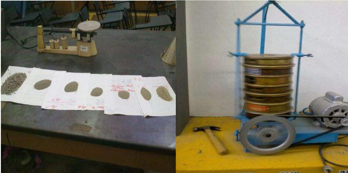
**Fig. 6.** En la imagen se muestra el material retenido por los diferentes tipos de mallas para finos, así como una báscula con aproximación al decimo de gr. Y al gramo. Así como la maquina agitadora.
