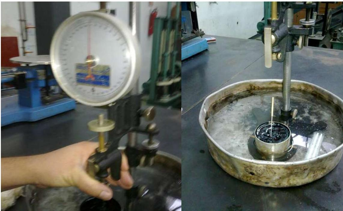
Figura 16. En las imágenes se aprecia al igual la máquina para realizar esta prueba así como la aguja que realiza la penetración en un lapso no mayor a 5 seg.
