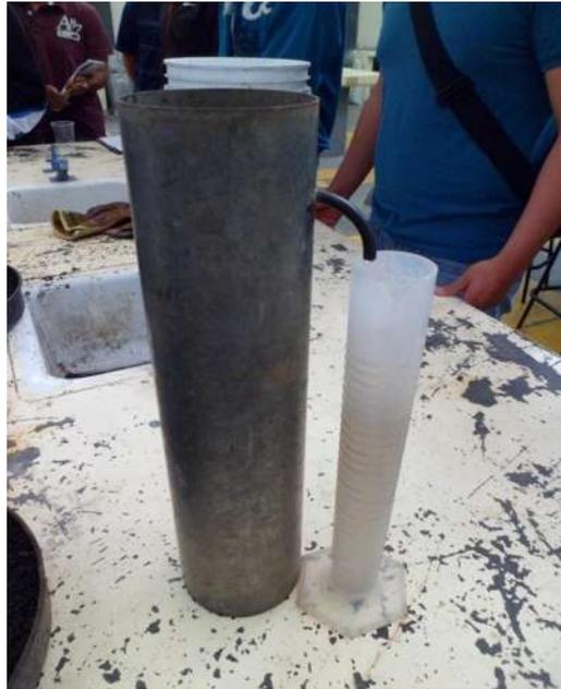
Figura 3.13 Calculo de la densidad de la grava por medio del picnómetro
