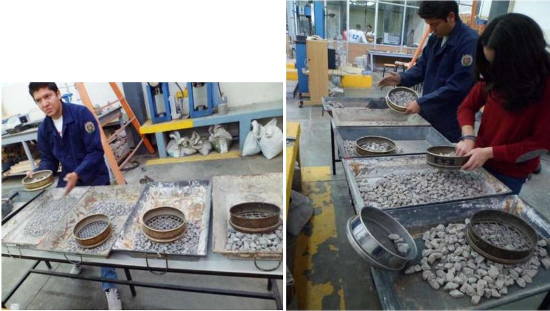
Figura 3.14 Cribado de la grava para determinar su granulometria y tamaño maximo nominal.
