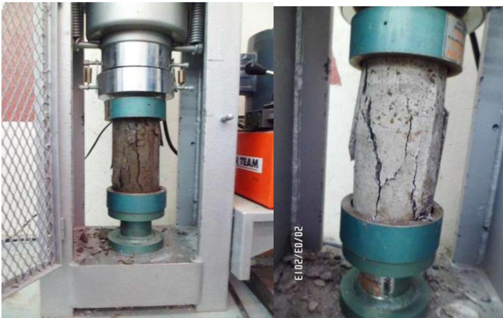
Figura 3.19 Prueba a compresión en cilindros de concreto
