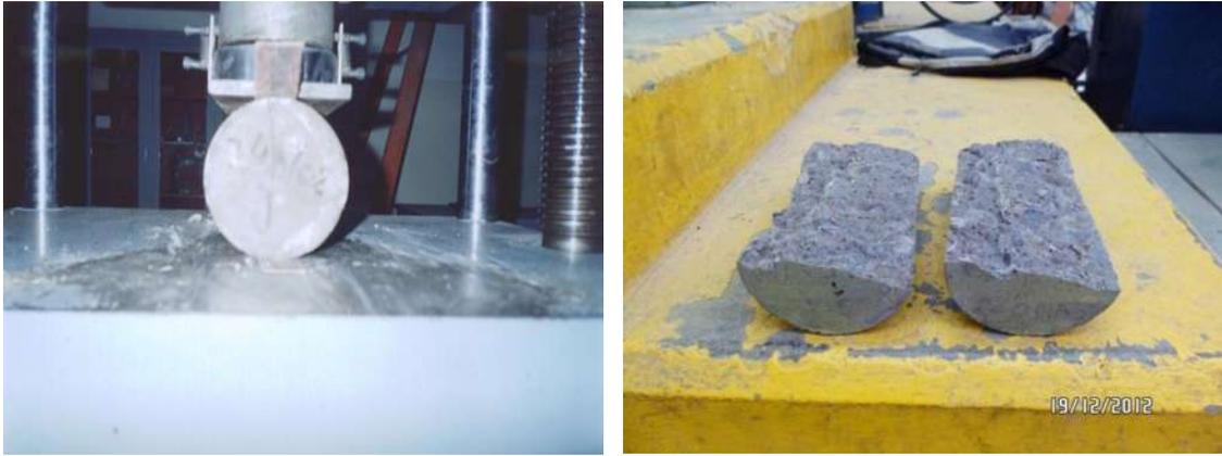
Figura 3.20 Prueba de tensión indirecta en cilindros de concreto.
