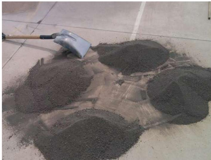
Figura 3.1 Cuarteo de arena por medio de palas
