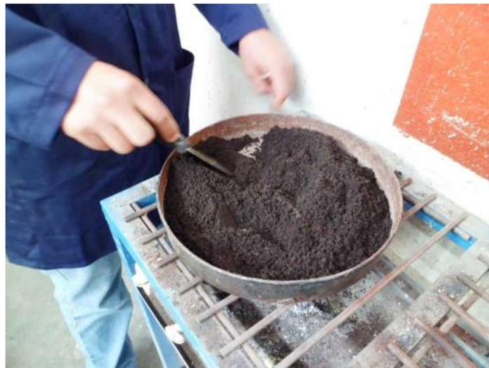
Figura 3.2 Determinación de la humedad actual en arenas
