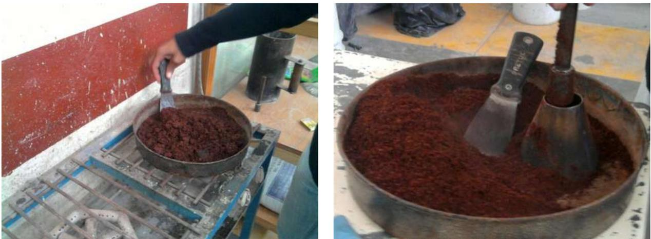
Figura 3.3 Determinación del porcentaje de absorción en arenas por medio del cono troncocónico
