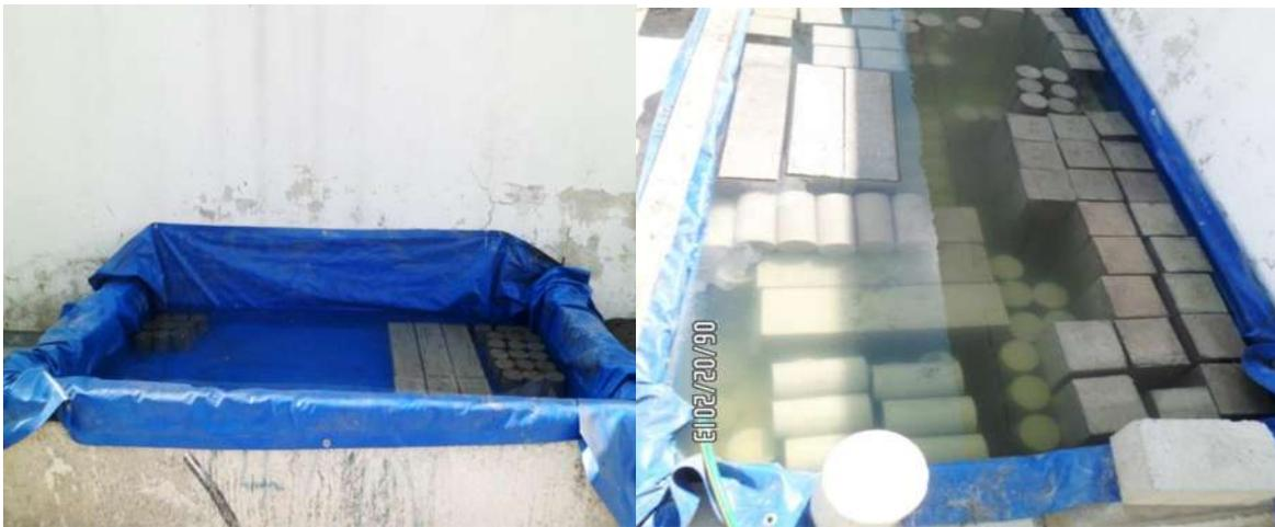
Figura 3.18 Pila de curado para los especímenes.
