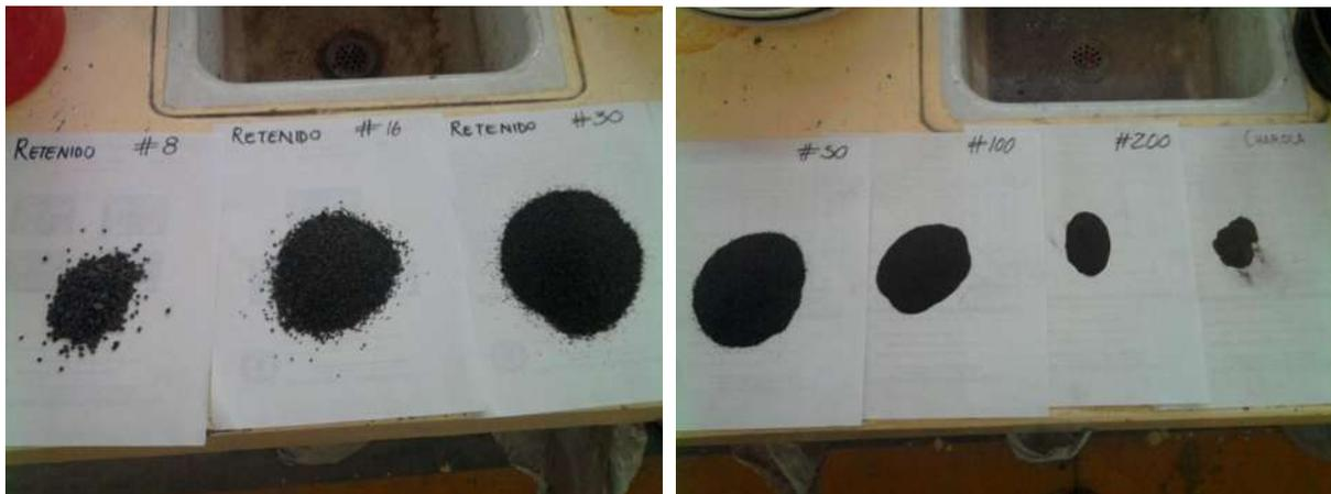
Figura 3.8 Separación granulométrica en las arenas
