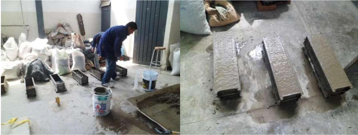
Figura 3.16 Elaboración de las vigas de concreto para determinar la flexión.
