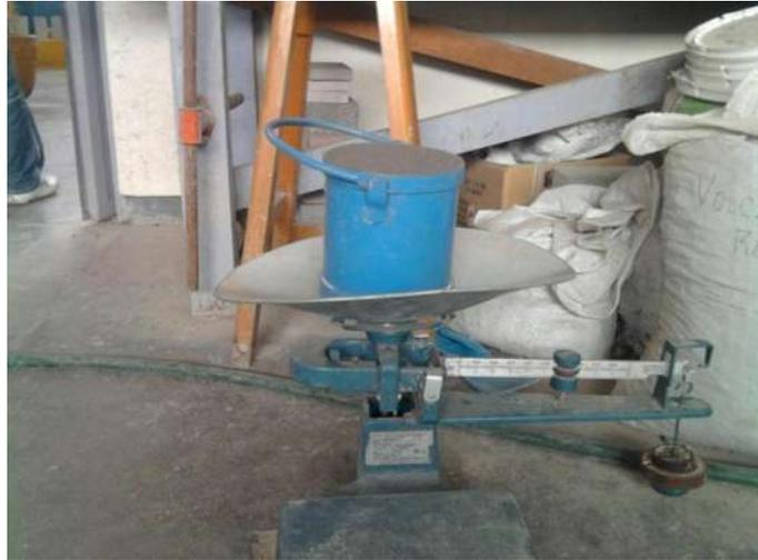
Figura 3.5 Cálculo del peso volumétrico seco suelto (P.V.S.S.) de la arena.
