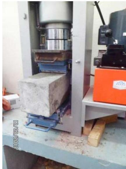
Figura 3.21 Prueba de flexión en vigas de concreto.
