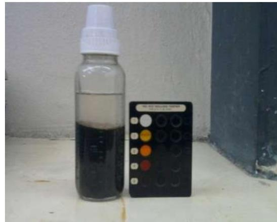
Figura 3.9 Ensayo de colorimetría en arenas
