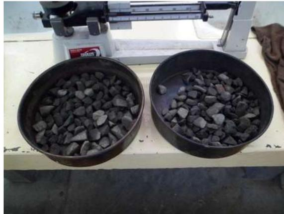
Figura 3.12 Muestras de grava para el cálculo de la humedad de absorción.
