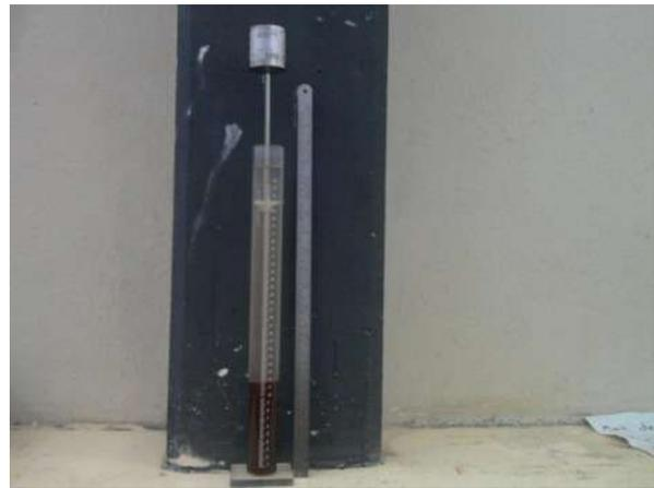
Figura 3.10 Determinación del equivalente de arena.
