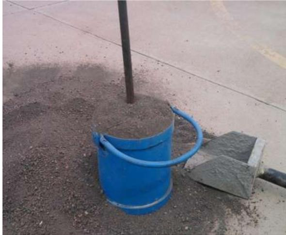
Figura 3.6 Cálculo del peso volumétrico seco varillado (P.V.S.V.) en arenas
