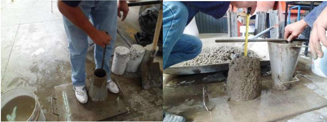
Figura 3.15 Obtención del revenimiento de las mezclas de concreto para los especímenes.
