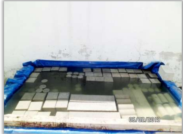
Figura 4.22. Curado posterior al desmolde de cilindros, pila de curado.
