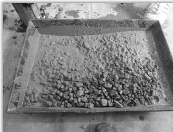
Figura 8.1. Ausencia de unión entre partículas.
