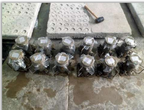
Figura 4.21. Utilización de plástico para evitar la pérdida de humedad en el concreto, durante las primeras 24 horas de fraguado.
