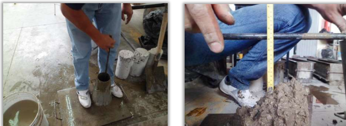
Figura 4.18. Procedimiento para determinar el revenimiento del concreto.
