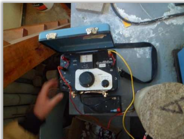
Figura 4.25. Resistómetro utilizado para la prueba de resistividad eléctrica.
