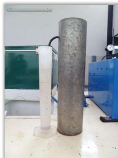
Figura 4.12. Determinación de la densidad de la arena.
