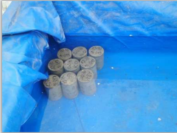
Figura 4.22. Curado posterior al desmolde de cilindros, pila de curado.
