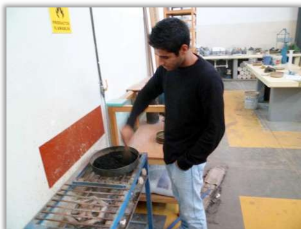
Figura 4.3. Secado del material para determinar el peso seco de la muestra.
