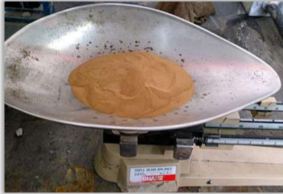
Figura 3.5 Aditivo superplastificante y reductor de agua CRISOTAN R-5.
