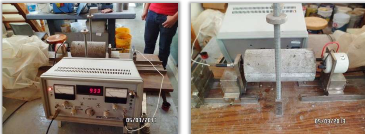
Figura 4.24. Sonómetro comercial para determinar frecuencias de resonancia.
