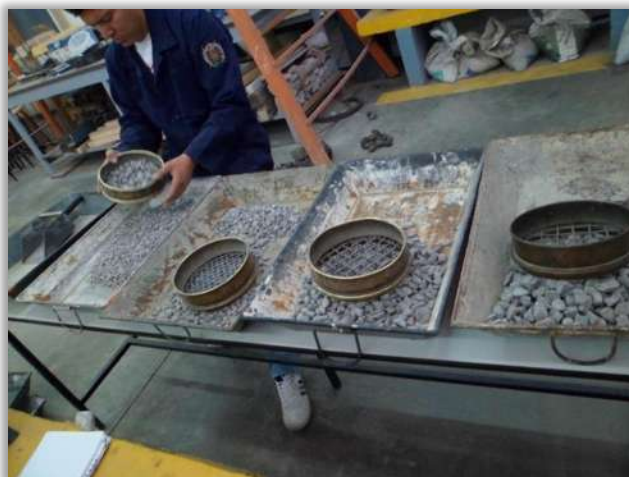
Figura 4.16. Separación de tamaños de la grava para determinar su granulometría.
