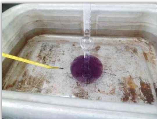
Figura 4.1 Densidad aparente del Cemento.
