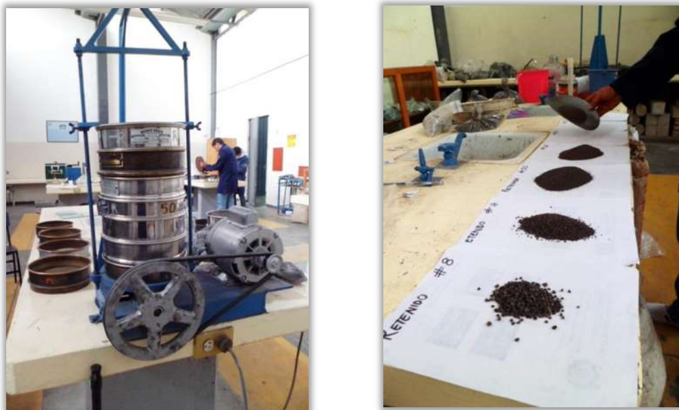
Figura 4.10. Separación de tamaños del material para determinar su granulometría.
