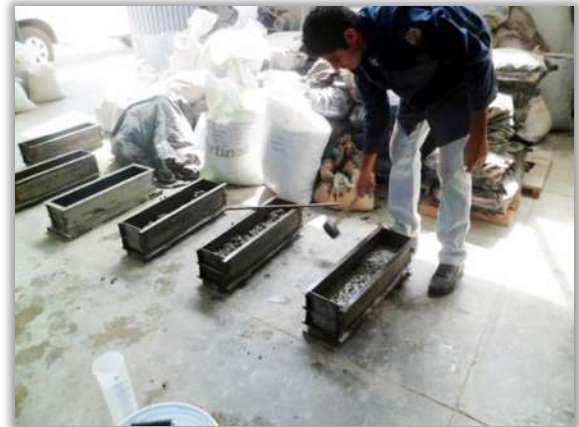
Figura 4.20. Procedimiento para la fabricación de vigas de prueba en concreto.
