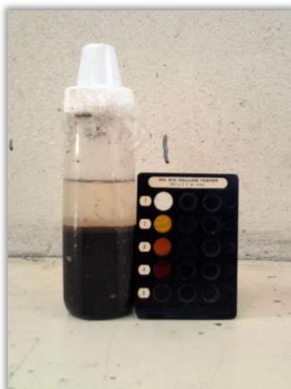
Figura 4.11. Comparación de color para establecer grado de colorimetría.
