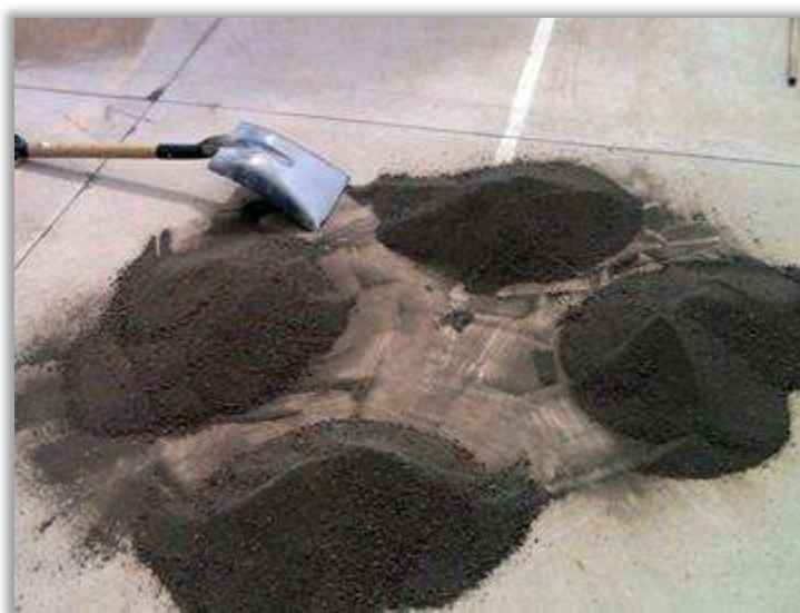
Figura 4.2 Cuarteo de arenas con palas.
