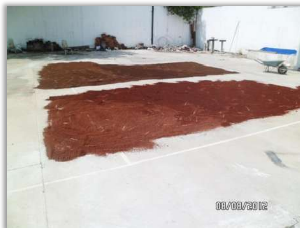
Figura 5.1. Secado para posterior almacenamiento de arenas.
