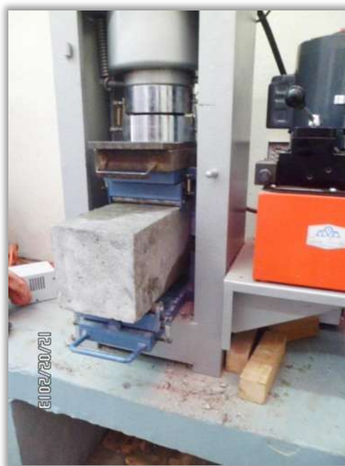
Figura 4.28. Viga de concreto instalada para ser probada por flexión.
