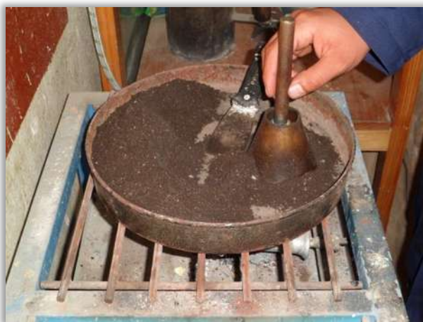
Figura 4.12. Determinación de la densidad de la arena.
