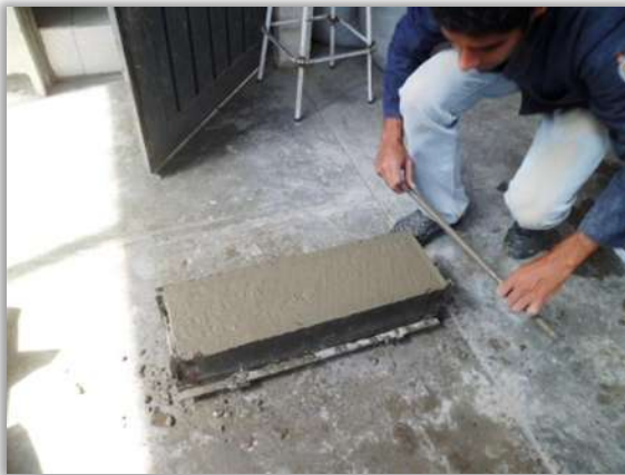
Figura 4.20. Procedimiento para la fabricación de vigas de prueba en concreto.
