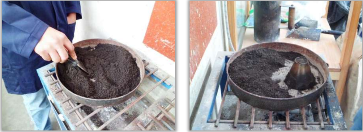
Figura 4.4. Determinación de la humedad de Absorción en arenas.
