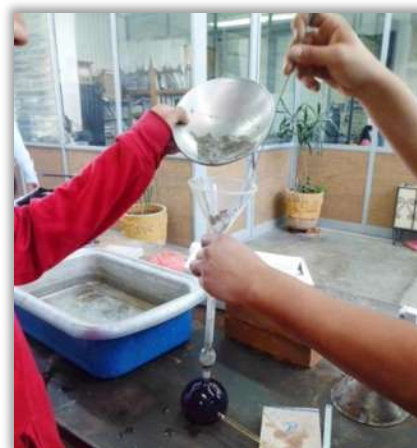
Figura 4.1 Densidad aparente del Cemento.
