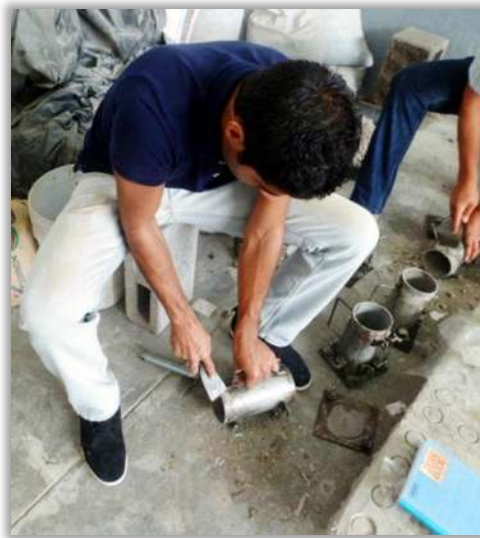
Figura 4.19. Preparamiento de moldes para cilindros de concreto.
