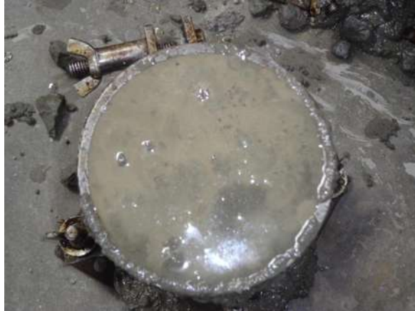
Figura no 5.19. Sangrado excesivo en las mezclas con aditivo.
