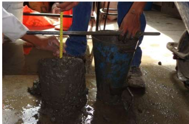
Figura no 5.18. Revenimiento de 14 cm de las mezclas de concreto.
