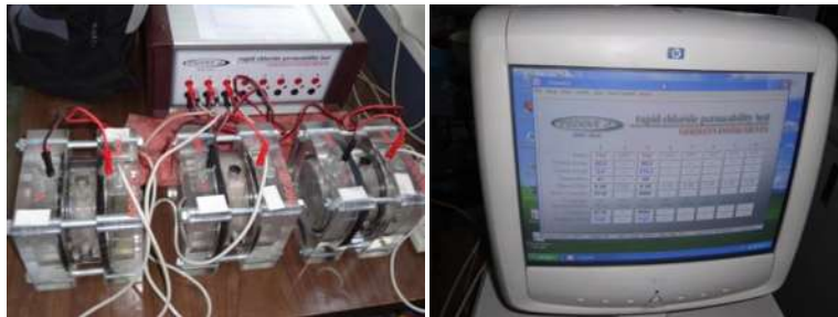
Figura no 6.1. Equipo empleado en la prueba permeabilidad rápida de cloruros (a la izquierda: celdas de cloruro y fuente de voltaje, derecha: dispositivo encargado de tomar las mediciones). [ASTM C-1202-97].
