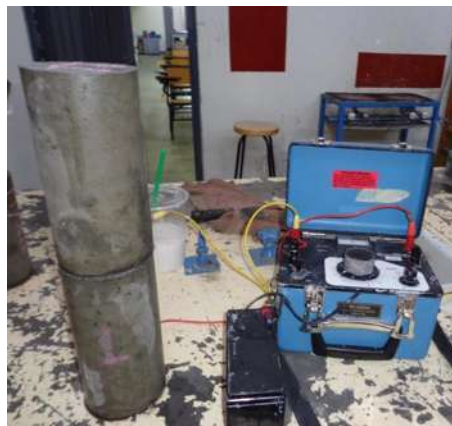
Figura no 6.15. Medición de la resistividad eléctrica en los cilindros de concreto.
