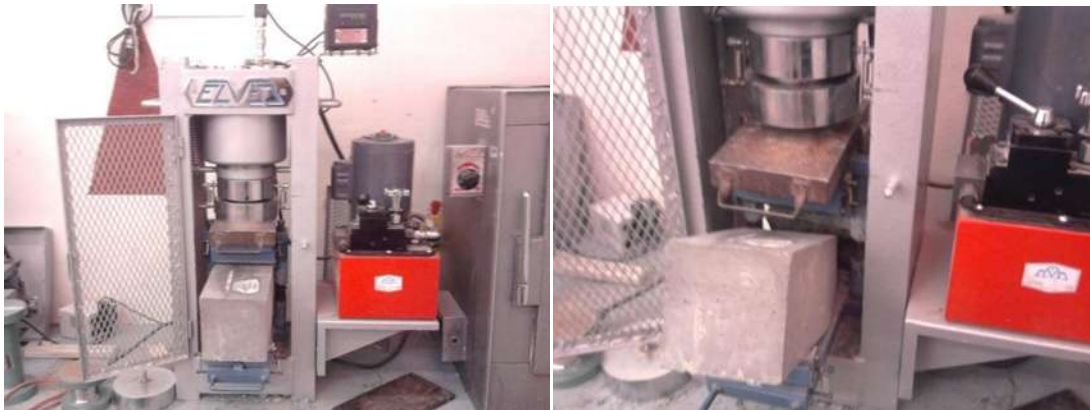
Figura no 6.16. Prueba de flexión en vigas de concreto.
