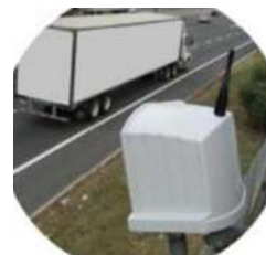
Contador por radar
