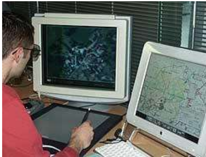
Estacion de restitución fotogrametrica
