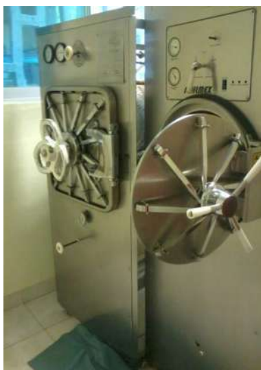
IMAGEN 44.-AUTOCLAVES DE QUIRÓFANOS.
