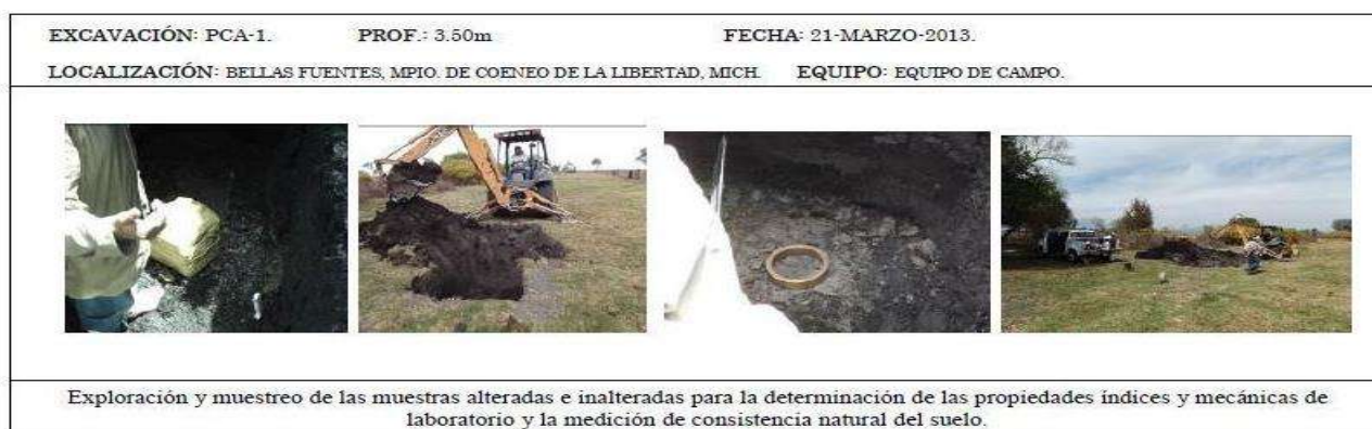
Figura 4.6. Secuencia del proceso de muestreo de suelos (Bio3tech, 2013).
