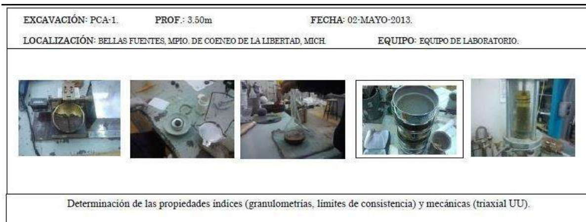
Figura 4.7 Secuencia del proceso de análisis de suelos (Bio3tech, 2013).
