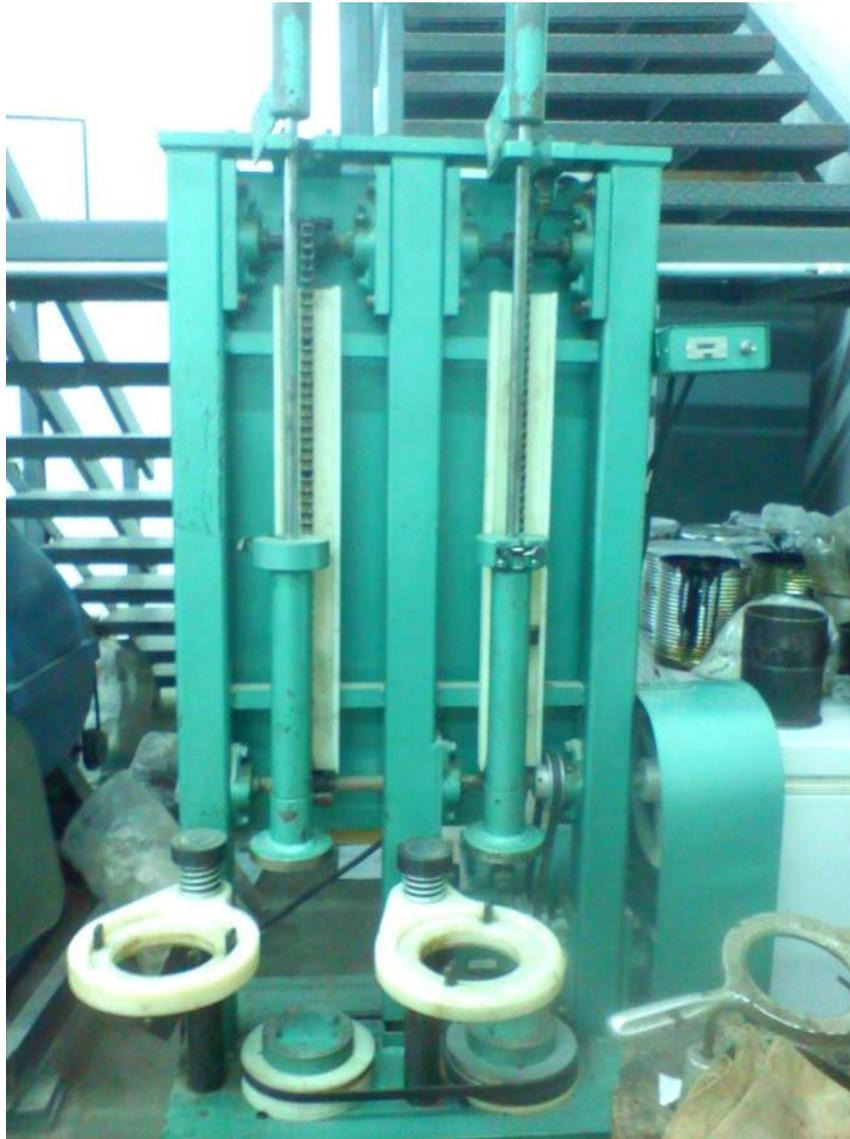
Fig. 3.2.1 Máquina de Compactación de Especímenes
