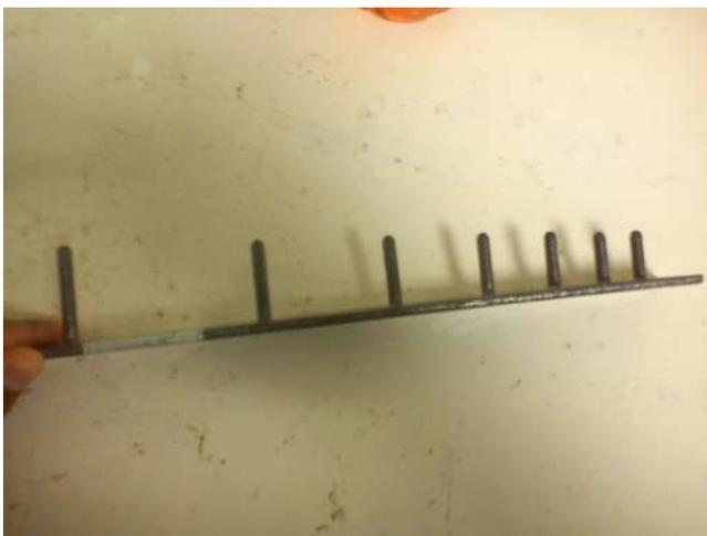
Fig. 1.7.1 Calibrador de longitudes
