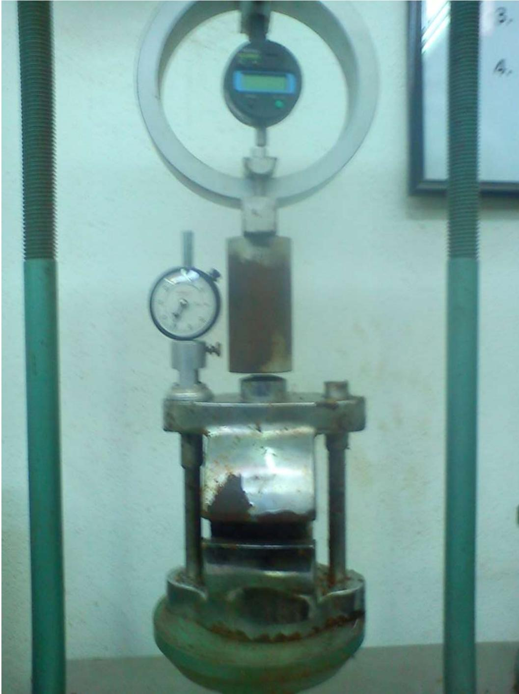
Para cada contenido de cemento se hacen tres pastillas, cada una de ellas requiere de 1100 gr. de material pétreo. El peso y tamaño de las partículas se hace conforme a la distribución de la granulometría como se muestra en la tabla 3.2.1
