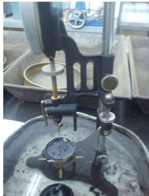
Fig. 2.5.4. Penetrómetro de perfil
