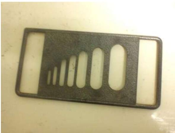
Fig. 1.7.3 Calibrador de Espesores
