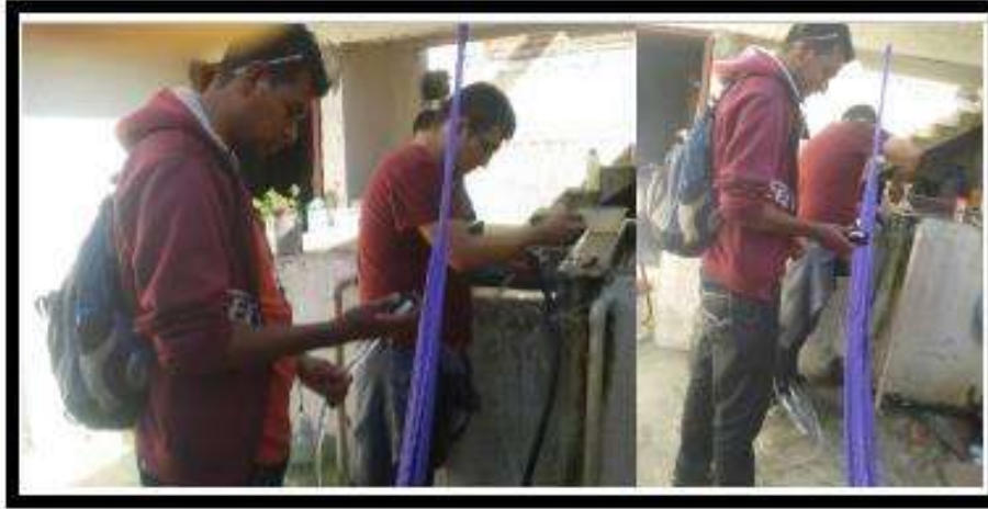
Figura 27 TOMA DE LECTURAS DE PRESIONES EN LAS VIVIENDAS DE HUIRAMBA.
